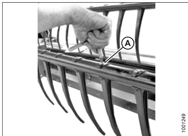
Obrázek 4.297: Demontáž plastového prstu
