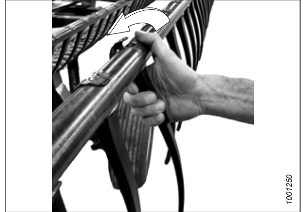
Obrázek 4.298: Demontáž plastového prstu
