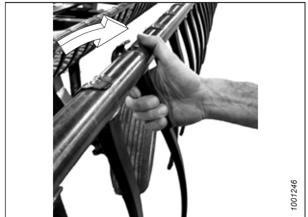
Obrázek 4.299: Montáž plastového prstu
