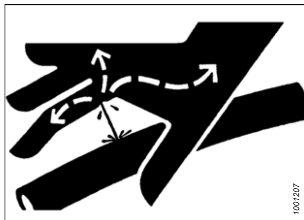
Obrázek 1.12: Nebezpečí tlaku v hydraulice
