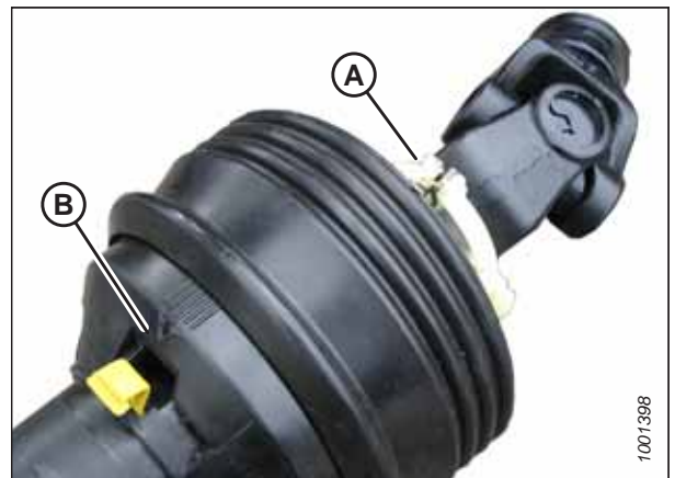
Figura 4.54: Proteção do eixo de transmissão
