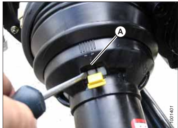
Figura 4.56: Proteção do eixo de transmissão
