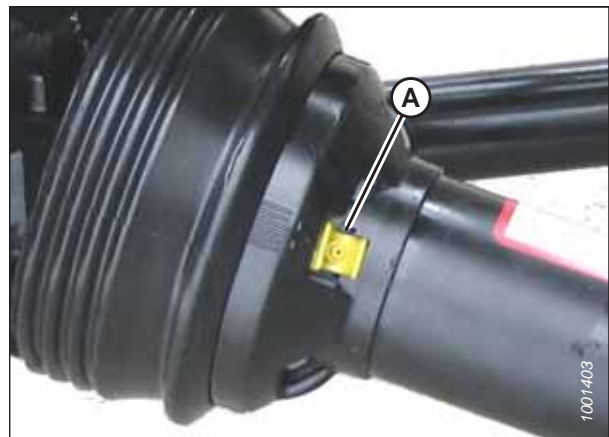
Figura 4.57: Proteção do eixo de transmissão
