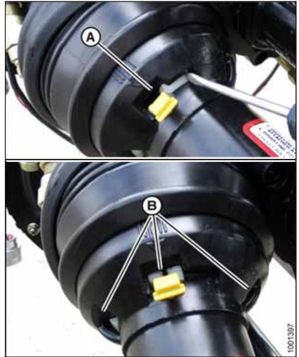
Figura 4.53: Proteção do eixo de transmissão
