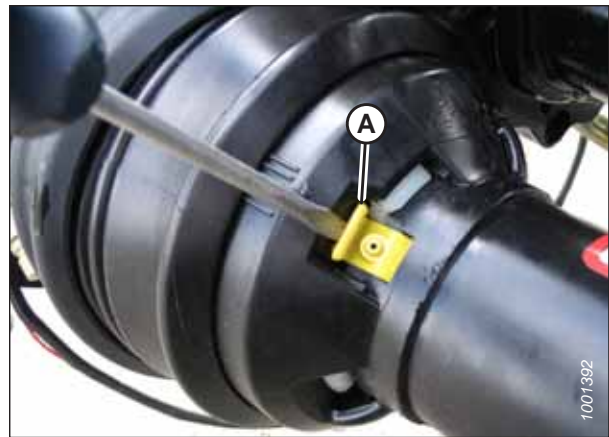
Figura 4.52: Proteção do eixo de transmissão
