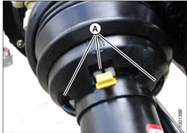
Figura 4.55: Proteção do eixo de transmissão
