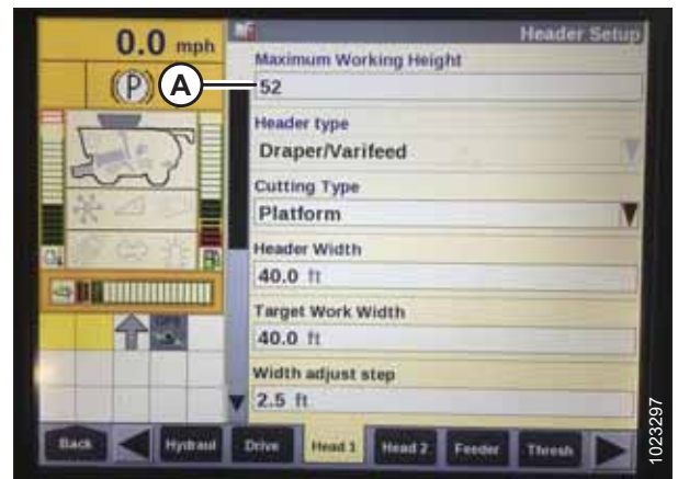
Ábra 3.321: Case betakarítógép kijelző – Vágóasztal-beállítási oldal
