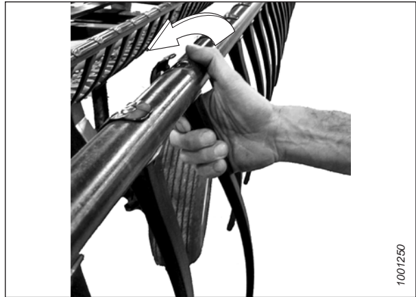
Figura 4.296: Rimozione delle dita di plastica
