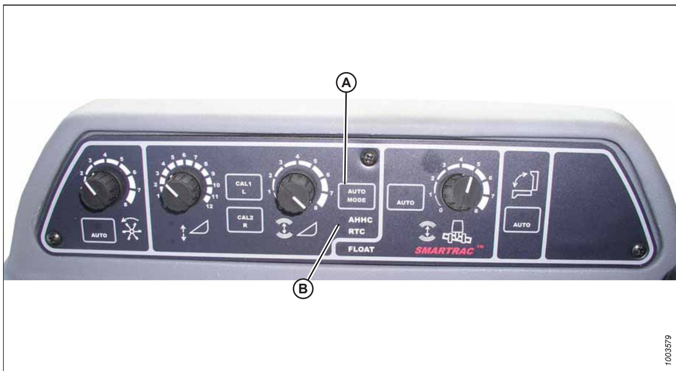
Фигура 3.600: Органи за управление на автоматичната височина на хедера на комбайна
