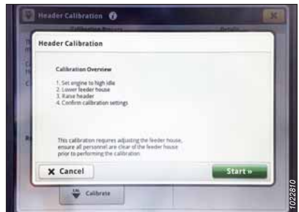
Фигура 3.766: Дисплей на John Deere S7 – Калибриране на хедера
