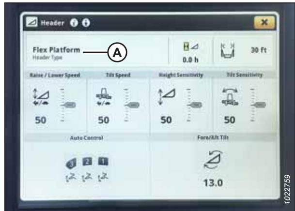
Фигура 3.739: Дисплей на John Deere S7 – Страница Header (Хедер)
