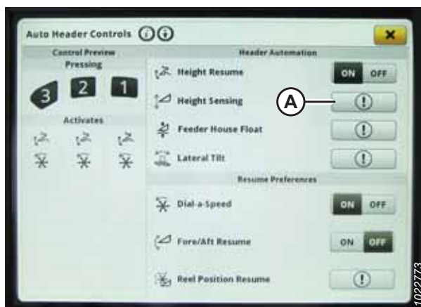
Фигура 3.746: Дисплей на John Deere S7 – Органи за автоматично управление на хедера
