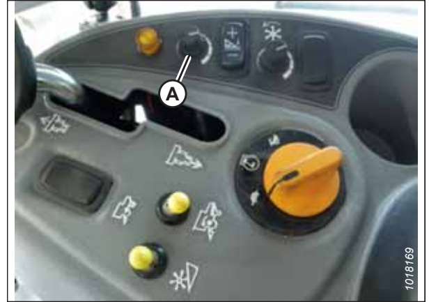
Фигура 3.513: Ръкохватка за регулиране на височината на конзолата за управление на комбайна
