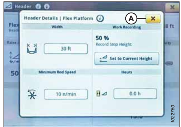
Фигура 3.742: Дисплей на John Deere S7 – Диалогов прозорец Header Details (Данни за хедера)
