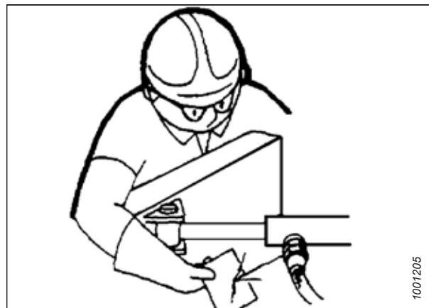
Figura 1.11: Verifica delle perdite idrauliche
