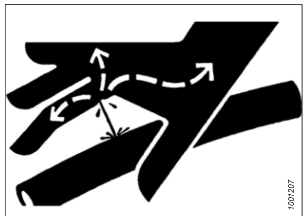
Figura 4.1: Pericolo da pressione idraulica
