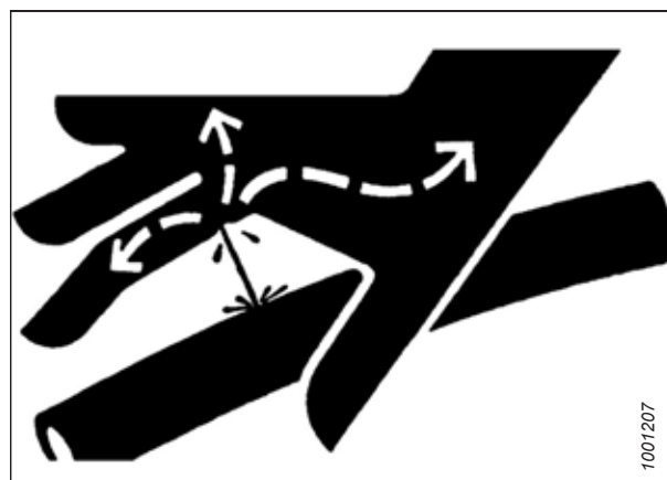
Figura 1.12: Pericolo da pressione idraulica
