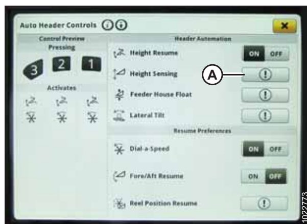
Figure 3.474: John Deere S7 ekraan – heedri automaatsed juhtseadised
