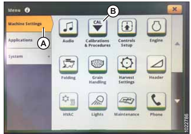
Figure 3.490: John Deere S7 ekraan – masina sätted
