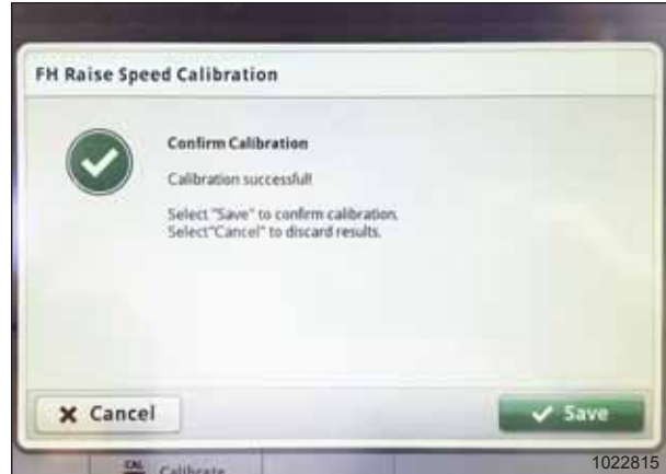
Figure 3.488: John Deere S7 ekraani – kaldtransportööri kalibreerimine
