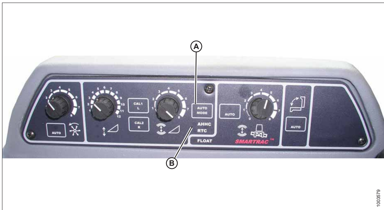
Figure 3.360: Kombainiheedri automaatse kõrguse juhtseadised
