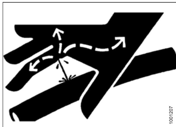
Figure 5.1: Hüdraulikarõhuga seotud oht
