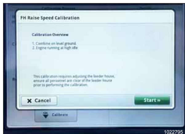
Figure 3.486: John Deere S7 ekraani – kaldtransportööri kalibreerimine
