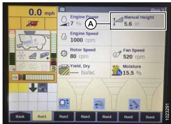
Obrázek 3.241: Displej sklízecí mlátičky Case – stránka Run 1
