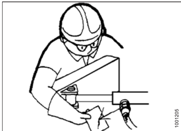
Obrázek 1.11: Kontrola výskytu netěsností v hydraulice
