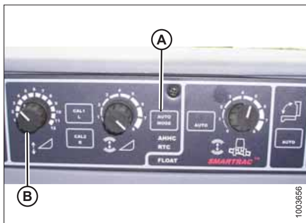
Obrázek 3.366: Ovládací panel AHHC
