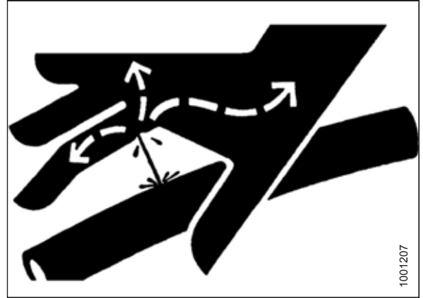
Obrázek 5.1: Nebezpečí tlaku v hydraulice
