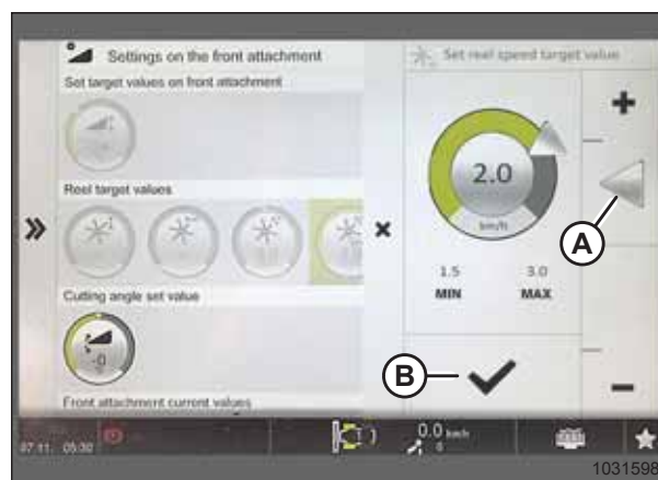
Obrázek 3.352: Stránka cílové hodnoty rychlosti přiřahče
