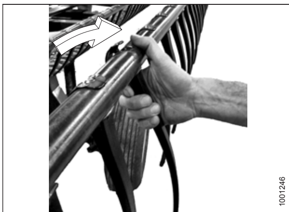
Obrázek 5.315: Montáž plastového prstu
