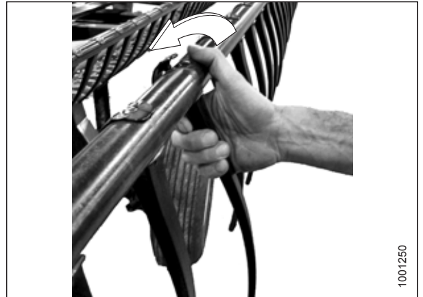
Obrázek 5.314: Demontáž plastového prstu
