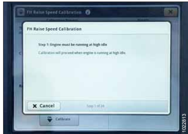
Obrázek 3.487: Displej stroje John Deere řady S7 – kalibrace šikmého dopravníku
