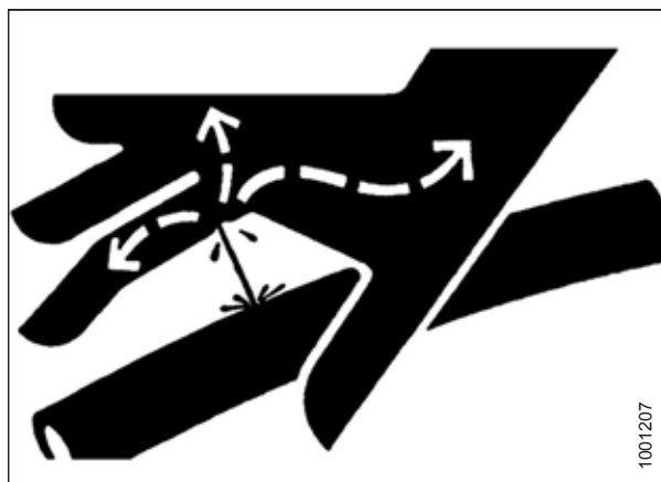
Obrázek 1.12: Nebezpečí tlaku v hydraulice
