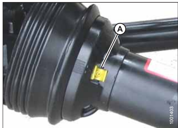
Figura 5.53: Proteção do eixo de transmissão
