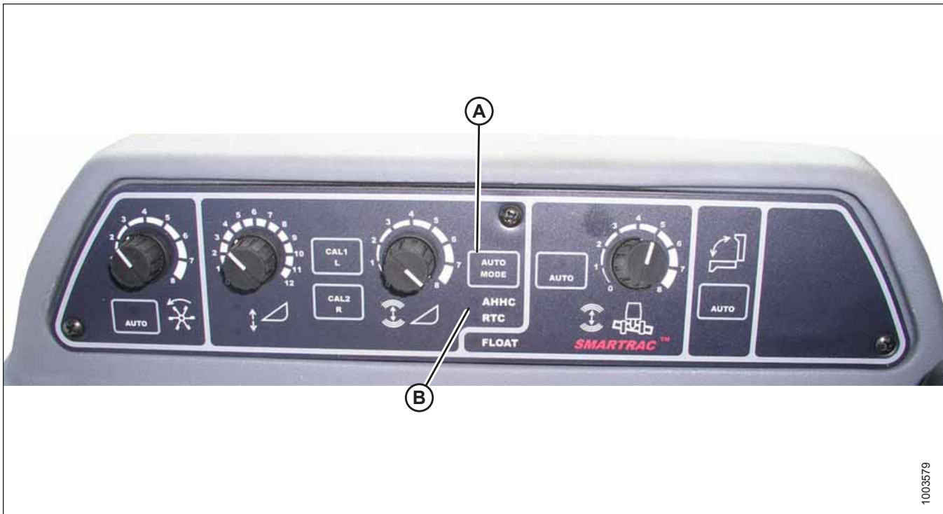
Figura 3.372: Controles de altura automática da plataforma da colheitadeira
