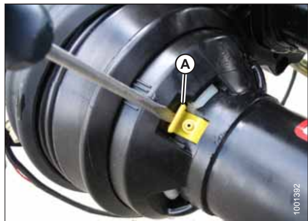
Figura 5.48: Proteção do eixo de transmissão
