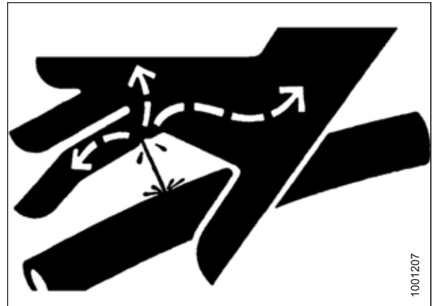
Figura 5.1: Perigo da pressão hidráulica
