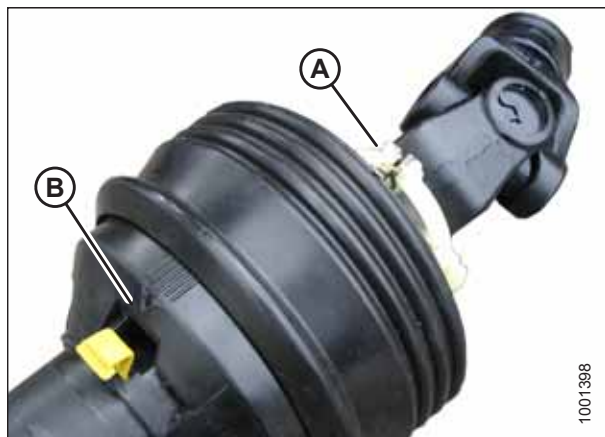
Figura 5.50: Proteção do eixo de transmissão
