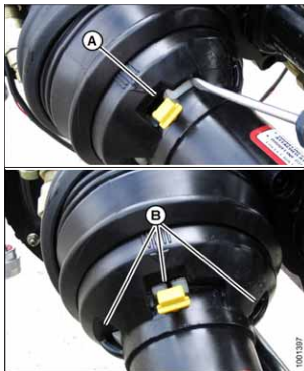
Figura 5.49: Proteção do eixo de transmissão
