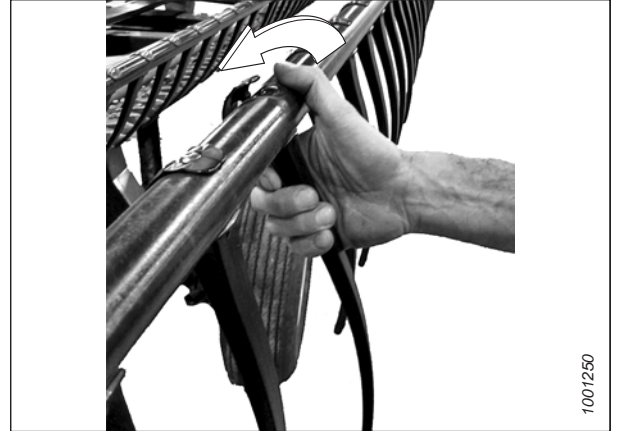
Figure 4.298: Extracción del diente de plástico
