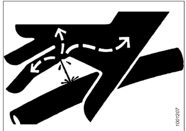
Figure 1.12: Peligro de presión hidráulica
