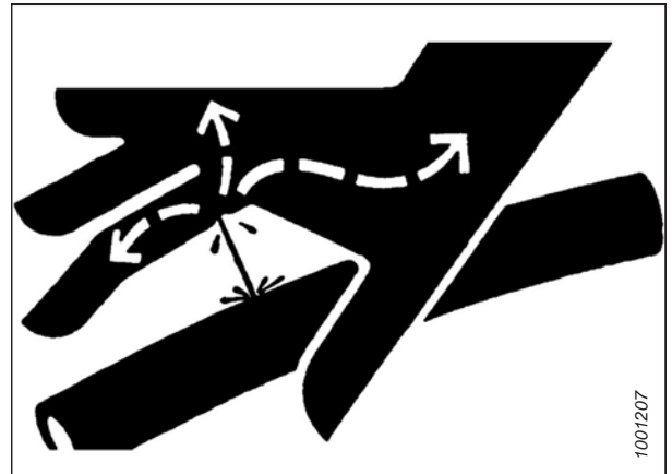
Figure 4.1: Peligro de presión hidráulica
