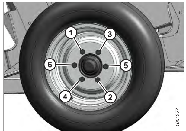
Figure 4.385: Secuencia de ajuste de tornillos
