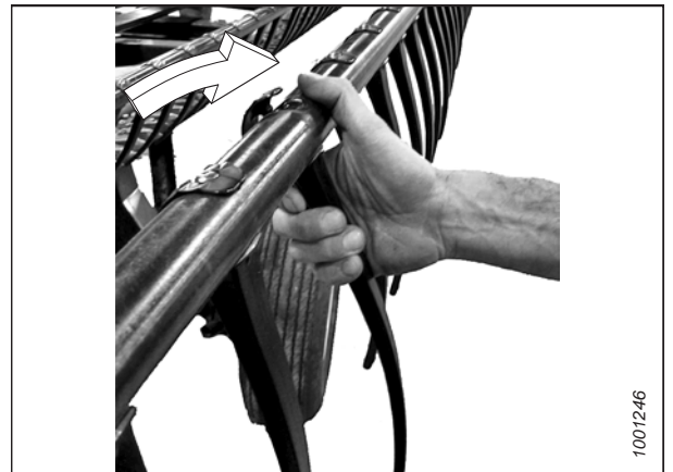
Figure 4.299: Instalación de dientes de plástico
