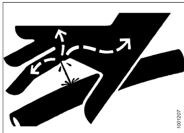
Figura 4.1: Peligro de presión hidráulica
