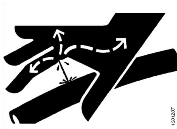
Figura 1.12: Peligro de presión hidráulica
