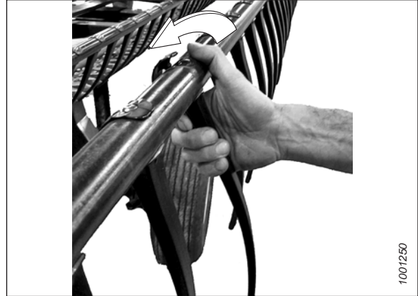
Figura 4.296: Extracción del diente de plástico
