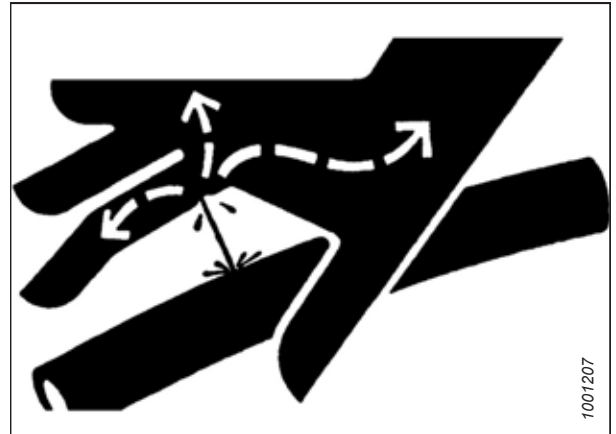
Figure 4.1: Peligro de presión hidráulica
