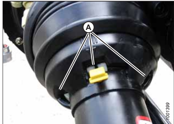
Figure 4.55: Protección del mando
