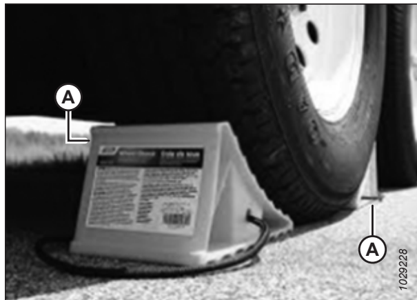
Figure 3.374: Bloqueo de neumáticos
