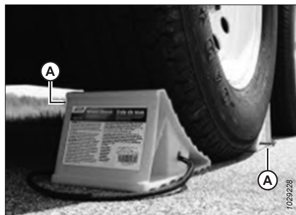
Figure 3.411: Bloqueo de neumáticos
