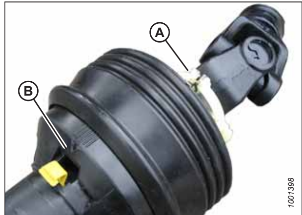
Figure 4.54: Protección del mando
