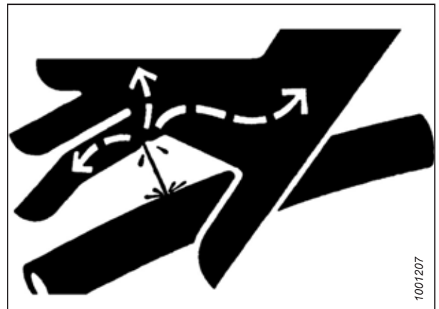
Figure 1.12: Peligro de presión hidráulica
