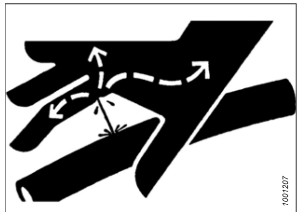
Figura 4.1: Peligro de presión hidráulica
