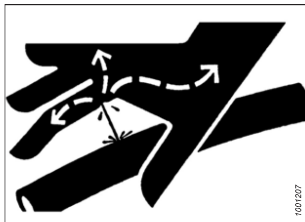
Figura 1.12: Peligro de presión hidráulica
