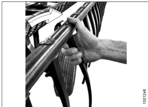
Figura 4.296: Instalación de dientes de plástico
