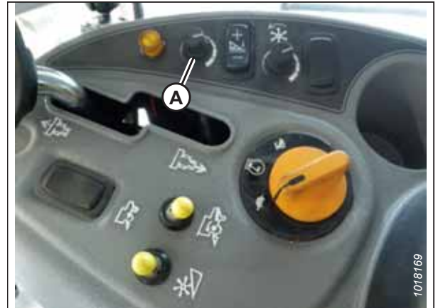
Figura 3.484: Perilla de ajuste de altura en la consola de control de la cosechadora
