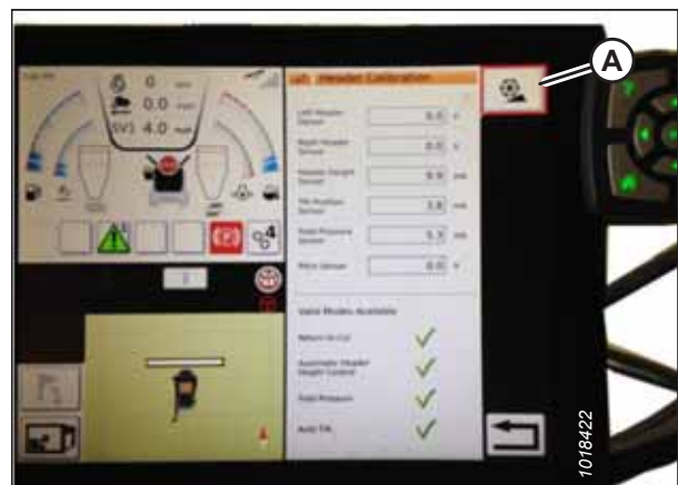
Figura 3.591: Calibración de la plataforma
