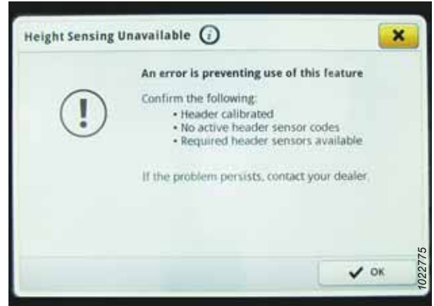
Figura 3.704: Pantalla John Deere S7 - Mensaje de error de detección de altura
