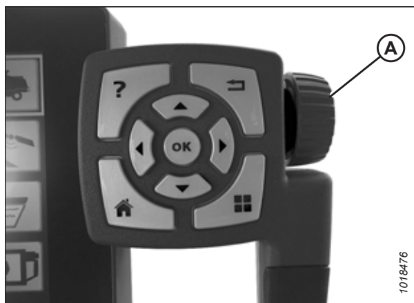
Figura 3.601: La rueda de ajuste (A) en el lado derecho del terminal Tyton.
