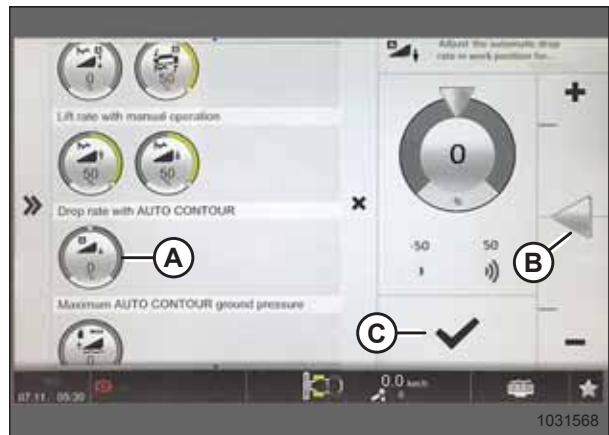
Figura 3.358: Página de tasa de caída con contorno automático
