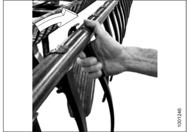
Figura 5.256: Instalación de dientes de plástico
