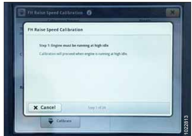
Figura 3.508: Pantalla John Deere S7 - Calibración del embocador
