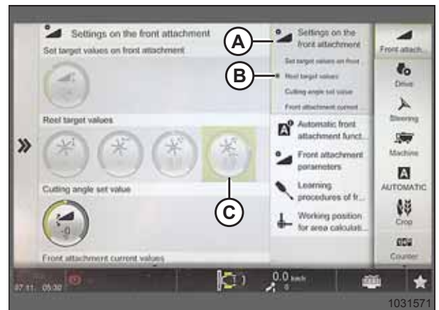
Figura 3.360: Configuraciones en la página de accesorio delantero
