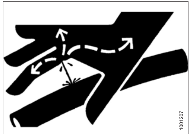
Figura 1.12: Peligro de presión hidráulica
