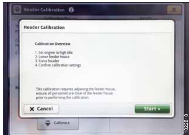
Figura 3.515: Pantalla John Deere S7 - Calibración de la plataforma
