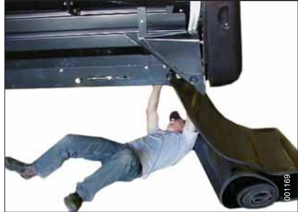
Figura 5.199: Instalación de la lona
