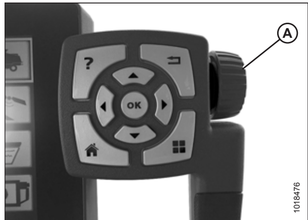
Figura 3.211: La rueda de ajuste en el lado derecho del terminal Tyton
