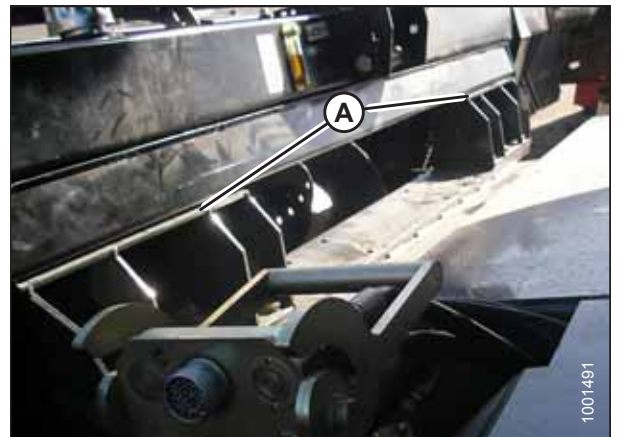
Figura 4.54: Alimentador y módulo de flotación
