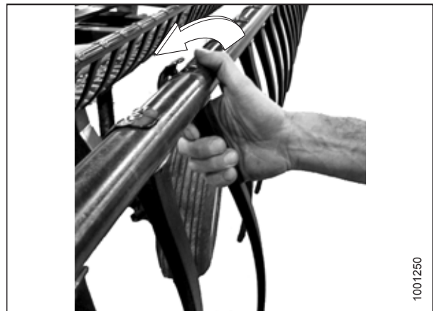
Figura 5.255: Extracción del diente de plástico
