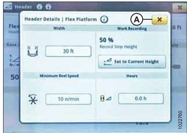
Figura 3.491: Pantalla John Deere S7: cuadro de diálogo de detalles de la plataforma
