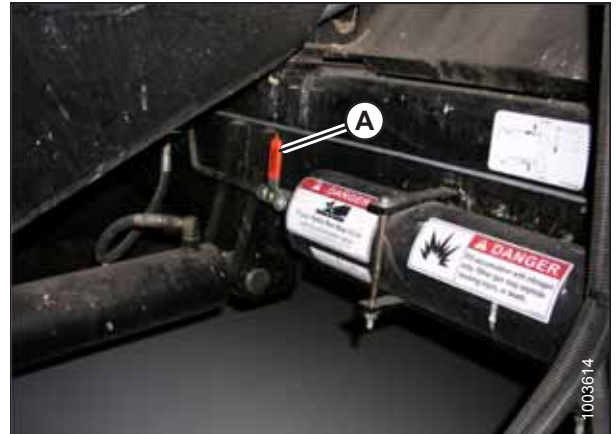
Figura 3.372: Interruptor de ENCENDIDO/APAGADO del acumulador de la cosechadora
