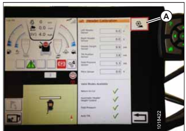
Figura 3.401: Calibración de la plataforma
