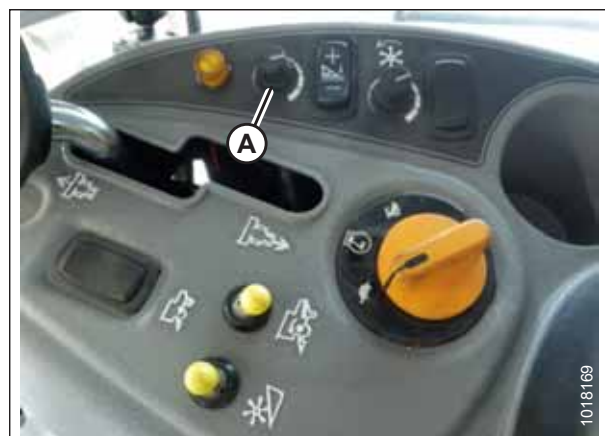
Figura 3.290: Perilla de ajuste de altura en la consola de control de la cosechadora
