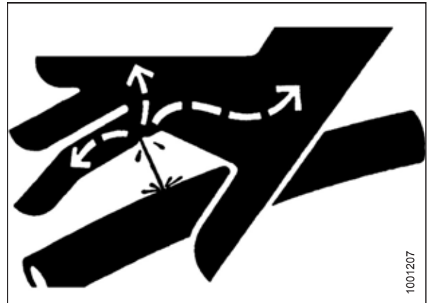
Figura 1.12: Peligro de presión hidráulica
