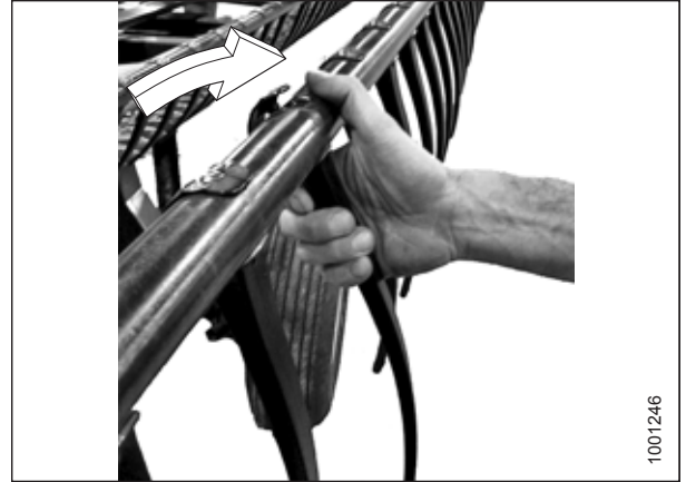
Figura 5.256: Instalación de dientes de plástico
