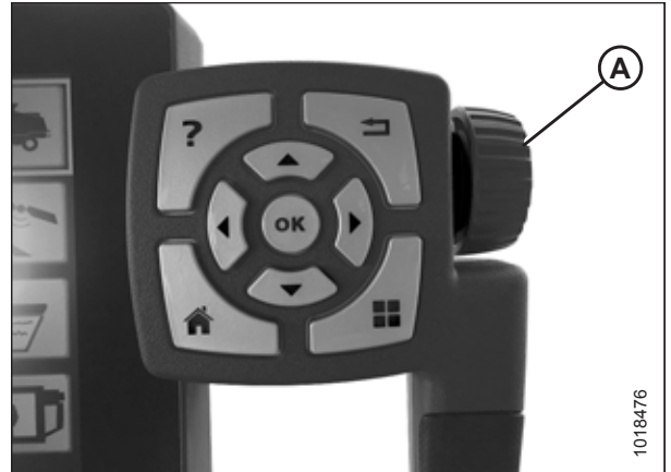
Figura 3.411: La rueda de ajuste (A) en el lado derecho del terminal Tyton.
