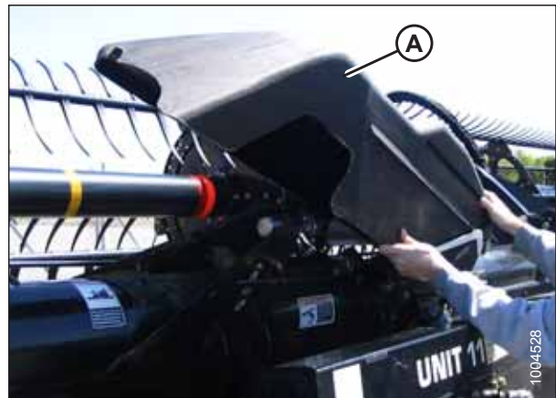
Figura 3.19: Cubierta de conexión
