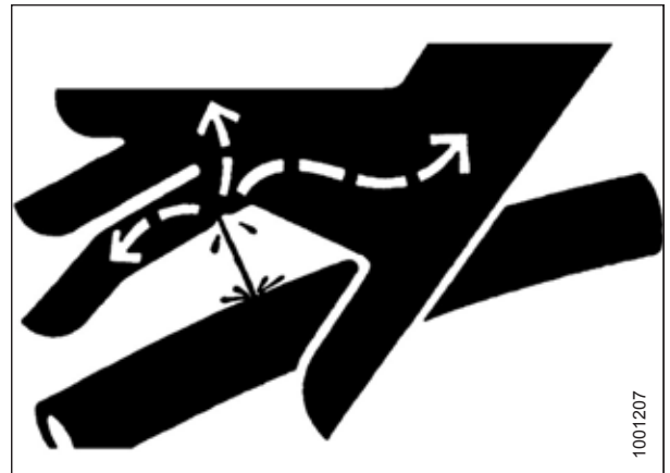
Figura 5.2: Peligro de presión hidráulica
