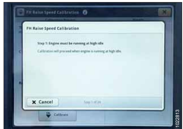
Рисунок 3.385: Дисплей комбайна John Deere S7 — калібрування похилої камери
