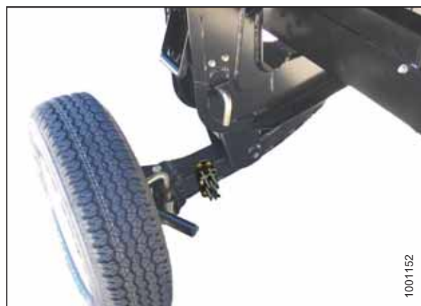
Рисунок 3.503: Ліве колесо в положенні для транспортування
