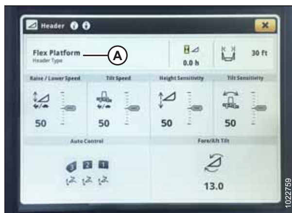
Рисунок 3.365: Дисплей комбайна John Deere S7 — сторінка жатки
