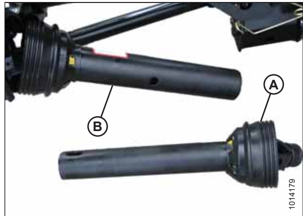
Рисунок 5.37: Розділений приводний вал
