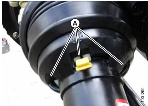
Рисунок 5.41: Захисний кожух приводного вала
