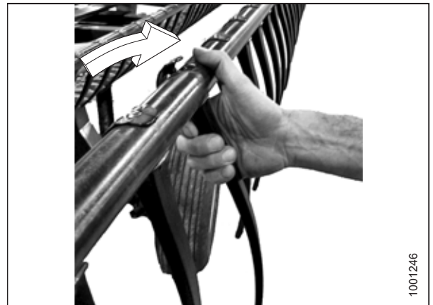
Рисунок 5.220: Установка пластмасового пальця
