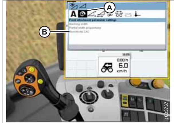
Рисунок 3.422: Дисплей, консоль і ручка керування комбайна CLAAS
