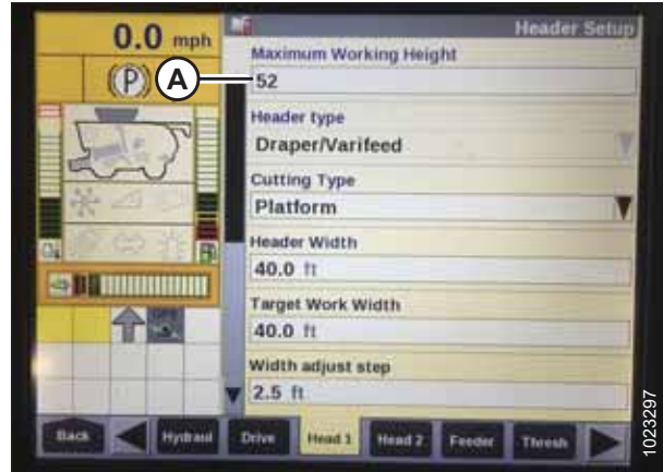
Рисунок 3.195: Дисплей комбайна Case — сторінка Header Setup (Налаштування жатки)
