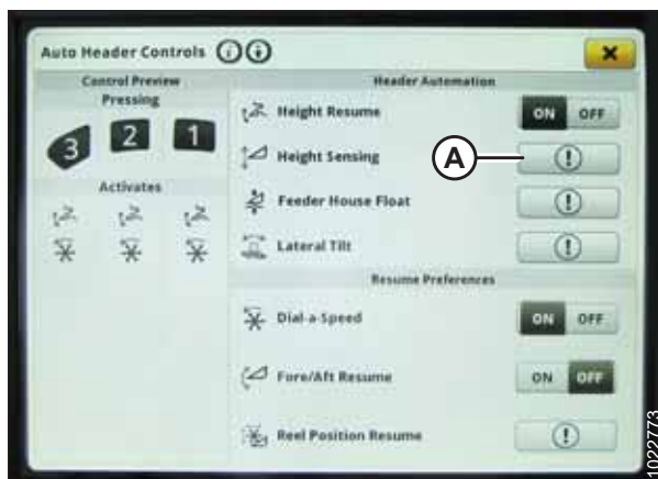
Рисунок 3.372: Дисплей комбайна John Deere S7 — параметри автоматичного контролю жатки
