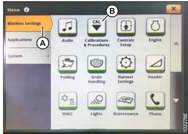
Рисунок 3.381: Дисплей комбайна John Deere S7 — параметри машини
