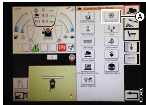
Рисунок 3.270: Налаштування параметрів мотовила в головному меню комбайна
