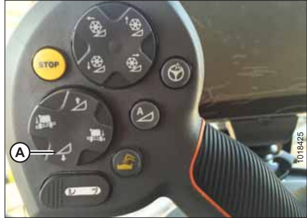
Рисунок 3.281: Клавша опускання жатки
