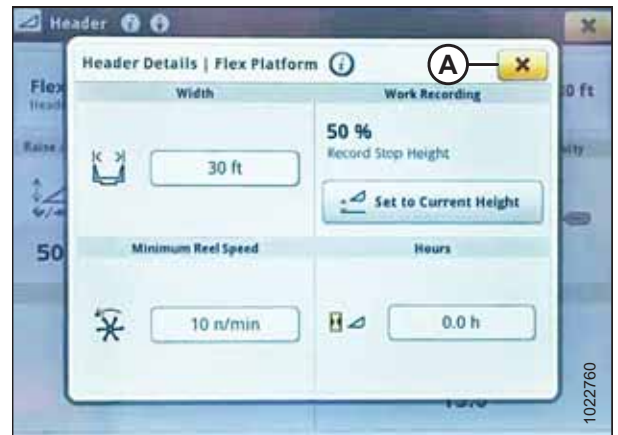
Рисунок 3.368: Дисплей комбайна John Deere S7 — вікно відомостей про жатку
