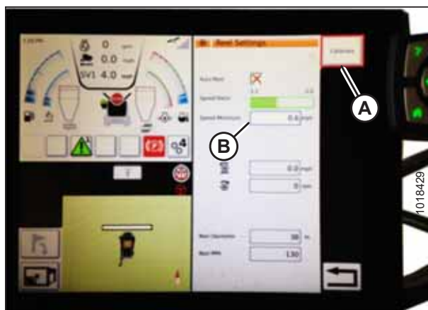
Рисунок 3.271: Калібрування параметрів мотовила
