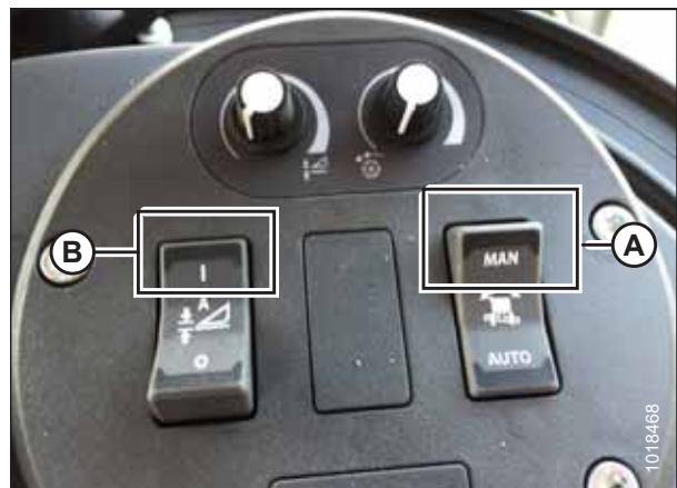
Рисунок 3.288: Блок керування жаткою
