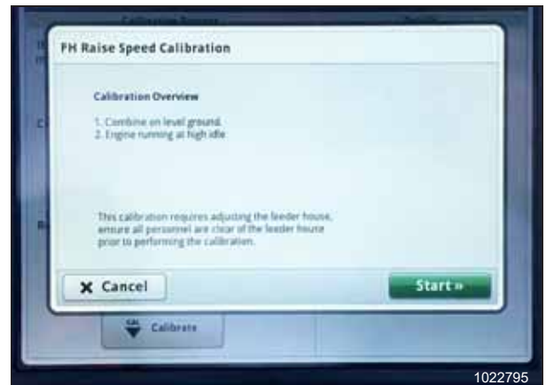
Рисунок 3.384: Дисплей комбайна John Deere S7 — калібрування похилої камери
