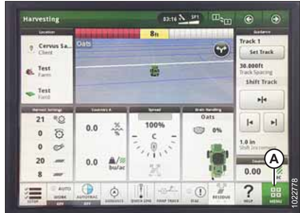
Рисунок 3.380: Дисплей комбайна John Deere S7 — сторінка збирання врожаю
