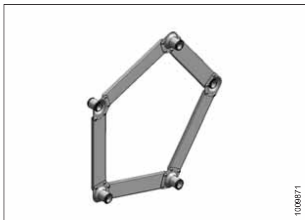
Рисунок 6.6: Зображено комплект підсилення на п'ять планок, комплект підсилення на шість планок аналогічний
