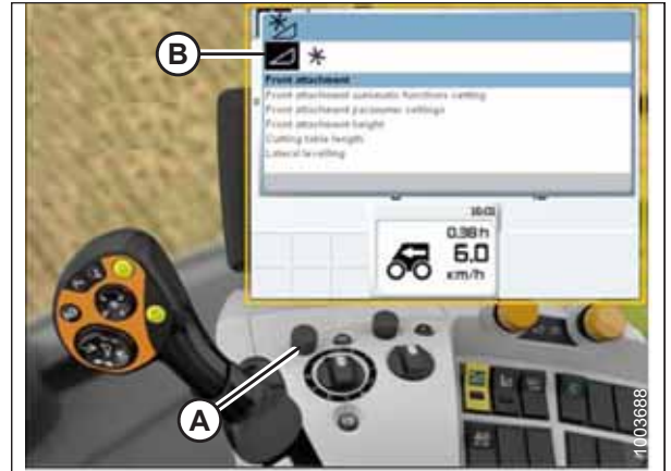
Рисунок 3.415: Дисплей, консоль і ручка керування комбайна CLAAS
