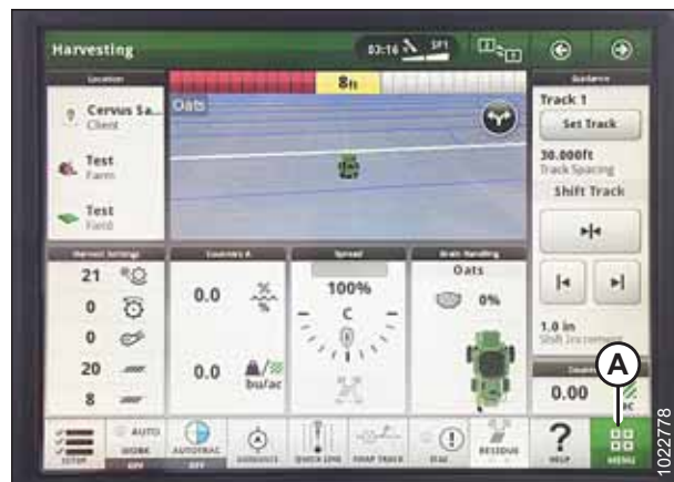
Рисунок 3.387: Дисплей комбайна John Deere S7 — сторінка збирання врожаю
