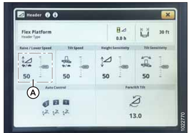
Рисунок 3.369: Дисплей комбайна John Deere S7 — сторінка жатки
