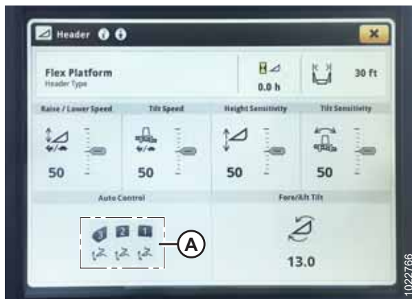
Рисунок 3.371: Дисплей комбайна John Deere S7 — сторінка жатки
