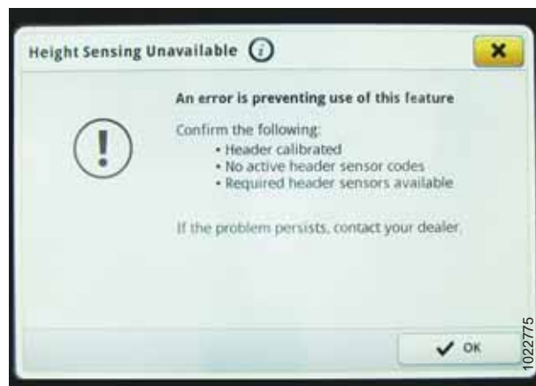
Рисунок 3.373: Дисплей John Deere S7 — повідомлення про помилку функції визначення висоти
