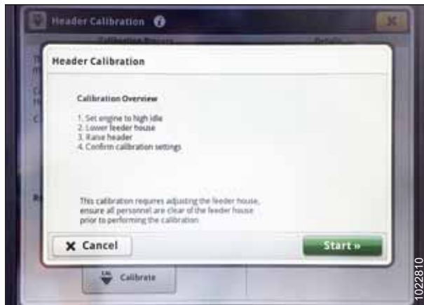
Рисунок 3.392: Дисплей комбайна John Deere S7 — калібрування жатки
