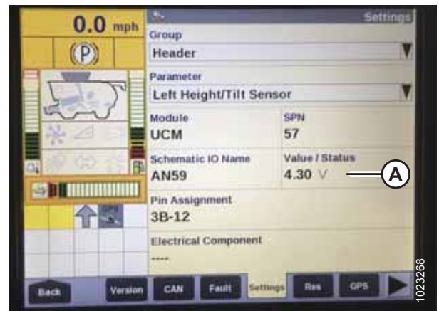
Рисунок 3.189: Дисплей комбайна Case IH
