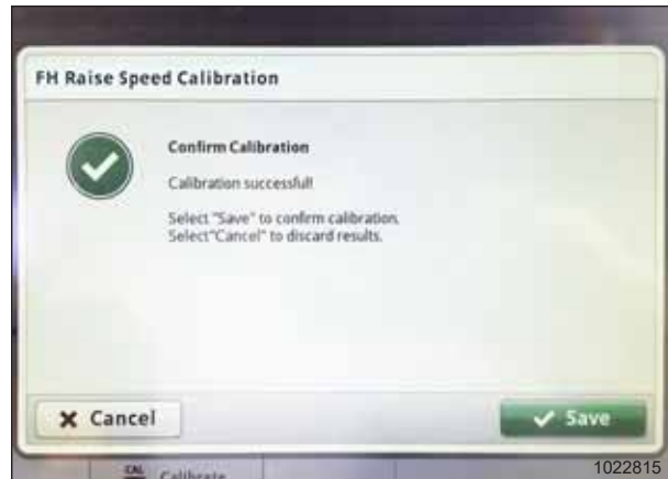
Рисунок 3.386: Дисплей комбайна John Deere S7 — калібрування похилої камери
