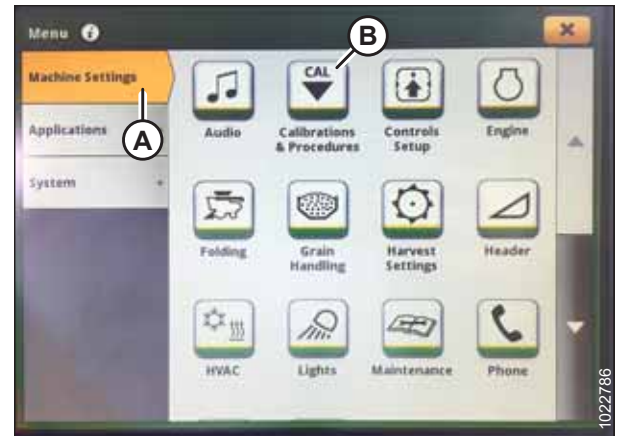
Рисунок 3.388: Дисплей комбайна John Deere S7 — параметри машини
