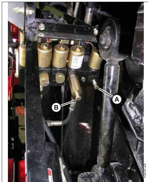
Рисунок 3.254: Регульовані обмежувачі підйому й опускання жатки
