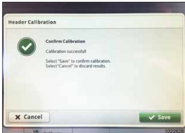
Рисунок 3.393: Дисплей комбайна John Deere S7 — калібрування жатки
