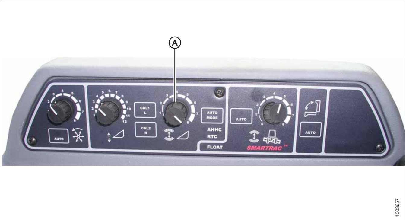
Рисунок 3.257: Консоль автоматичного контролю висоти жатки
