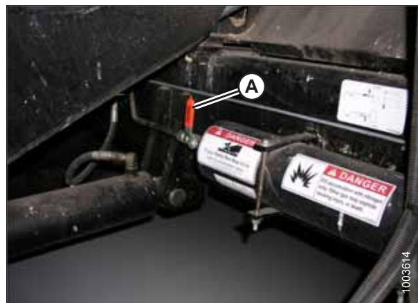
Рисунок 3.253: Вимикач гідроаккумулятора комбайна
