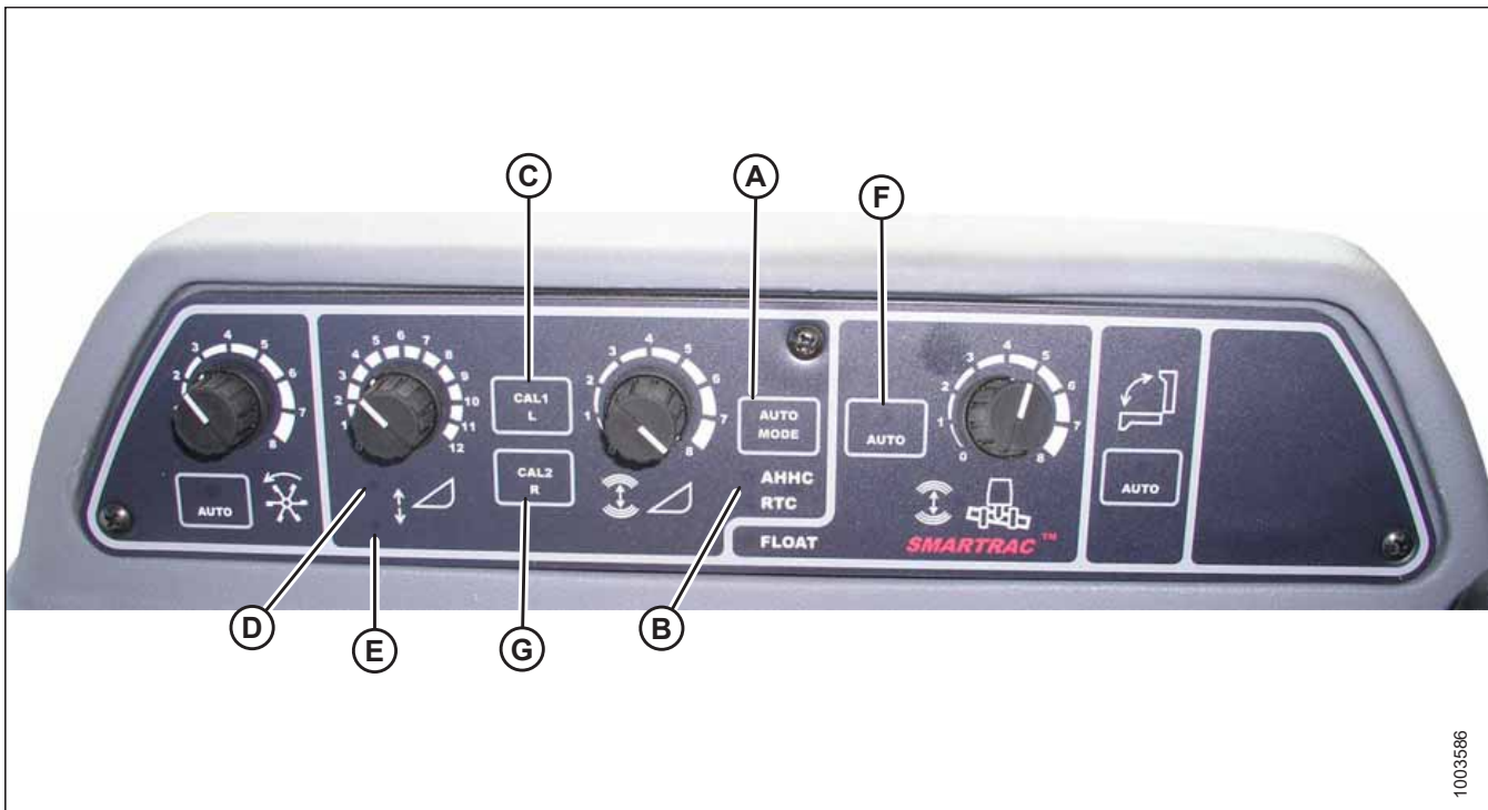
Рисунок 3.252: Органи керування автоматичного контролю висоти жатки комбайна
