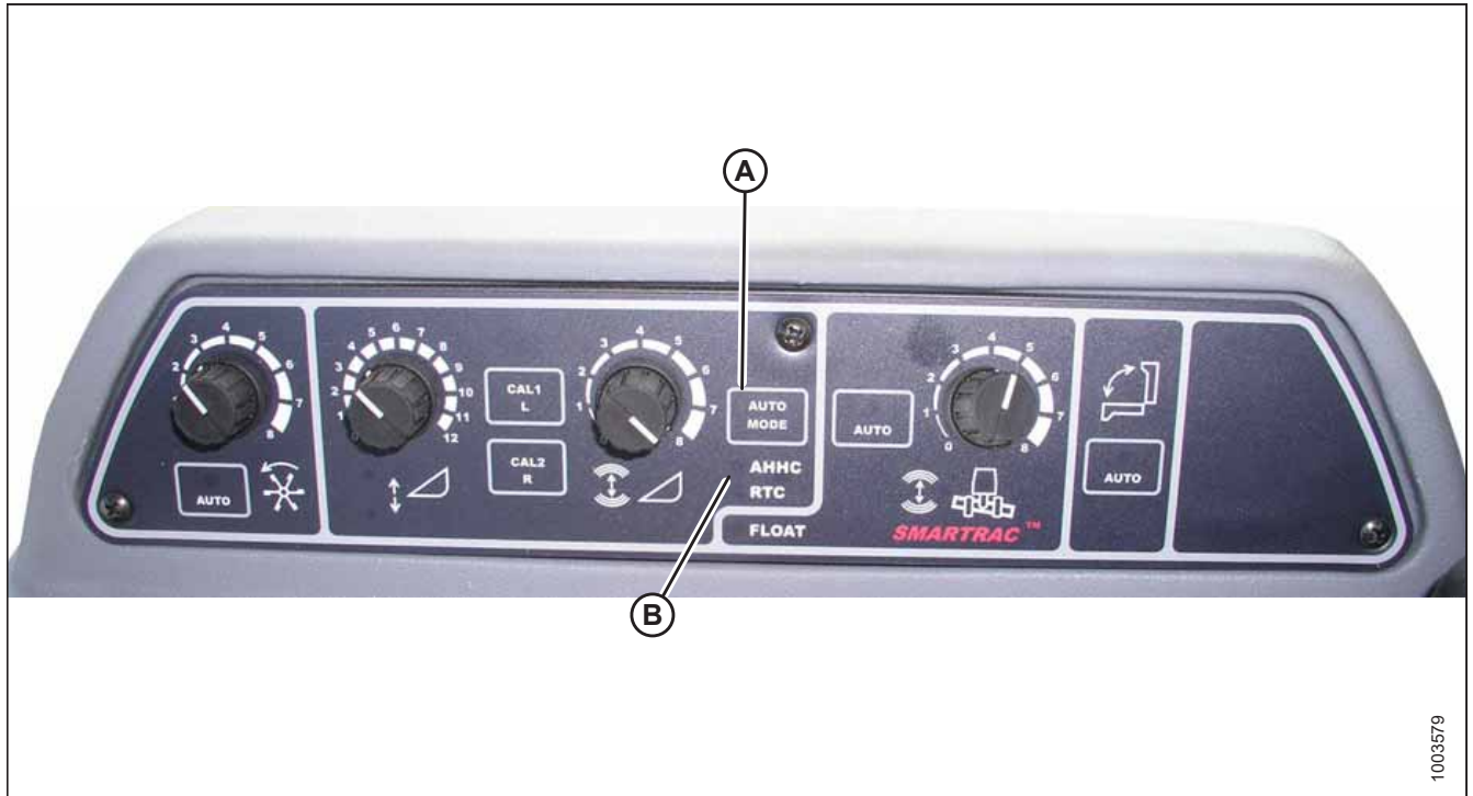
Рисунок 3.250: Органи керування автоматичного контролю висоти жатки комбайна
