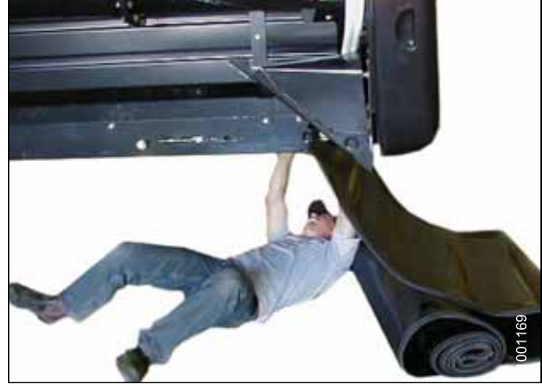
Figura 5.169: Instalación de la lona
