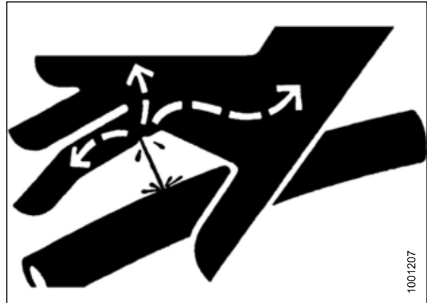
Figura 1.12: Peligro de presión hidráulica
