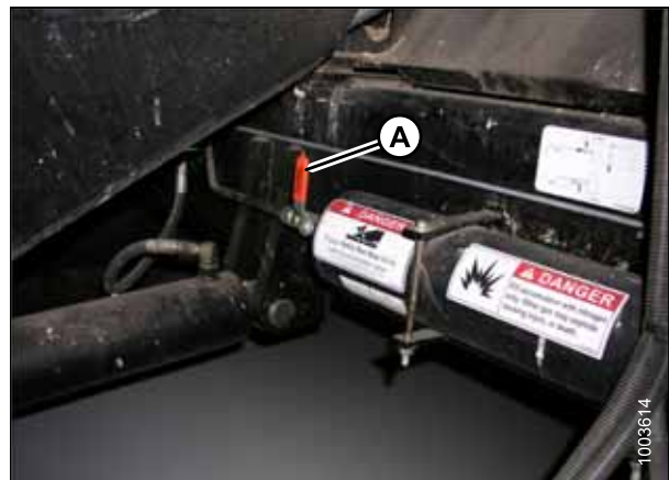
Figura 3.252: Interruptor de ENCENDIDO/APAGADO del acumulador de la cosechadora A: Palanca del acumulador (Posición apagado)
