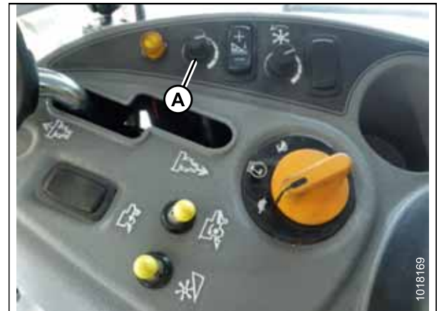
Figura 3.240: Perilla de ajuste de altura en la consola de control de la cosechadora
