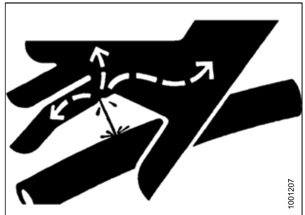
Figura 5.2: Peligro de presión hidráulica
