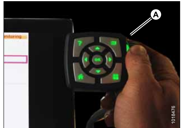
Figura 3.291: La rueda de ajuste (A) en el lado derecho del terminal Tyton.
