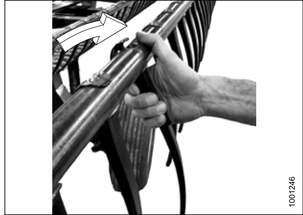
Figura 5.220: Instalación de dientes de plástico
