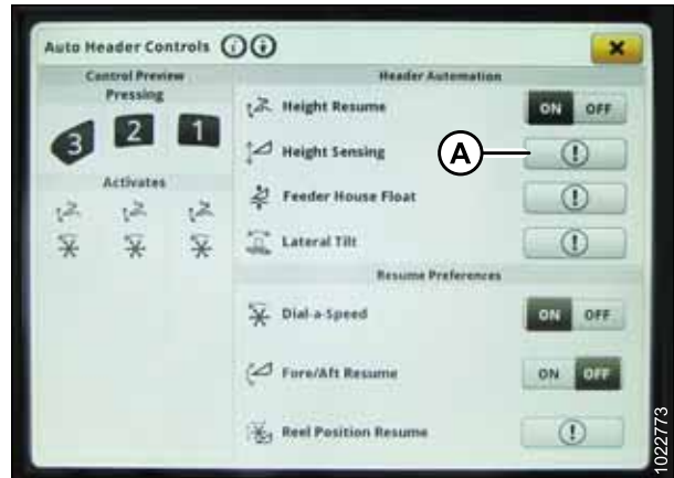
Figura 3.371: Pantalla John Deere S7 - Controles automáticos de la plataforma
