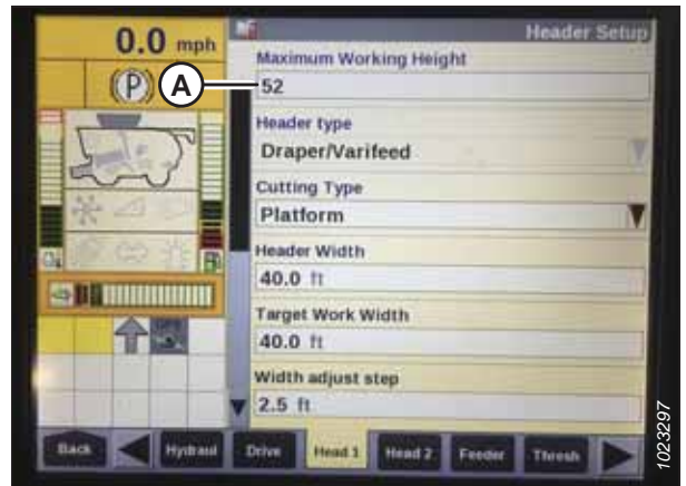
Рисунок 3.207: Дисплей комбайна Case: экран настройки жатки
