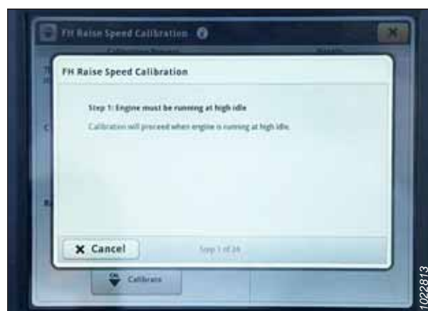
Рисунок 3.513: Дисплей John Deere S7 — калибровка наклонной камеры
