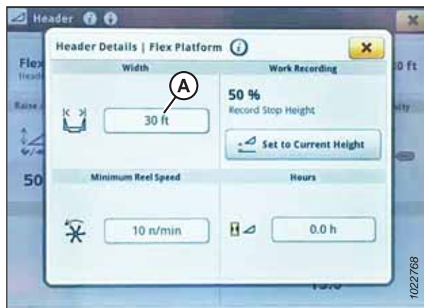
Рисунок 3.494: Дисплей комбайна John Deere серии S7: окно подробной информации о жатке
