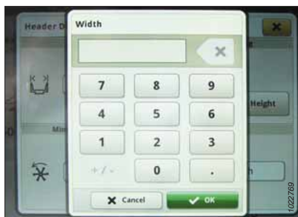
Рисунок 3.495: Дисплей John Deere S7 — настройка ширины жатки
