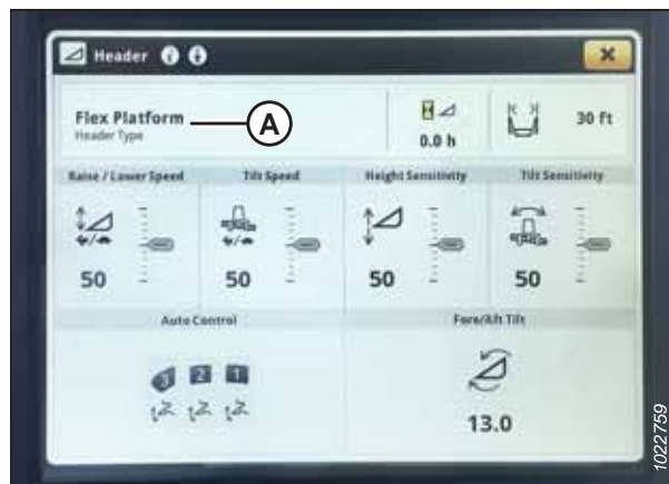
Рисунок 3.493: Дисплей комбайна John Deere серии S7 — страница жатки
