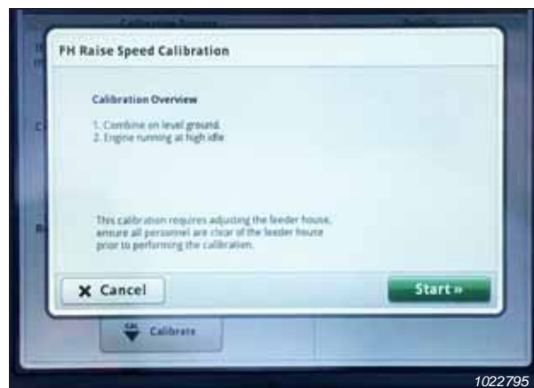
Рисунок 3.512: Дисплей John Deere S7 — калибровка наклонной камеры
