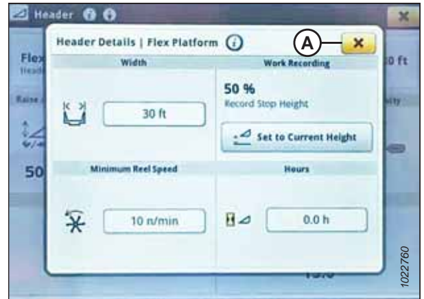
Рисунок 3.496: Дисплей комбайна John Deere серии S7: диалоговое окно подробной информации о жатке
