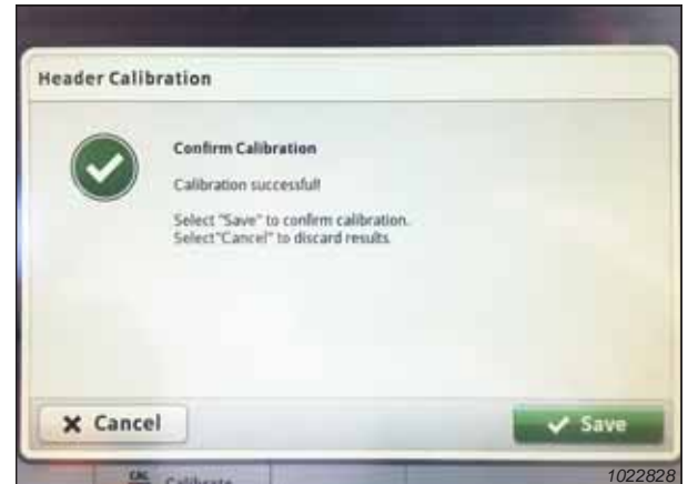
Рисунок 3.521: Дисплей John Deere S7 — калибровка жатки
