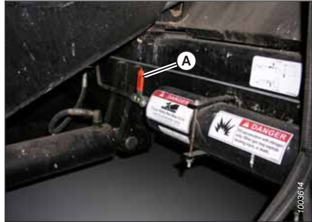
Рисунок 3.347: Выключатель гидроаккумулятора комбайна
