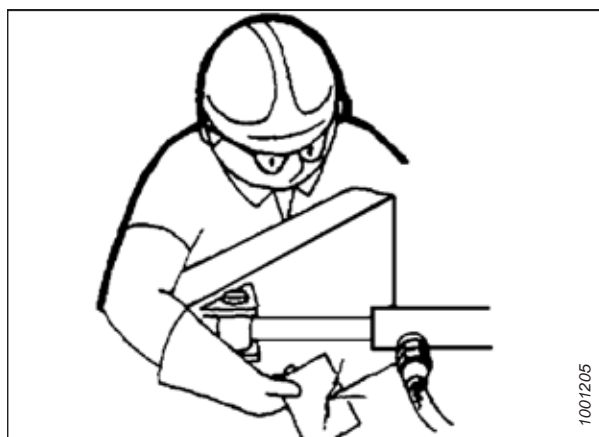
Рисунок 5.2: Проверка наличия гидравлических течей
