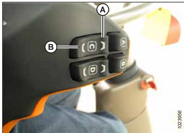
Рисунок 3.89: Управление продольным наклоном наклонной камеры John Deere 700
