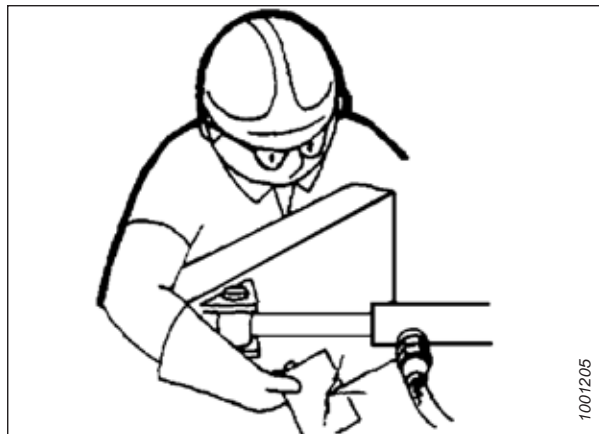
Рисунок 1.11: Проверка наличия гидравлических течей
