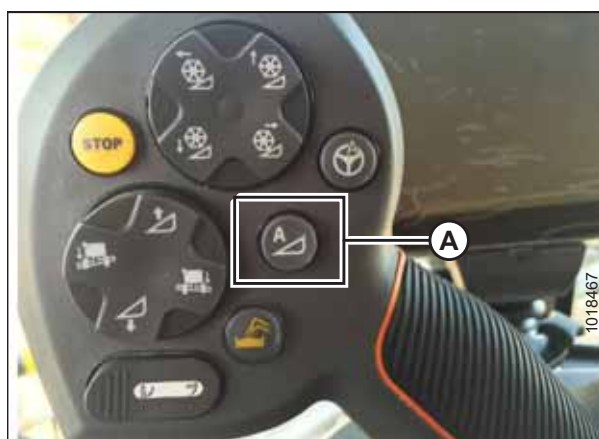
Рисунок 3.213: Автоматический контроль высоты жатки (АННС) на ручке управления
