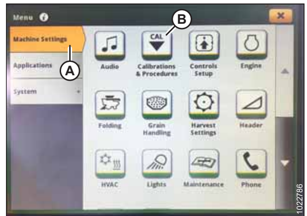
Рисунок 3.490: Дисплей John Deere S7 — настройки машины
