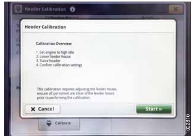
Рисунок 3.494: Дисплей John Deere S7 — калибровка жатки
