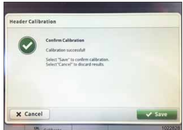
Рисунок 3.495: Дисплей John Deere S7 — калибровка жатки
