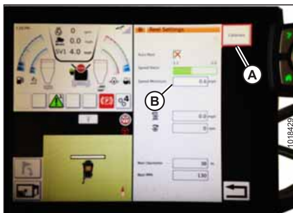
Рисунок 3.368: Калибровка параметров подбирающего мотвила
