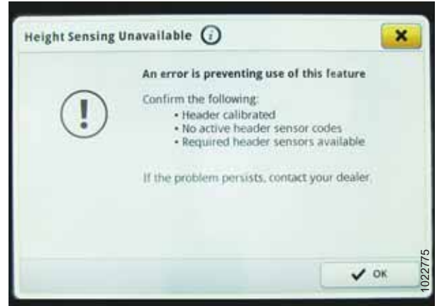
Рисунок 3.475: Дисплей John Deere S7 — сообщение об ошибке чувствительности по высоте
