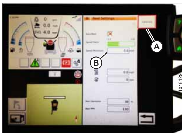
Рисунок 3.199: Калибровка параметров подбирающего мотовила
