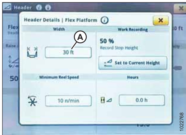
Рисунок 3.468: Дисплей комбайна John Deere серии S7: окно подробной информации о жатке
