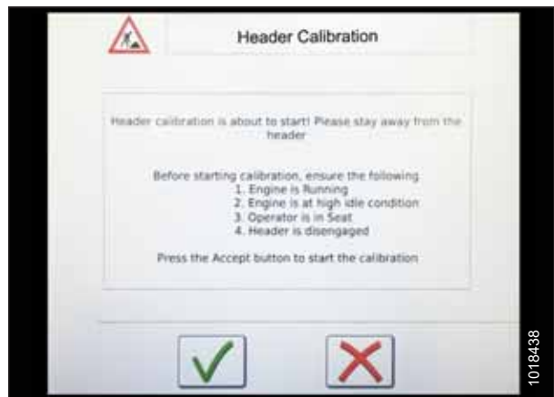
Рисунок 3.207: Предупреждение о калибровке жатки
