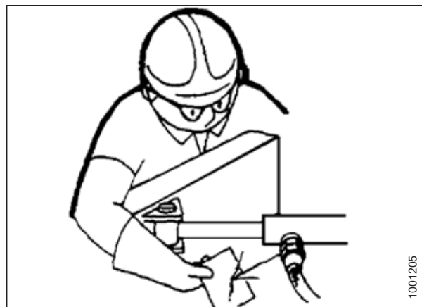
Рисунок 5.3: Проверка наличия гидравлических течей
