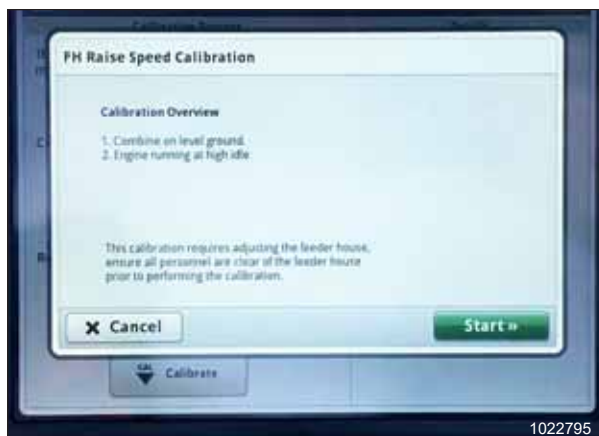
Рисунок 3.486: Дисплей John Deere S7 — калибровка наклонной камеры
