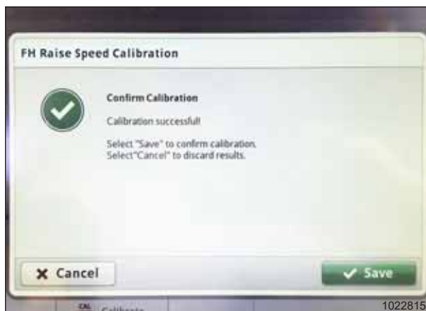
Рисунок 3.488: Дисплей John Deere S7 — калибровка наклонной камеры
