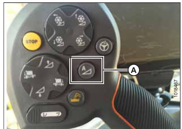
Рисунок 3.387: Автоматический контроль высоты жатки (АННС) на ручке управления
