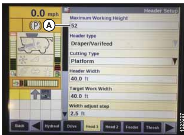
Рисунок 3.242: Дисплей комбайна Case: экран настройки жатки
