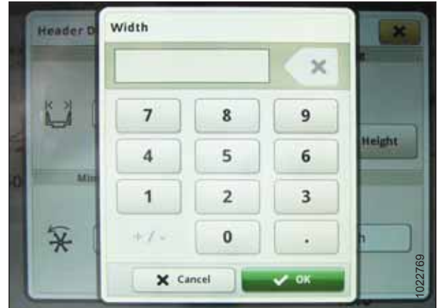
Рисунок 3.469: Дисплей John Deere S7 — настройка ширины жатки
