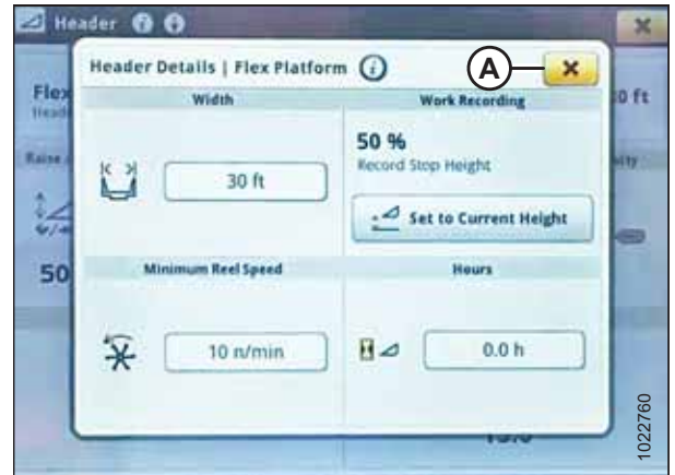
Рисунок 3.470: Дисплей комбайна John Deere серии S7: окно подробной информации о жатке
