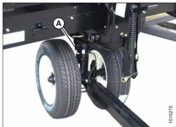
Рисунок 3.582: Соединение жгута проводов
