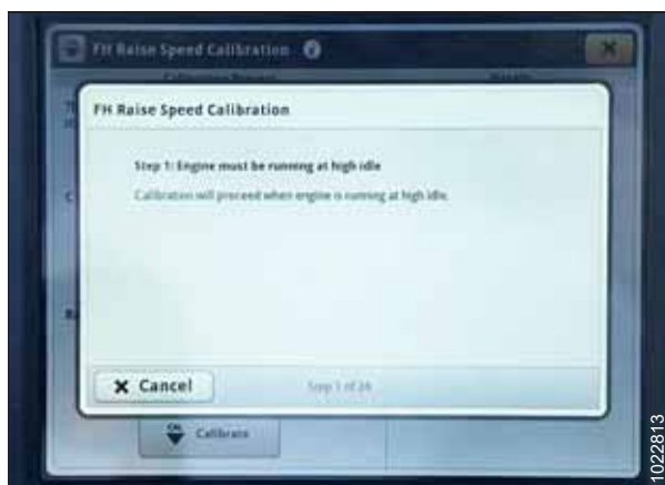
Рисунок 3.487: Дисплей John Deere S7 — калибровка наклонной камеры
