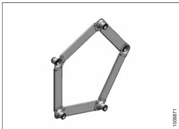
Rysunek 6.6: Pokazano zestaw wzmacniający w wersji pięciolistwowej — zestaw wzmacniający w wersji sześciolistwowej jest podobny
