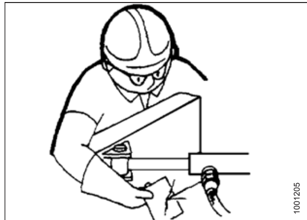
Rysunek 1.11: Próba szczelności elementów hydraulicznych
