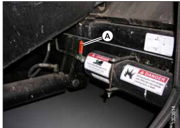
Rysunek 3.272: Przełącznik akumulatora kombajnu A — dźwignia akumulatora (w pozycji wyłączonej)
