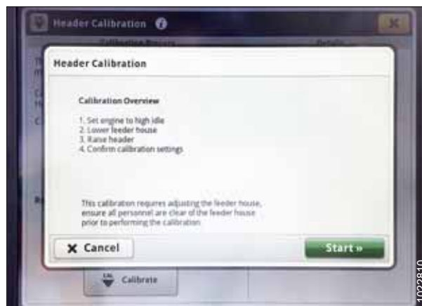
Rysunek 3.414: Wyświetlacz kombajnu John Deere S7 — kalibracja hedera
