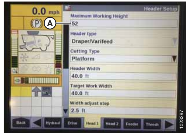
Rysunek 3.207: Wyświetlacz kombajnu Case — strona Heder Setup (Konfiguracja hедера)
