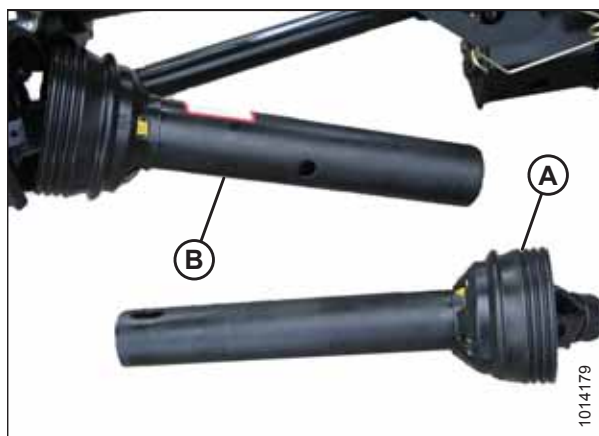
Rysunek 5.38: Rozłączony układ przeniesienia napędu
