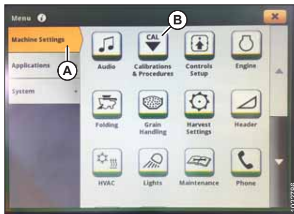
Rysunek 3.410: Wyświetlacz kombajnu John Deere S7 — ustawienia maszyny
