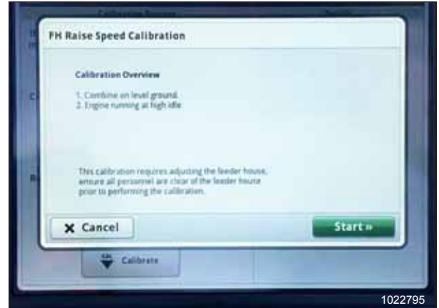
Rysunek 3.406: Wyświetlacz kombajnu John Deere S7 — kalibracja przenośnika pochyłego
