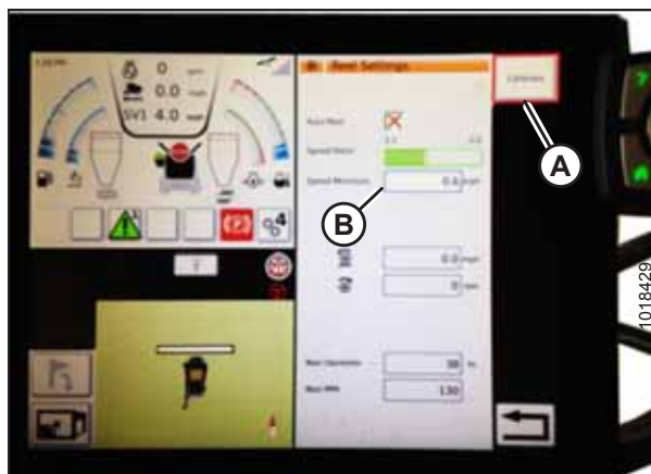
Rysunek 3.290: Kalibracja ustawień nagarniacza
