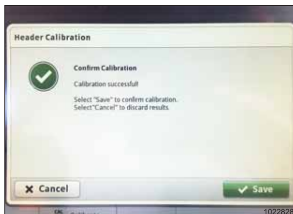
Rysunek 3.415: Wyświetlacz kombajnu John Deere S7 — kalibracja hedera
