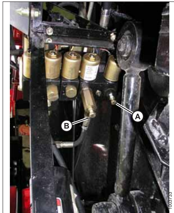
Rysunek 3.273: Regulowane ograniczniki podnoszenia i opuszczania hedera
