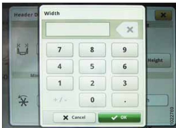
Rysunek 3.389: Wyświetlacz kombajnu John Deere S7 — ustawianie szerokości hedera
