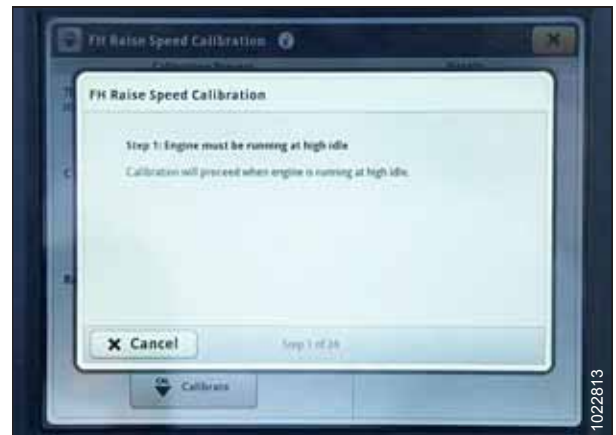
Rysunek 3.407: Wyświetlacz kombajnu John Deere S7 — kalibracja przenośnika pochyłego
