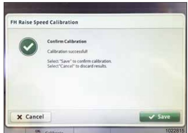
Rysunek 3.408: Wyświetlacz kombajnu John Deere S7 — kalibracja przenośnika pochyłego
