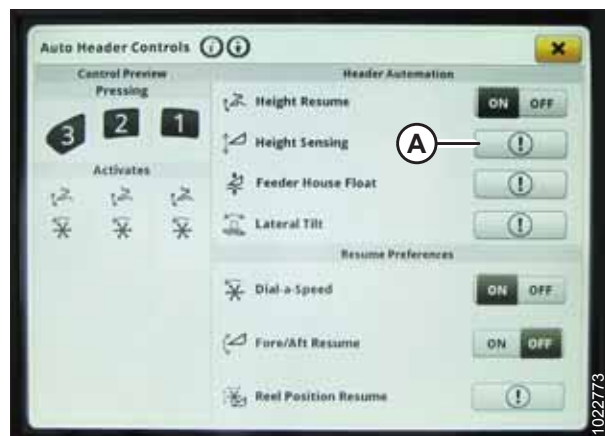
Rysunek 3.394: Wyświetlacz kombajnu John Deere S7 — elementy automatycznego sterowania hederem
