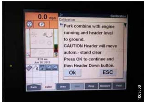
Abbildung 3.468: Bildschirmanzeige eines New Holland-Mähdreschers
