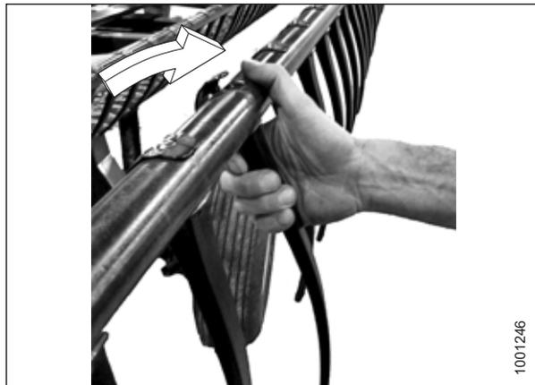
Abbildung 5.234: Einbauen eines Kunststoffhaspelfingers
