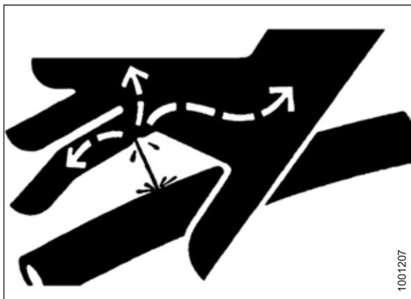
Abbildung 5.2: Gefährdung durch Hydraulikdruck
