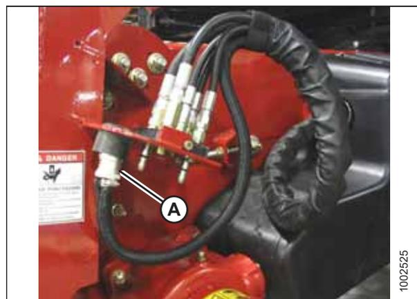
Abbildung 4.55: Multikuppler am Mährescher
