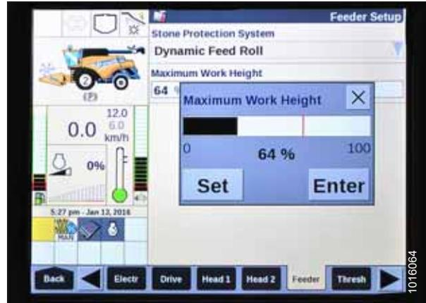
Abbildung 3.506: Bildschirmanzeige eines New Holland-Mähdreschers
