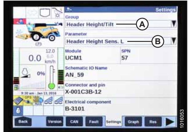
Abbildung 3.480: Bildschirmanzeige eines New Holland-Mähdreschers
