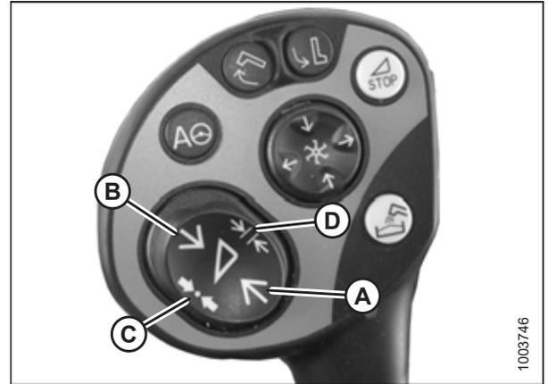
Abbildung 3.424: Tasten auf Multifunktionshebel
