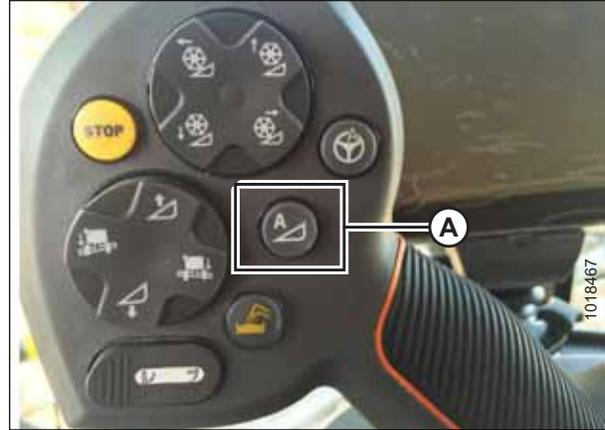
Abbildung 3.308: AHC am Multifunktionshebel
