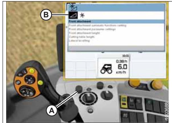
Abbildung 3.437: Display, Bedienkonsole und Multifunktionshebel des CLAAS Mähdreschers
