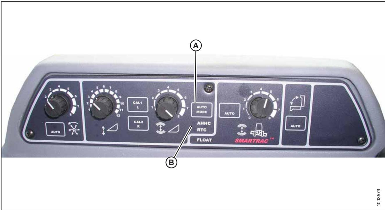
1. Die Taste AUTO MODE (A) (Automatik) drücken, bis die AHHC-LED (B) zu blinken beginnt. Falls die RTC-LED blinkt, nochmals die Taste AUTO MODE (A) (Automatik) drücken, bis AHHC blinkt.
