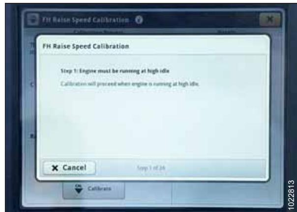
Abbildung 3.407: Display John Deere S7 – Kalibrierung Schrägförderer
