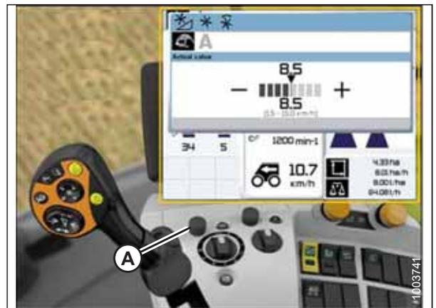
Abbildung 3.449: Display, Bedienkonsole und Multifunktionshebel des CLAAS Mähreschers
