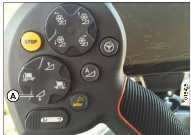
Abbildung 3.300: Taste „Schneidwerk absenken“
