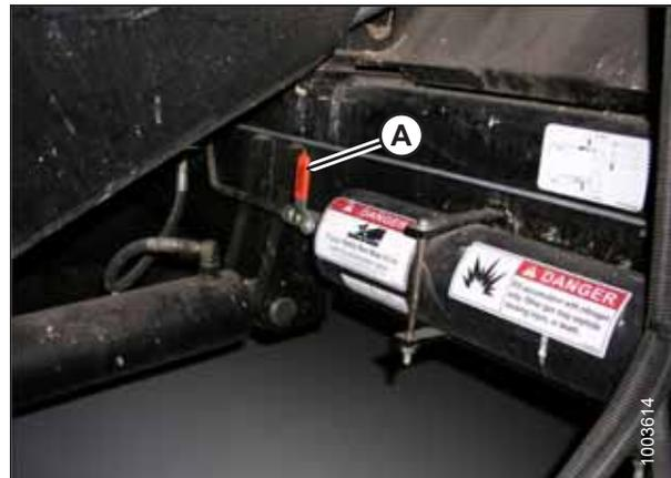
**Abbildung 3.272: Absperrehebel für Druckspeicher**
