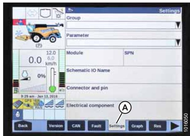
Abbildung 3.479: Bildschirmanzeige eines New Holland-Mähdreschers
