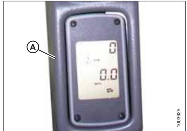
**Abbildung 3.277: Drehzahlmesser**
