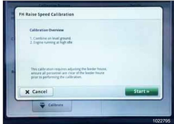
Abbildung 3.406: Display John Deere S7 – Kalibrierung Schrägförderer
