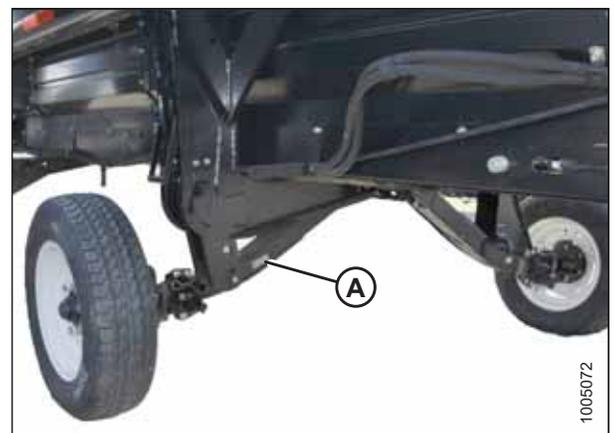
Abbildung 4: Integrierte Transporteinrichtung
