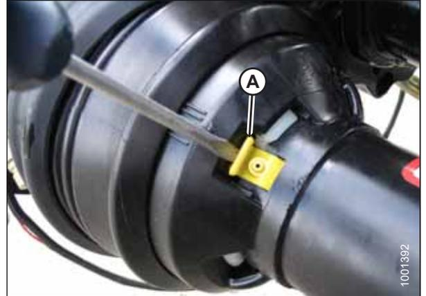
Abbildung 5.39: Antriebswellen-Schutztrichter
