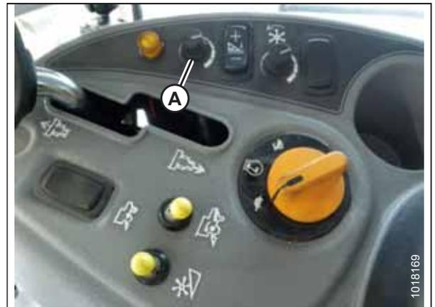
**Abbildung 3.260: Schneidwerkshöhe-Drehknopf auf der Bedienkonsole**
