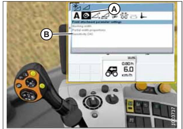
Abbildung 3.444: Display, Bedienkonsole und Multifunktionshebel des CLAAS Mähdreschers
