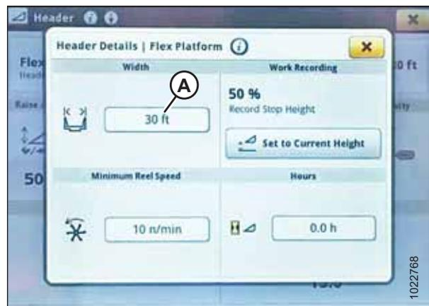
Abbildung 3.388: Display John Deere S7 – Bildschirm mit Schneidwerksangaben
