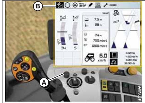
Abbildung 3.436: Display, Bedienkonsole und Multifunktionshebel des CLAAS Mähdreschers
