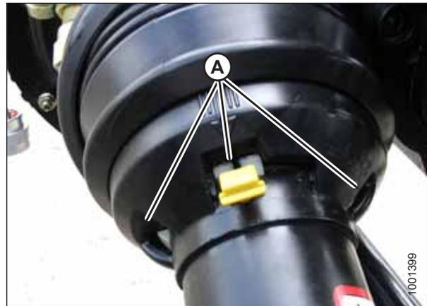
Abbildung 5.42: Antriebswellen-Schutztrichter
