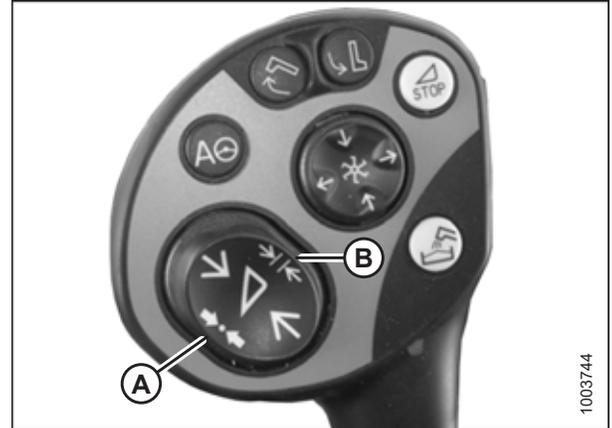
Abbildung 3.435: Tasten auf CLAAS Multifunktionshebel
