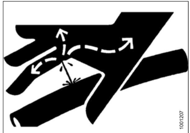
Abbildung 1.12: Gefährdung durch Hydraulikdruck
