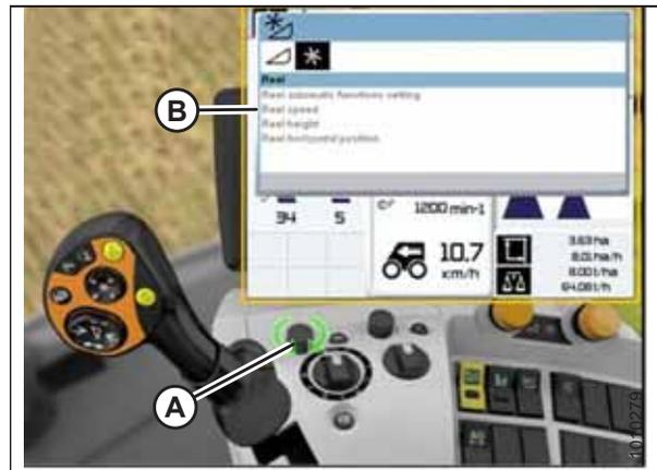
**Abbildung 3.447: Display, Bedienkonsole und Multifunktionshebel des CLAAS Mähdreschers**
