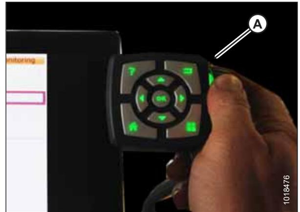
Abbildung 3.311: Scrollrad rechts am Tyton-Terminal
