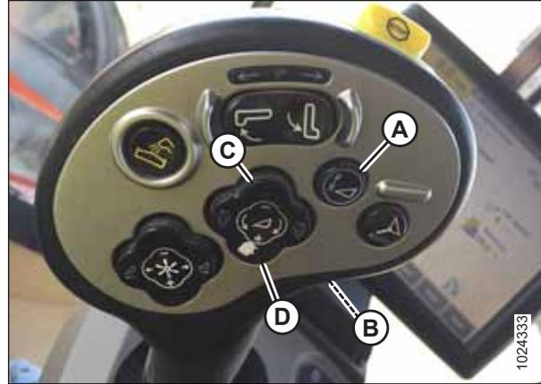
Abbildung 3.248: Bedienpult eines Case-Mähdreschers
