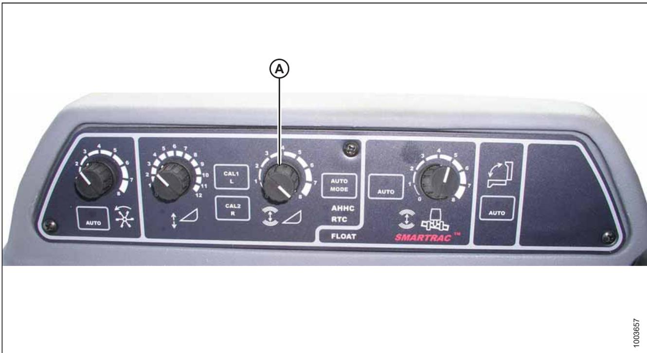
Der Drehknopf für die EMPFINDLICHKEITSEINSTELLUNG (A) bestimmt, wie weit sich der Messerbalken nach oben oder unten bewegen muss, damit die automatische Schneidwerkshöhenregulierung AHHC anspricht und den Schrägförderer hebt oder senkt.
