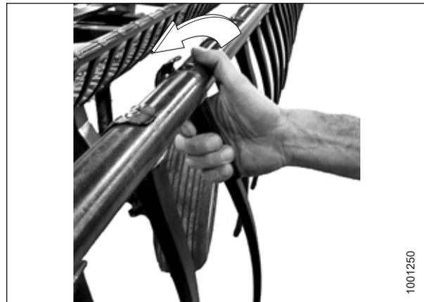
Abbildung 5.233: Ausbauen eines Kunststoffhaspelfingers
