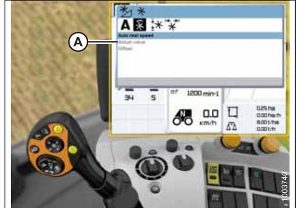
Abbildung 3.448: Display, Bedienkonsole und Multifunktionshebel des CLAAS Mähreschers
