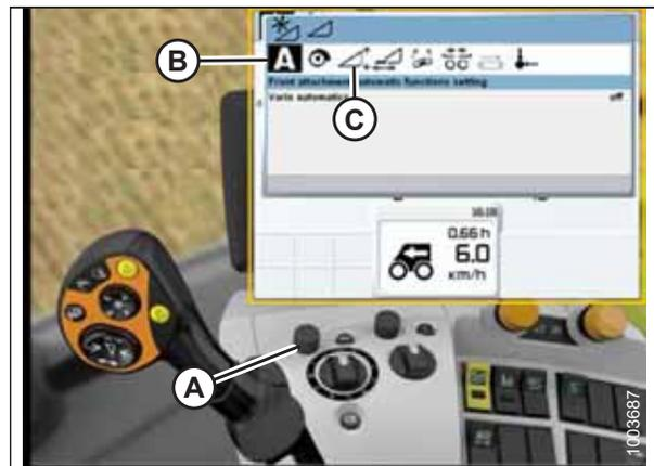
Abbildung 3.438: Display, Bedienkonsole und Multifunktionshebel des CLAAS Mähdreschers
