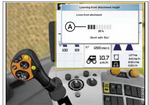
Abbildung 3.440: Display, Bedienkonsole und Multifunktionshebel des CLAAS Mähdreschers
