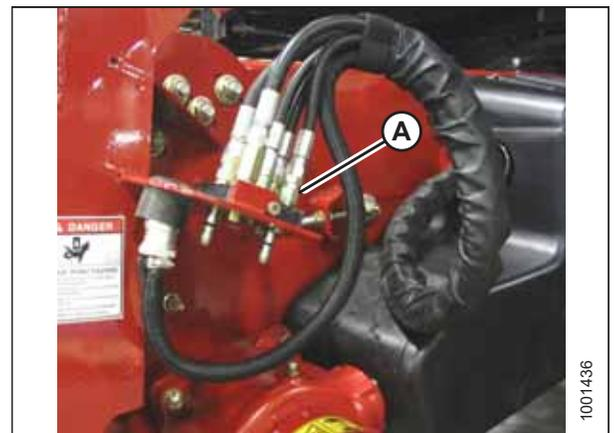
Abbildung 4.52: Multikuppler am Mährescher
