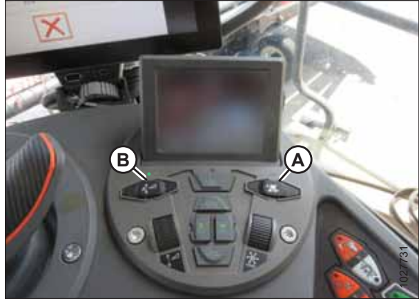
Figure 3.212: Groupe de commande de la plateforme
