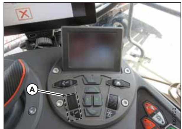
Figure 3.217: Groupe de commande de la plateforme
