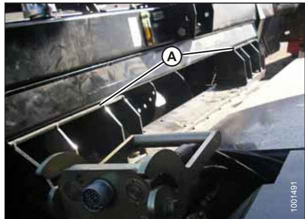
Figure 4.70: Convoyeur et module de flottement
