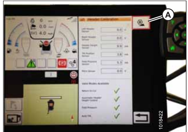
Figure 3.380: Étalonnage de la plateforme
