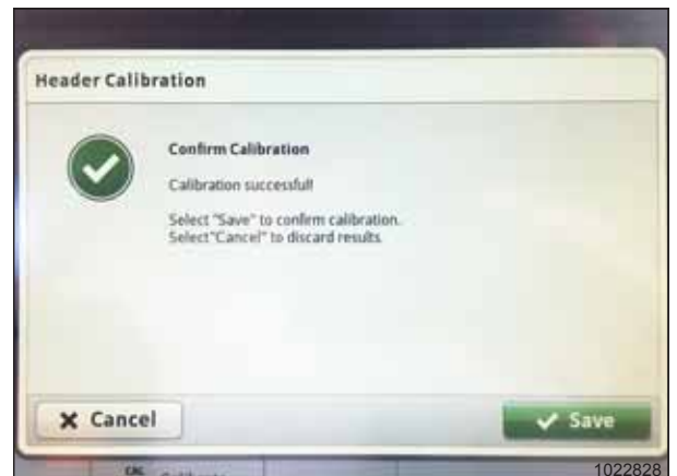
Figure 3.495: Écran John Deere S7 – Étalonnage de la plateforme
