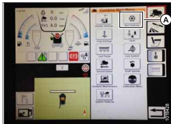
Figure 3.367: Paramètres du rabatteur dans le menu principal de la moissonneuse-batteuse
