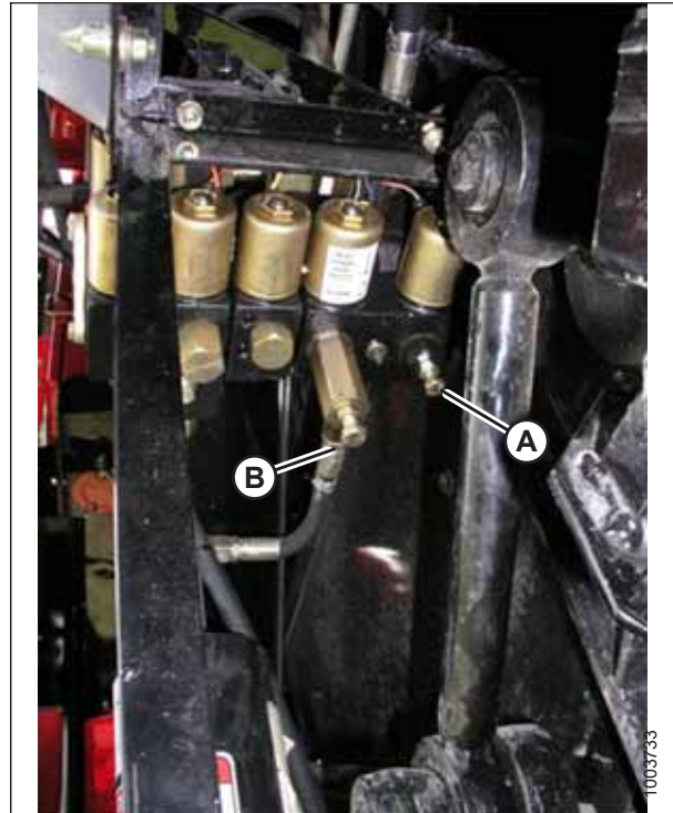
Figure 3.351: Limiteurs réglables d'élévation et d'abaissement de la plateforme
