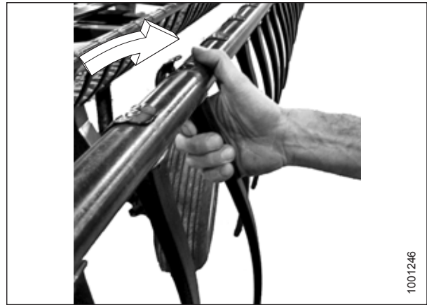
Figure 5.246: Installation des doigts en plastique
