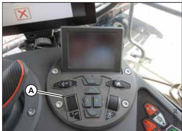
Figure 3.214: Groupe de commande de la plateforme
