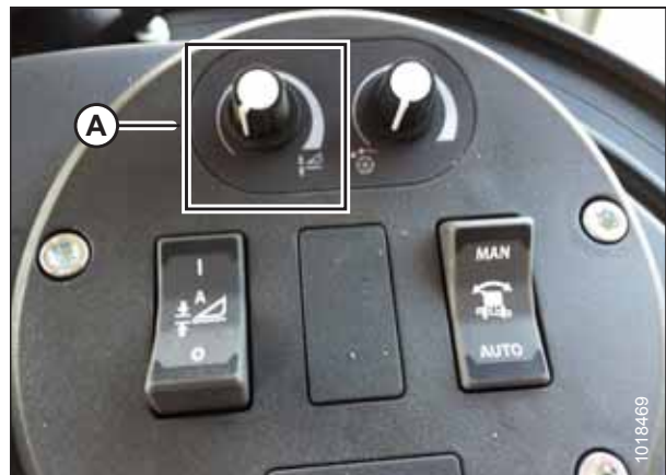
Figure 3.391: Groupe de commande de la plateforme
