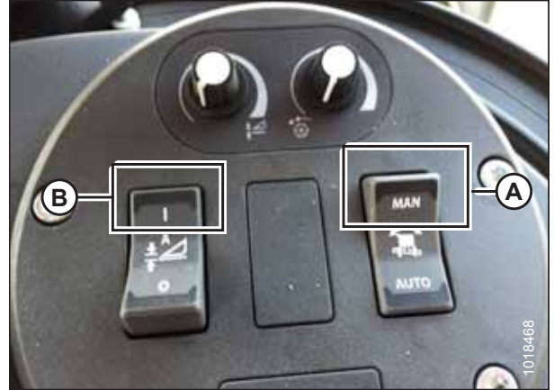
Figure 3.386: Groupe de commande de la plateforme
