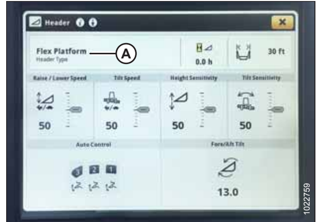
Figure 3.467: Écran John Deere S7 – Page Plateforme
