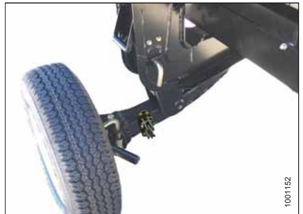
Figure 3.572: Roue gauche en position de transport
