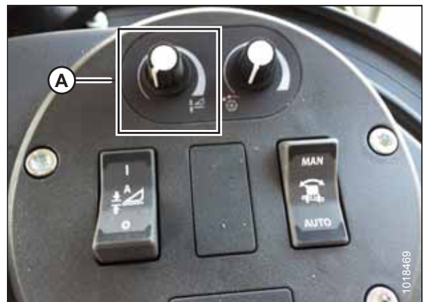
Figure 3.388: Groupe de commande de la plateforme
