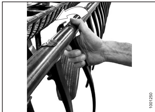
Obr. 5.228: Demontáž plastového prstu
