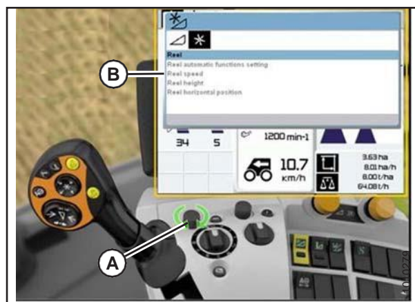
Obr. 3.334: Displej, ovládací panel a joystick sklízecí mlátičky CLAAS
