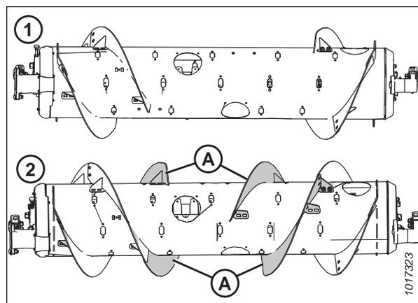
Figure 3.56: Configurations de la vis d'alimentation – vue arrière
