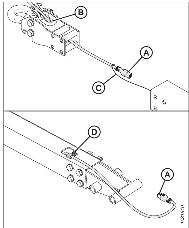
Figure 4.355: Installation de l'adaptateur pour anneau d'attelage
