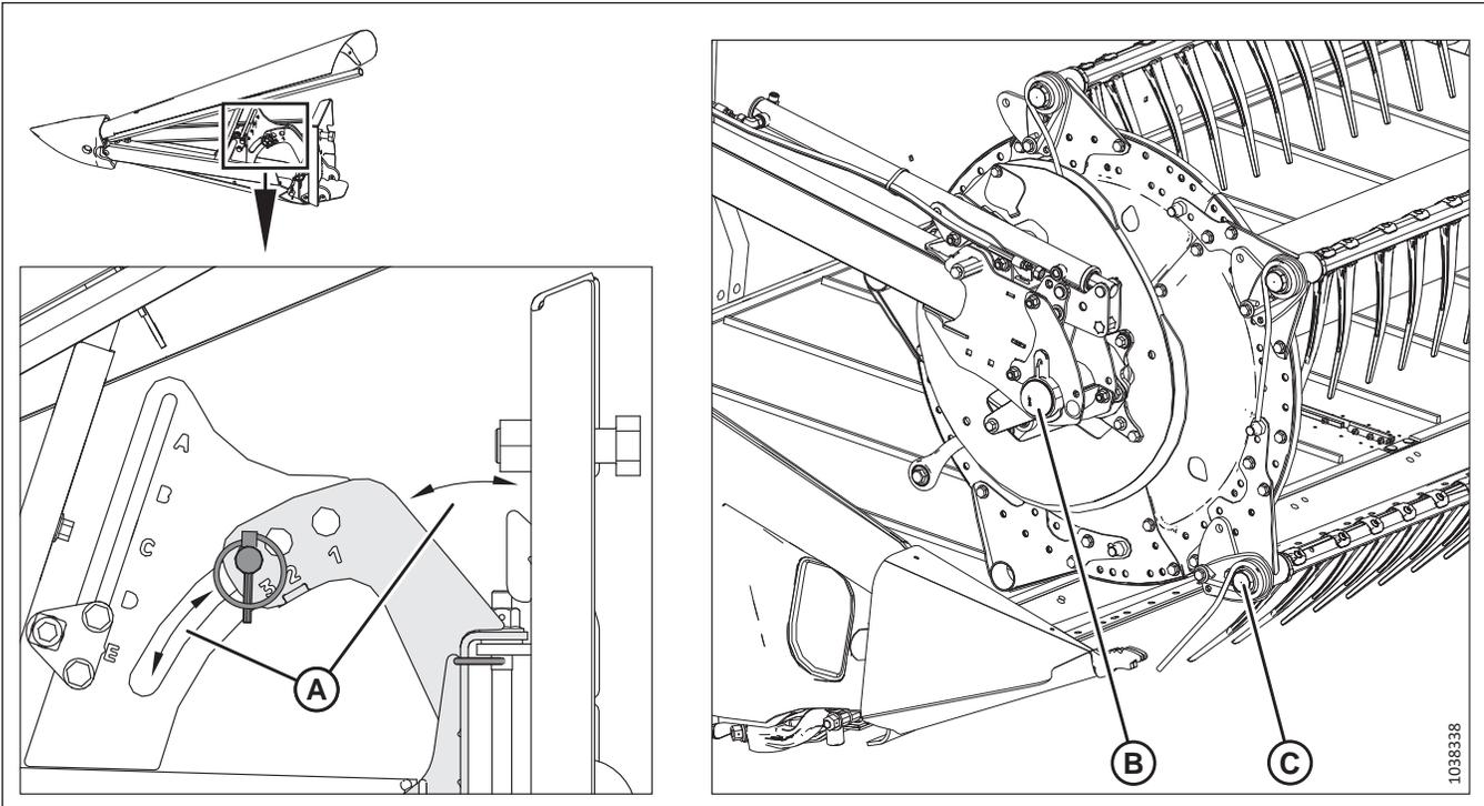
Figure 3.202: Plage de mouvement du diviseur de récolte flottant
