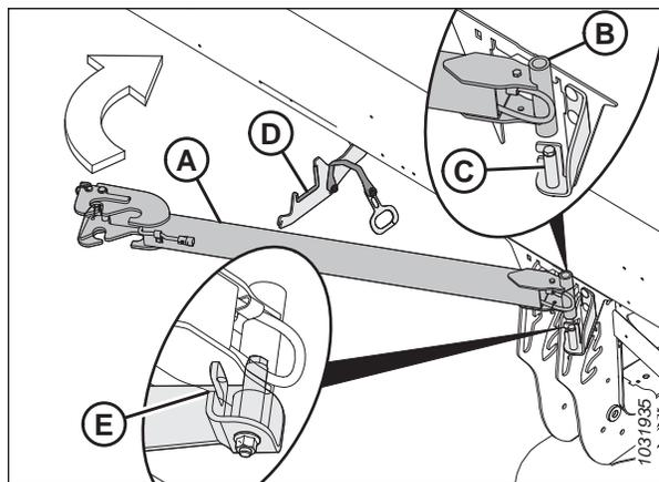
Figure 3.298: Stockage de l'extension de la barre de remorquage
