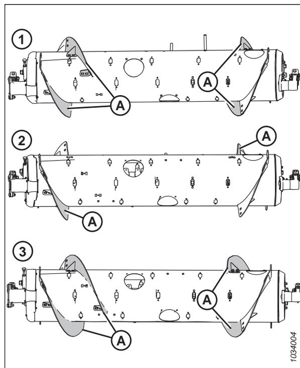
Figure 3.76: Configurations de la vis d'alimentation – vue arrière
