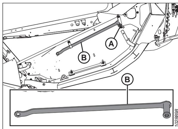
Figure 4.329: Emplacement de rangement de l'outil polyvalent – Côté gauche
