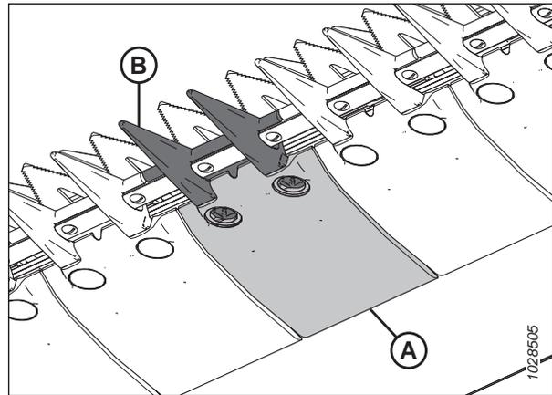
**Figure 4.156: Doigts de couteau court et plaque d'usure**
