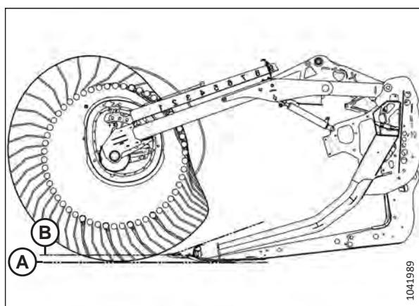
Figure 3.172: Profil des doigts – Came en position 4, angle de la plateforme minimal
