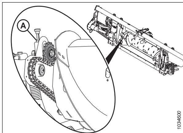
Figure 4.92: Entraînement du transporteur à vis
