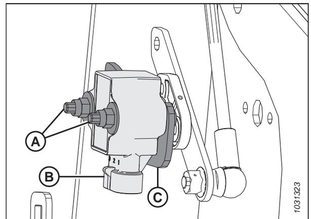
Figure 3.153: Capteur de hauteur du rabatteur – Bras droit du rabatteur
