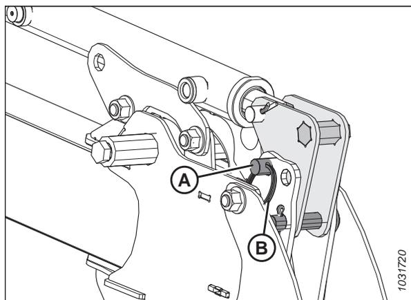
Figure 3.161: Réglage des vérins avant-arrière de type 1 – Position arrière
