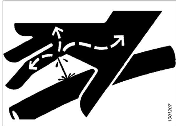
Figure 1.12: Risque lié à la pression hydraulique
