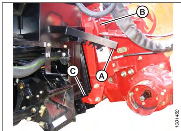
Figure 3.49: Verrous du convoyeur
