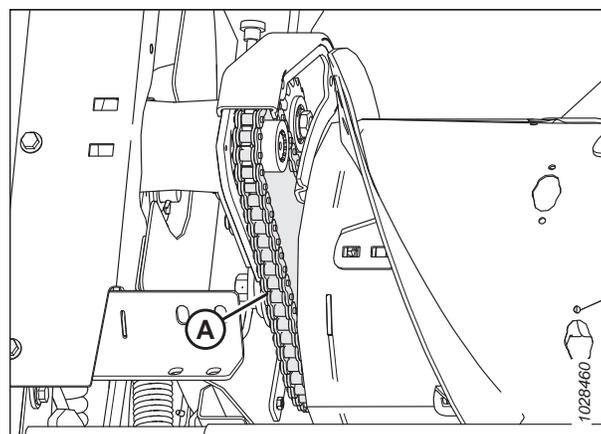
Figure 4.77: Chaîne de la vis d'alimentation – vue arrière
