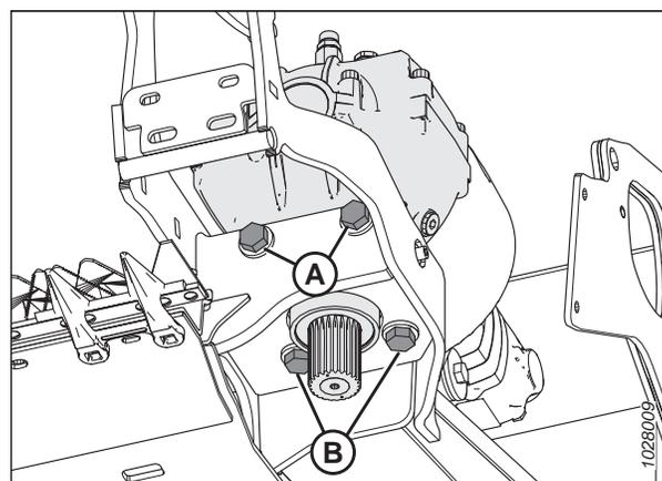
Figure 4.170: Boîtier d'entraînement du couteau - Vue d'en bas
