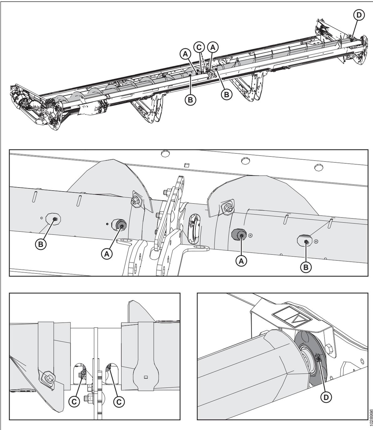
Figure 4.14: Vis transversale supérieure à deux parties
