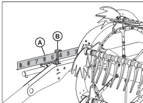
Figure 3.156: Indicateur d'avant-arrière
