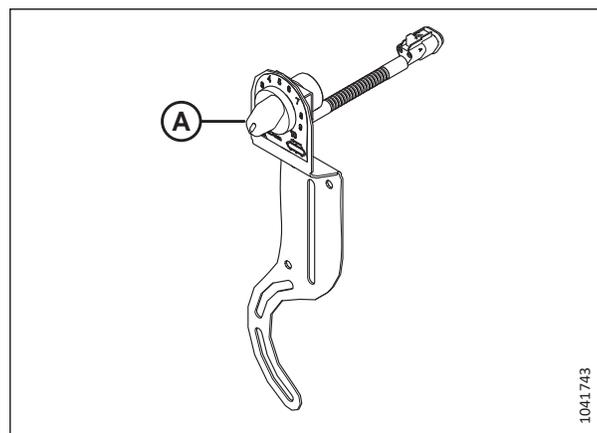
Figure 3.144: Commande de vitesse des tapis latéraux en cabine CNH en option
