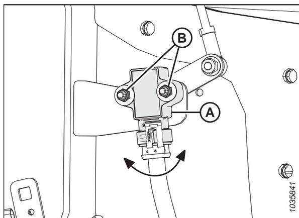
Figure 3.151: Capteur de hauteur du rabatteur – bras droit du rabatteur avec rabatteur en haut
