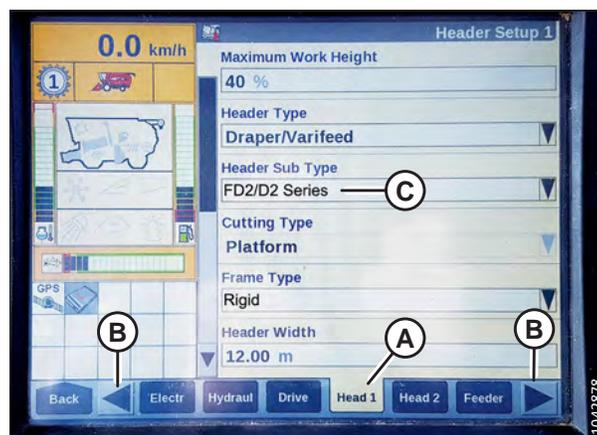
Figure 3.282: Afficheur de la moissonneuse-batteuse Case IH
