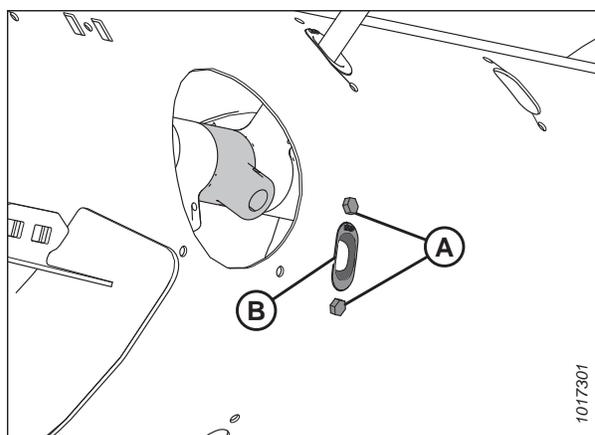
Figure 3.99: Trou du doigt de la vis
