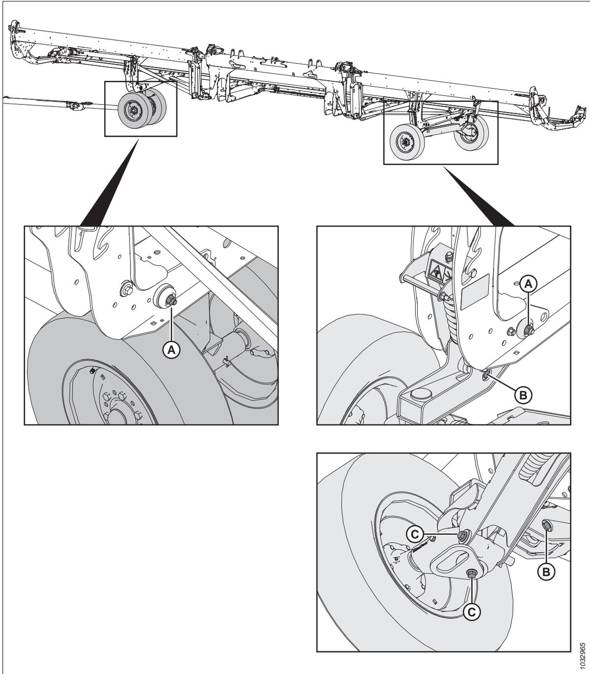
Figure 4.346: Boulons d'assemblage du système de transport
