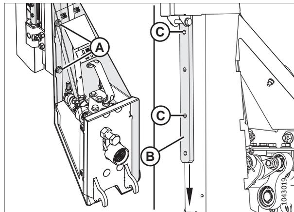
Figure 4.370: Régler la position du couteau
