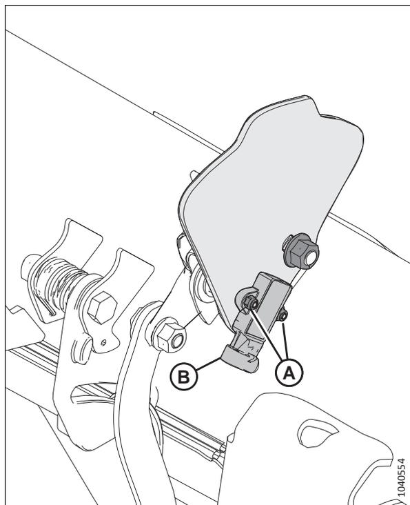
Figure 3.218: Plaque de l'indicateur de flottement droit
