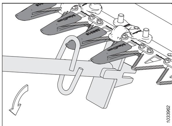
Figure 4.133: Réglage vers le bas - Doigt pointu
