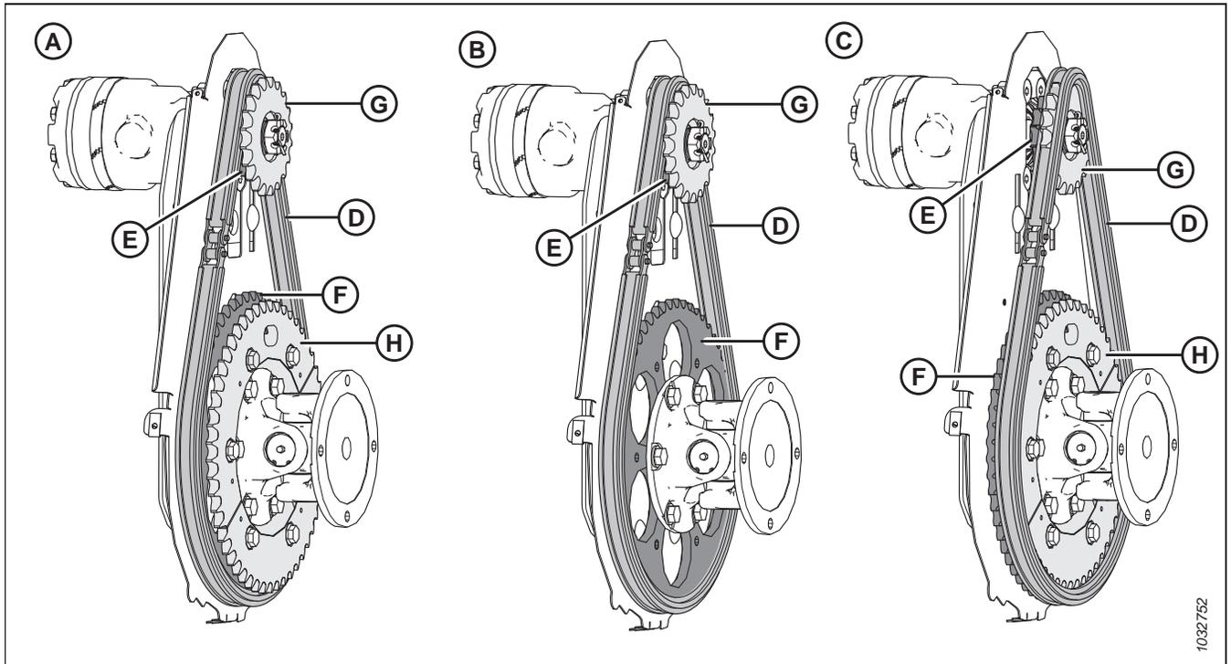
**Figure 4.340: Configurations du rabatteur – Pignons doubles optionnels**
