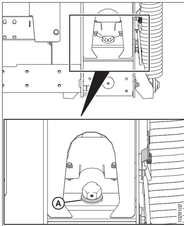
Figure 3.121: Rondelle de butée inférieure
