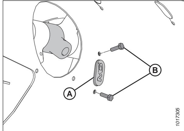
Figure 4.103: Bouchon installé dans la vis sans fin
