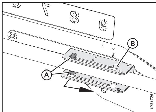
Figure 3.163: Réglage des vérins avant-arrière de type 2 – Position avant
