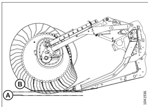
Figure 3.171: Profil des doigts – Position 3 de la came
