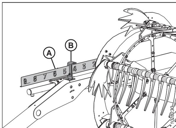
Figure 3.155: Indicateur d'avant-arrière
