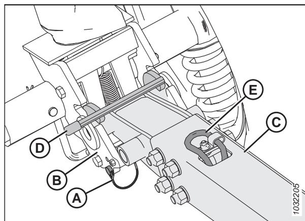
Figure 3.329: Barre de remorquage et pivot de transport gauche
