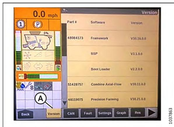
Figure 3.257: Afficheur de la moissonneuse-batteuse Case IH
