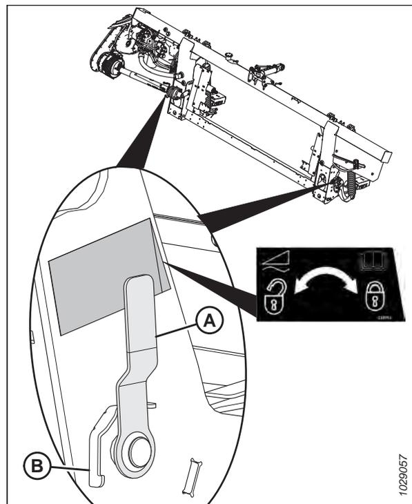
Figure 3.123: Verrou du flottement de la plateforme en position verrouillée
