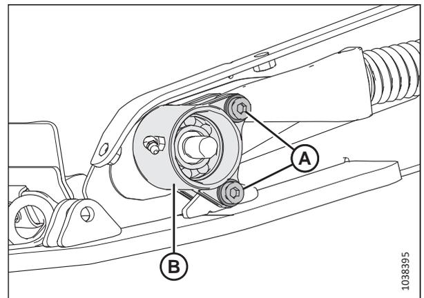
Figure 4.203: Boîtier du roulement à rouleaux libres
