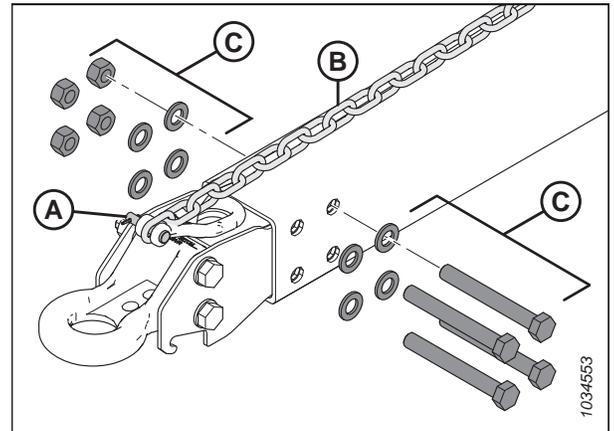
Figure 4.348: Démontage de l'adaptateur de remorquage de l'anneau d'attelage
