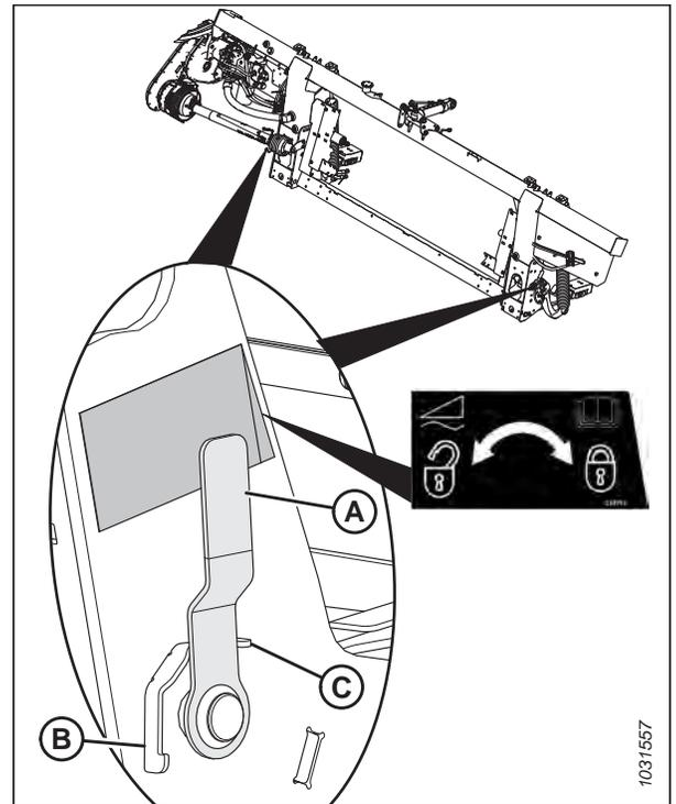
**Figure 3.135: Verrou de flottement - en position verrouillée**
