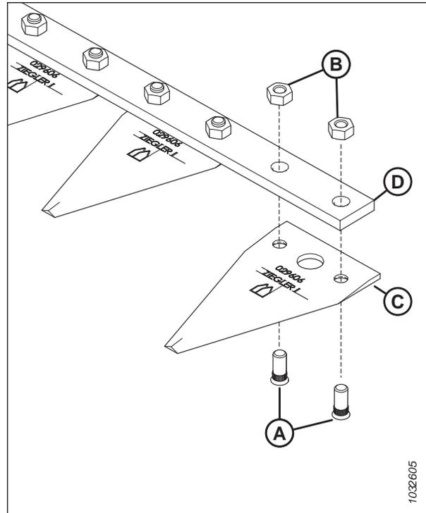
Figure 4.361: Assemblage de la section de couteau
