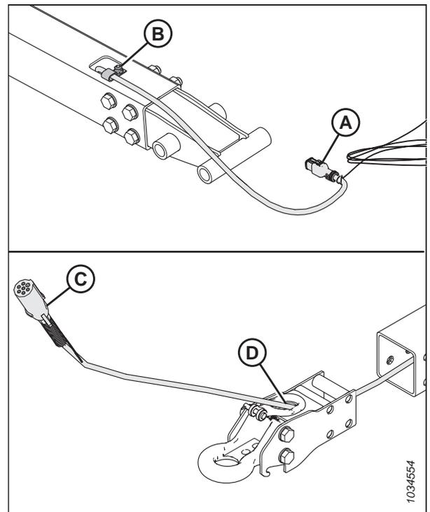
Figure 4.349: Démontage de l'adaptateur de remorquage de l'anneau d'attelage
