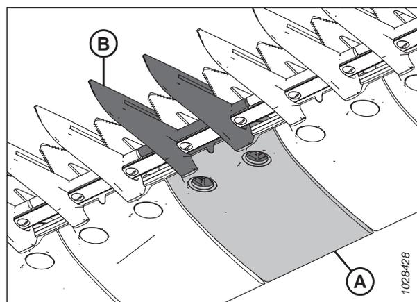
Figure 4.138: Doigts de couteau pointus et plaque d'usure
