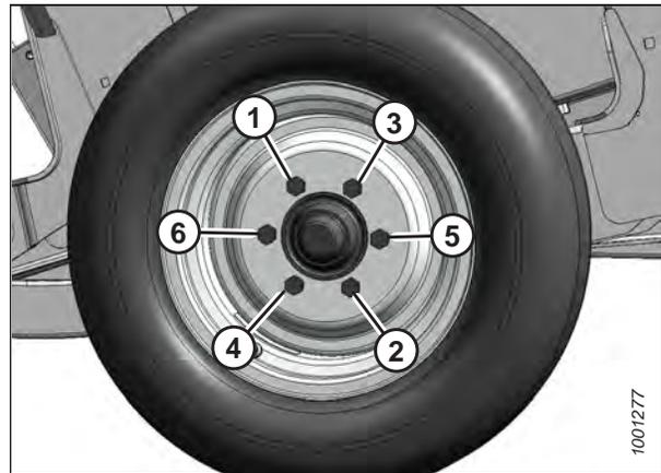
Figure 4.345: Séquence de serrage des boulons
