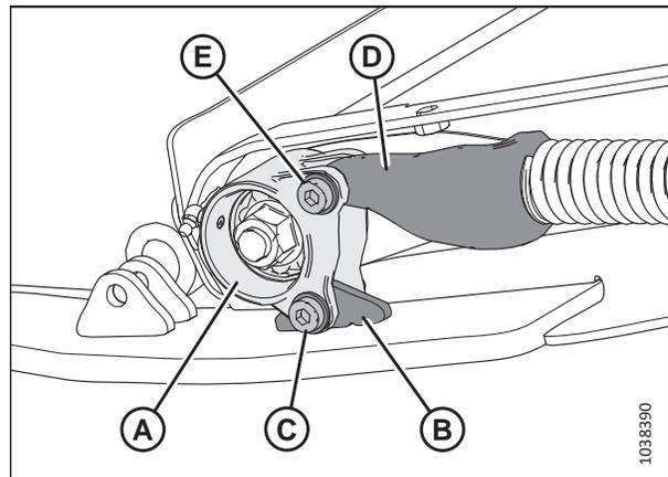
Figure 4.221: Roulement du rouleau libre - Côté gauche
