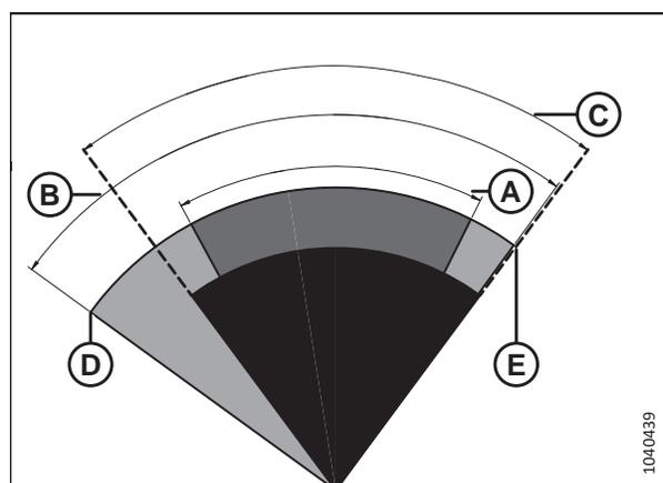
**Figure 3.212: Plage des capteurs trop proche de la limite de tension**
