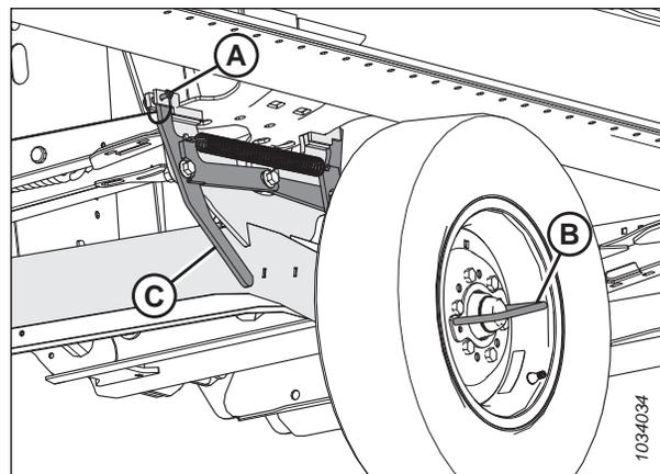
Figure 3.308: Essieu de transport droit verrouillé dans la position de transport
