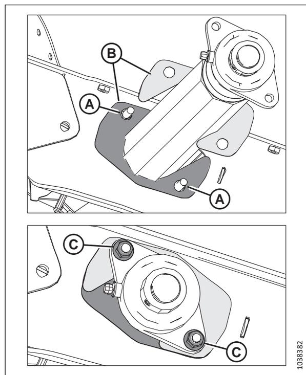
Figure 4.194: Rouleau d'entraînement – extrémité du roulement
