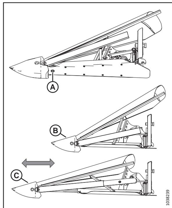
Figure 3.198: Réglage avant-arrière de la pointe avant
