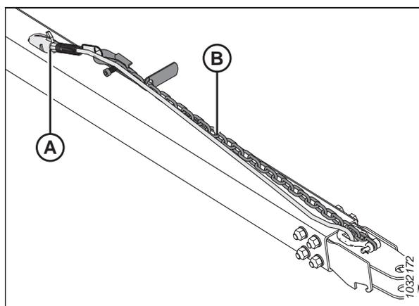
Figure 3.331: Harnais de câblage de la barre de remorquage
