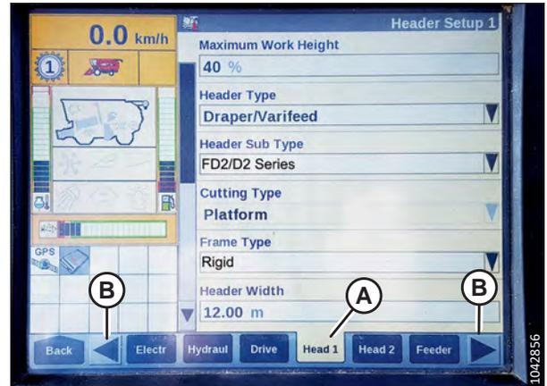
Figure 3.276: Afficheur de la moissonneuse-batteuse Case IH
