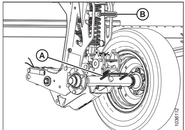
Figure 3.306: Roues de transport gauches dans la position de rangement la plus haute
