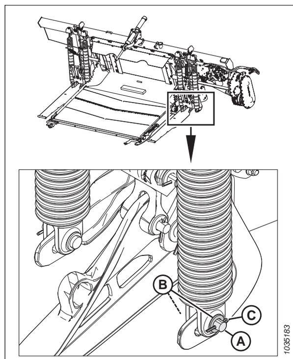
Figure 3.131: Ressort de flottement gauche installé dans le trou arrière du levier de flottement
