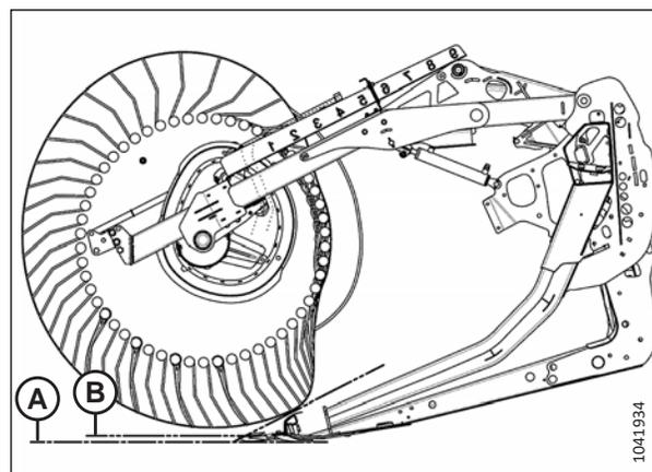
Figure 3.169: Profil des doigts – Position 1 de la came
