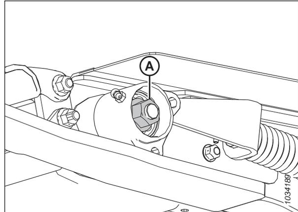
Figure 4.220: Roulement à rouleaux libres (côté gauche)
