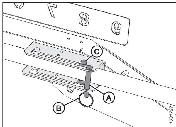
Figure 3.164: Réglage des vérins avant-arrière de type 2 – Position arrière
