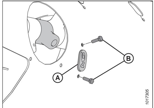
Figure 4.106: Trou du doigt de la vis
