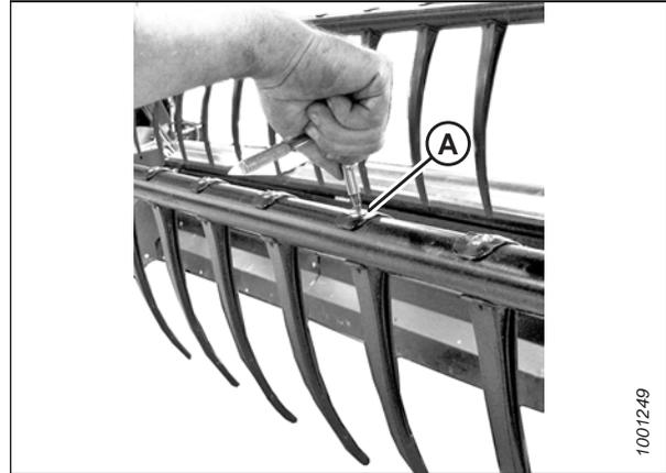
Figure 4.285: Retrait des doigts en plastique
