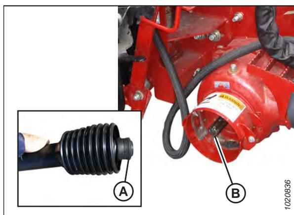
Figure 3.40: Arbre de sortie de la moissonneuse-batteuse
