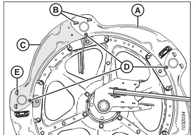
Figure 4.317: Boucliers des rabatteurs - Extrémité arrière extérieure
