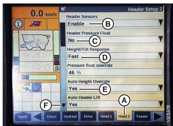
Figure 3.262: Afficheur de la moissonneuse-batteuse Case IH
