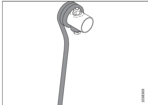
Figure 5.24: Doigts d'extrémité extérieurs en acier
