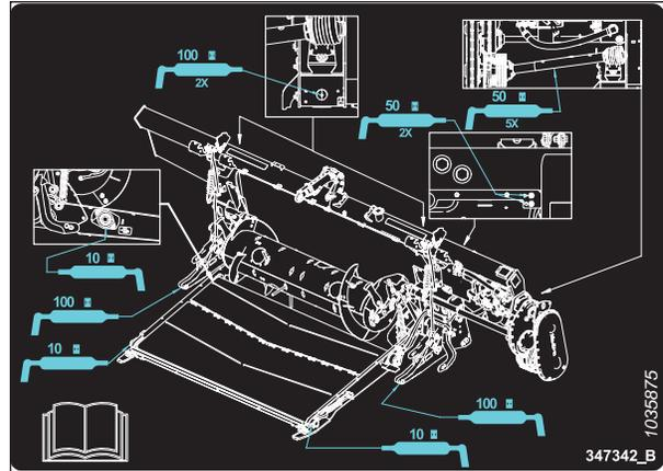
Figure 4.5: Autocollant indiquant les points de graissage FM200
