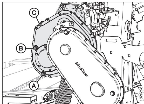
Figure 4.30: Boîte de vitesses principal d'entraînement de la plateforme
