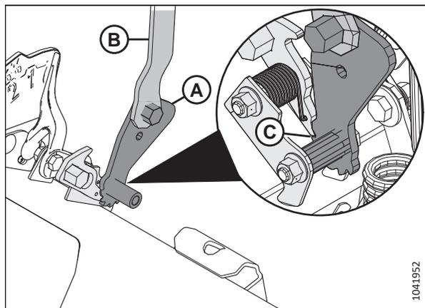
Figure 3.125: Outil polyvalent engagé avec l'ensemble de réglage du flottement gauche
