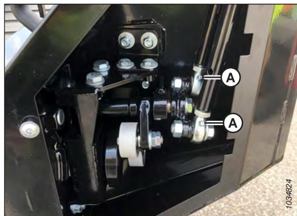
Figure 4.363: Graissage des embouts sur les tiges-poussoirs des couteaux verticaux
