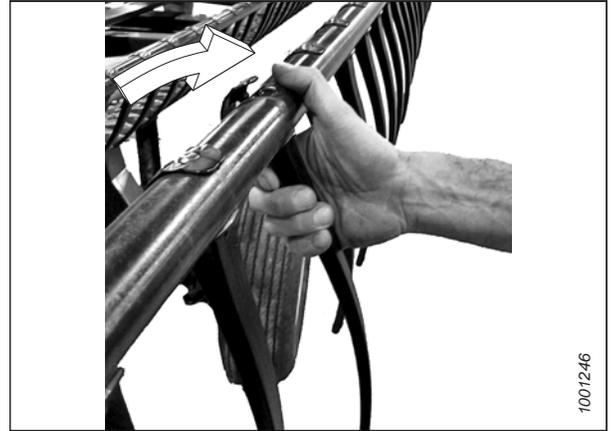
Figure 4.287: Installation des doigts en plastique
