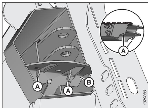
Figure 3.301: Crochets de retenue de l'extrémité de la chape
