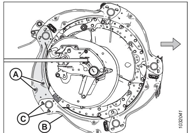
Figure 4.307: Boucliers des rabatteurs - Extrémité de came extérieure
