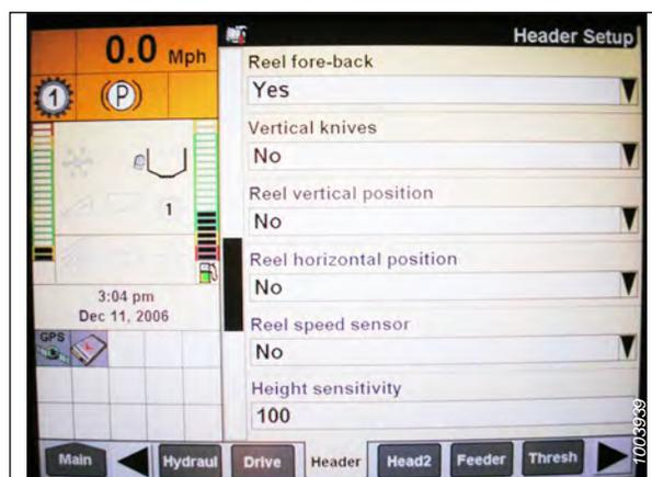
Figure 3.251: Afficheur de la moissonneuse-batteuse Case IH
