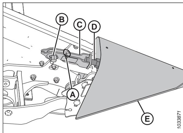
Figure 3.183: Diviseur de récolte avec verrouillage
