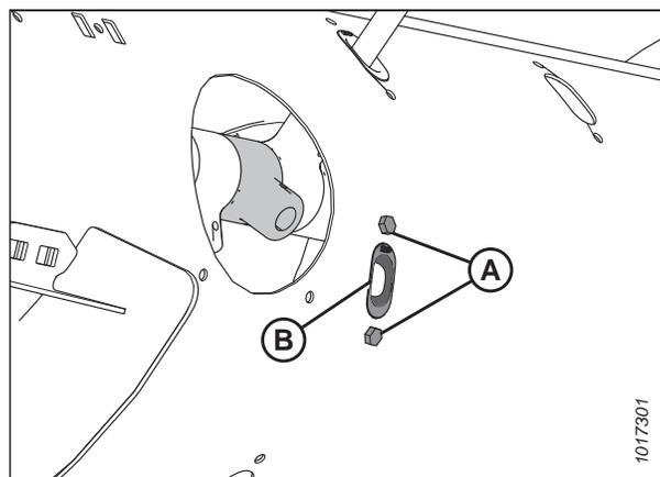
Figure 3.102: Trou du doigt de la vis
