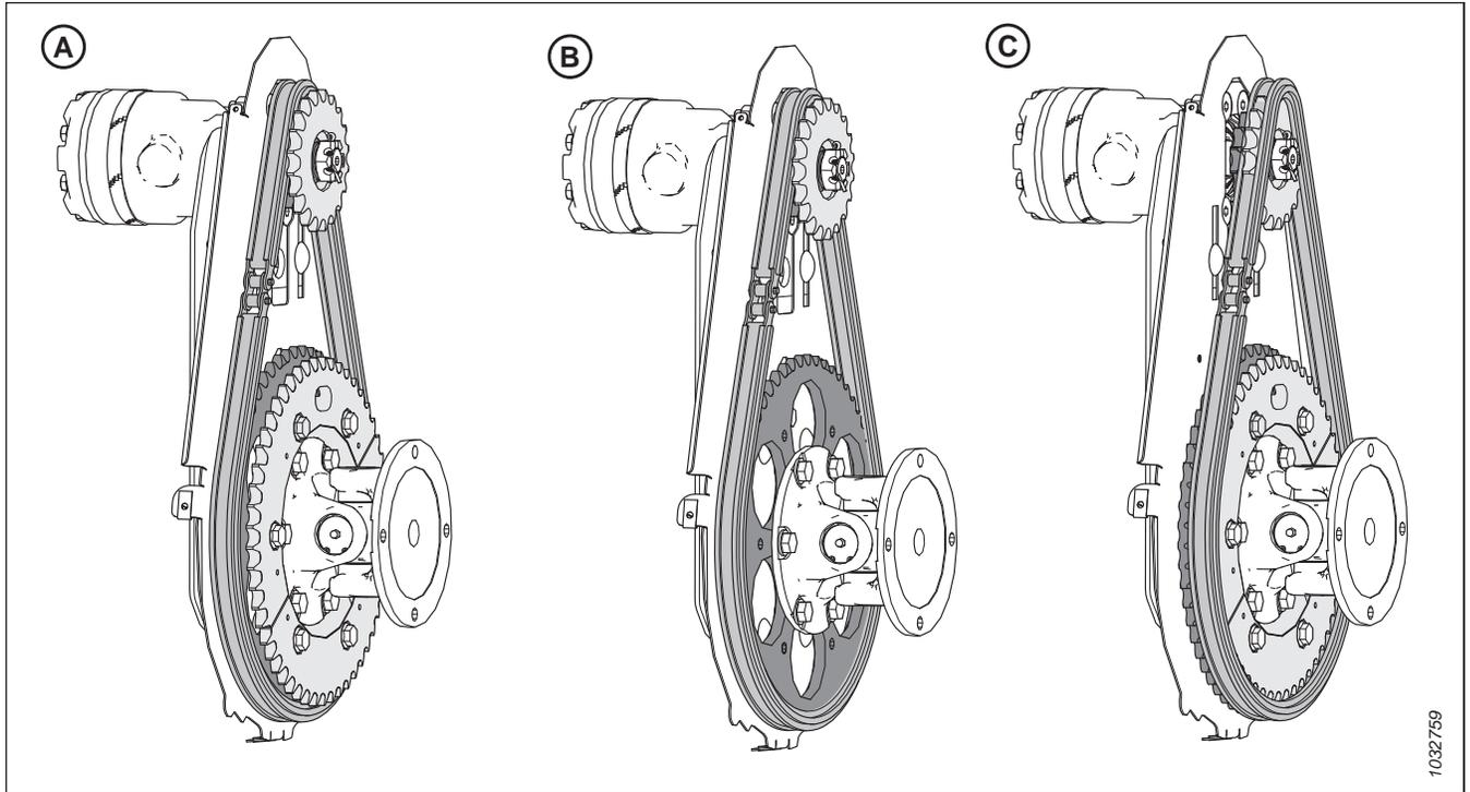
Figure 4.337: Configurations du rabatteur – Pignons doubles optionnels
