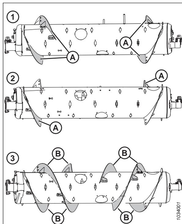
Figure 3.57: Configurations de la vis d'alimentation – vue arrière
