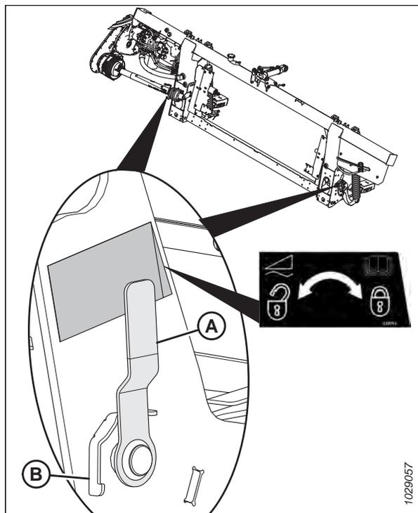
Figure 3.129: Verrou du flottement de la plateforme en position verrouillée
