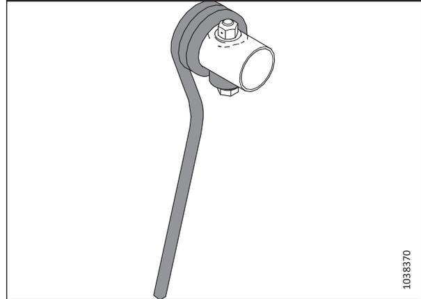
Figure 5.23: Doigt d'extrémité intérieur en acier
