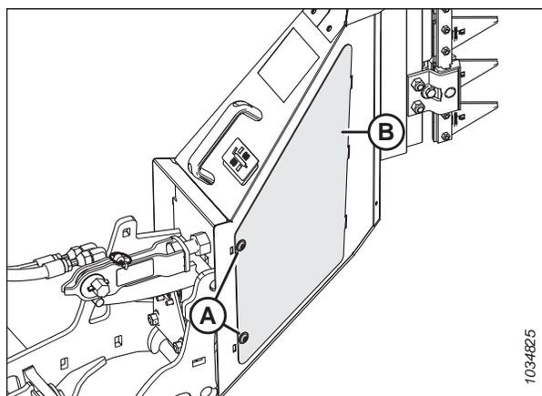
Figure 4.366: Capot d'accès aux couteaux verticaux
