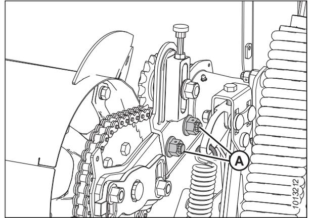
Figure 4.83: Bras de support du transporteur à vis
