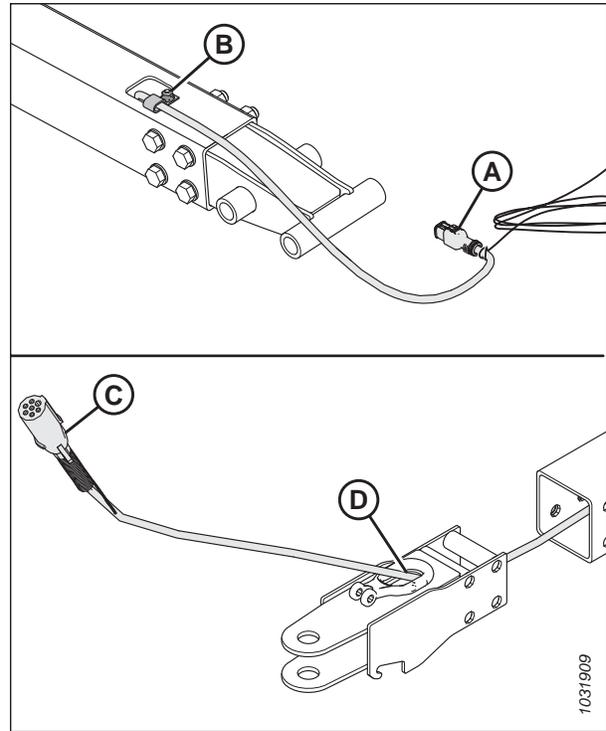
Figure 4.354: Démontage de l'adaptateur de remorquage de la chape
