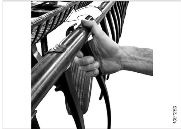
Figure 4.286: Retrait des doigts en plastique
