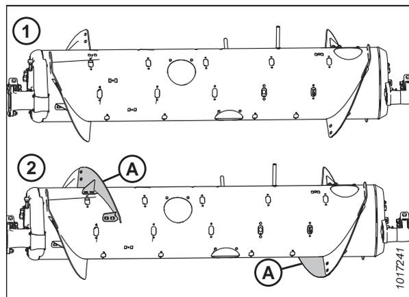
Figure 3.66: Configurations de la vis d'alimentation – vue arrière
