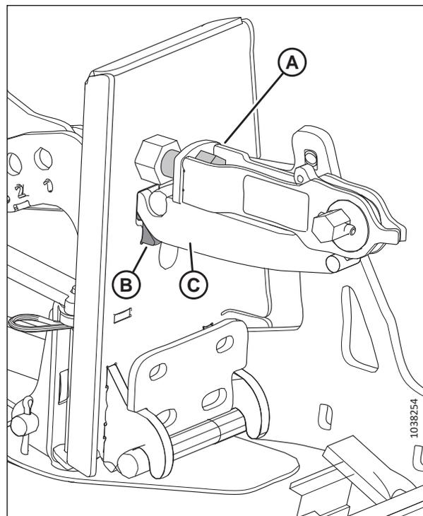
Figure 3.195: Diviseur de récolte verrouillé sur la plateforme
