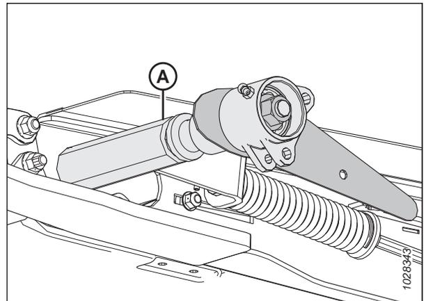
Figure 4.208: Tendeur d'alimentation - Côté gauche
