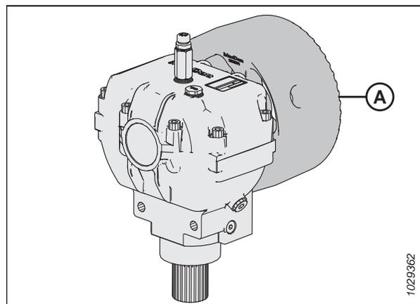
Figure 3.147: Volant d'inertie
