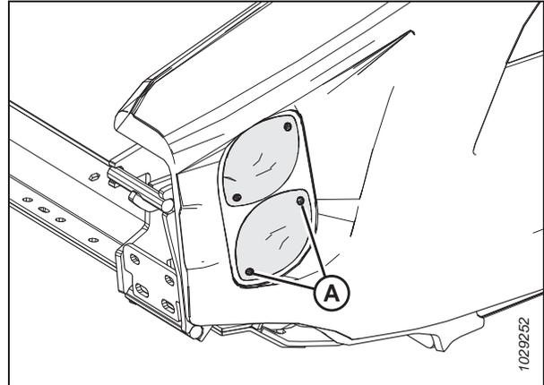
Figure 4.39: Option transport – feux oranges et rouges
