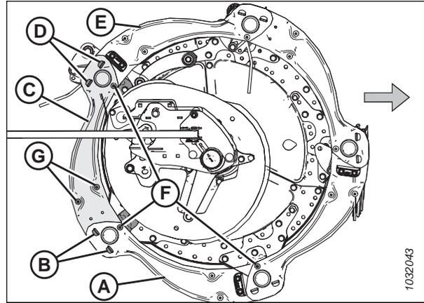
Figure 4.309: Boucliers des rabatteurs - Extrémité de came extérieure
