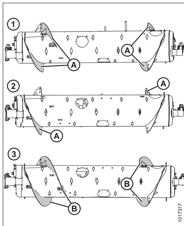
Figure 3.62: Configurations de la vis d'alimentation – vue arrière
