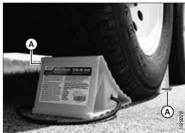
Figure 3.323: Blocage des pneus
