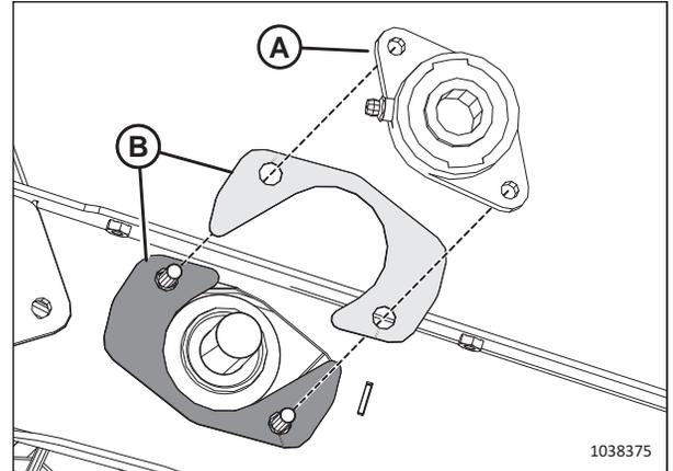
Figure 4.198: Roulement à rouleaux d'entraînement du tapis d'alimentation
