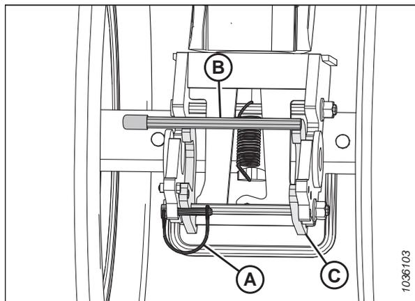
Figure 3.303: Roues de transport gauches – Loquet de verrouillage de rotation désengagé
