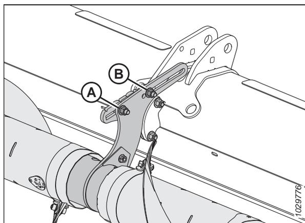
Figure 3.180: Position initiale des supports réglables - Vis en deux parties
