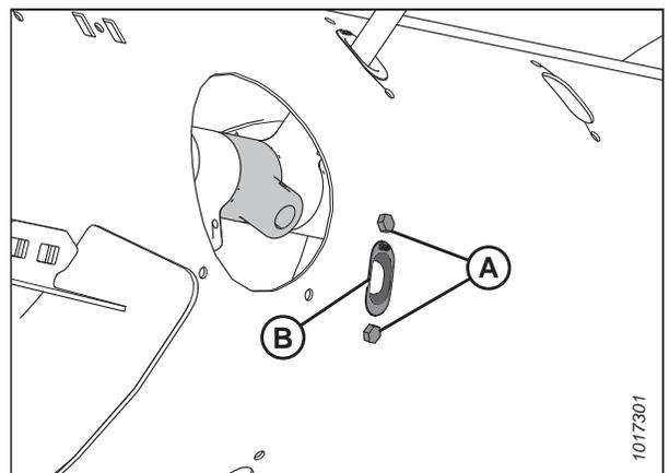
Figure 4.107: Trou du doigt de la vis
