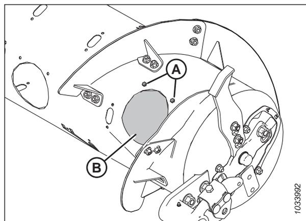
Figure 3.77: Capot d'accès à la vis – Côté droit
