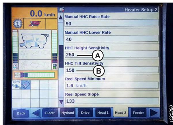
Figure 3.263: Afficheur de la moissonneuse-batteuse Case IH
