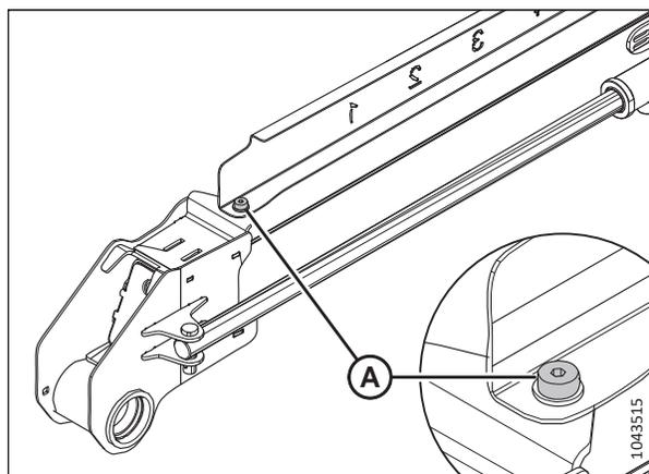
Figure 3.168: Boulon de l'indicateur
