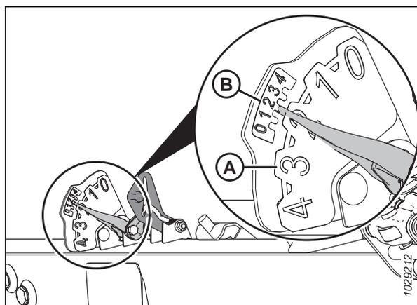
Figure 3.116: Indicateur du flottement – côté gauche
