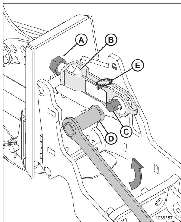
Figure 3.196: Ajustement du loquet
