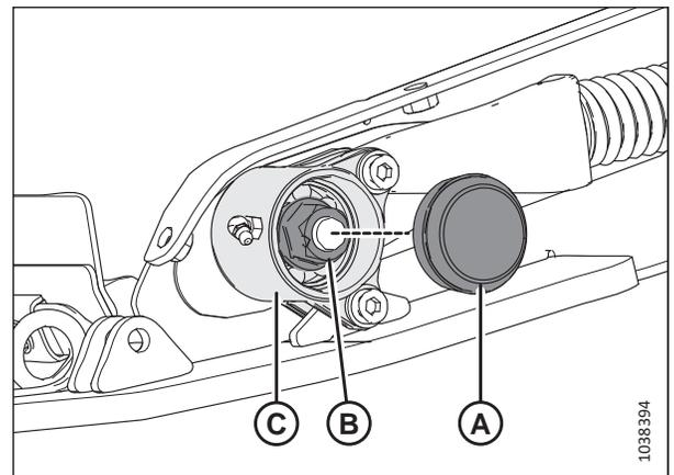
Figure 4.202: Boîtier du roulement à rouleaux libres
