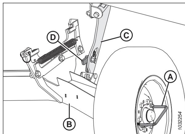
Figure 3.310: Essieu de transport droit verrouillé dans la position de travail
