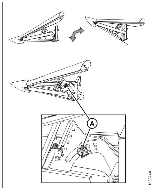
Figure 3.197: Réglage de la butée d'arrêt
