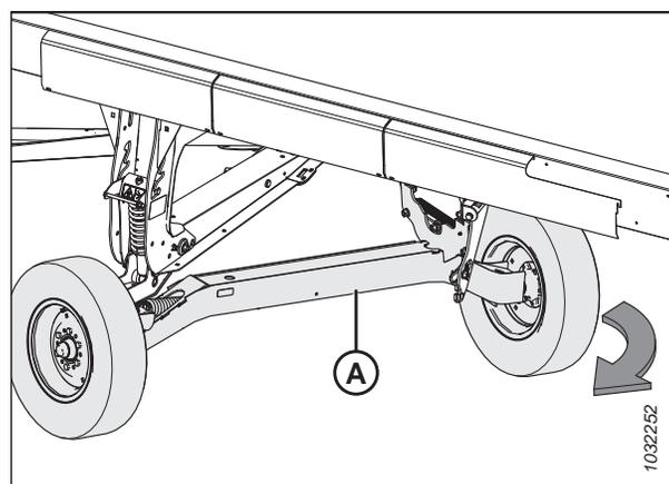
Figure 3.309: Rotation de l'essieu de transport droit
