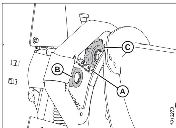
Figure 4.26: Chaîne d'entraînement du transporteur à vis
