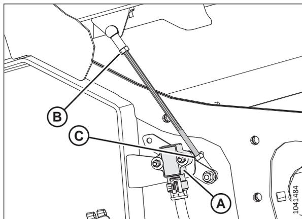
Figure 3.150: Capteur de hauteur du rabatteur – Bras de rabatteur droit avec le rabatteur abaissé
