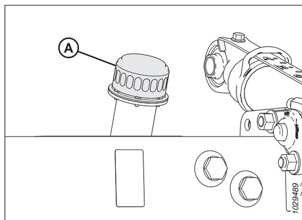
Figure 4.35: Bouchon de remplissage du réservoir d'huile
