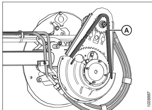
Figure 4.24: Chaîne d'entraînement – Entraînement de rabatteur double illustré
