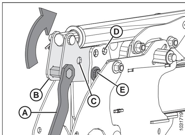
Figure 3.160: Réglage des vérins avant-arrière de type 1 – Position avant
