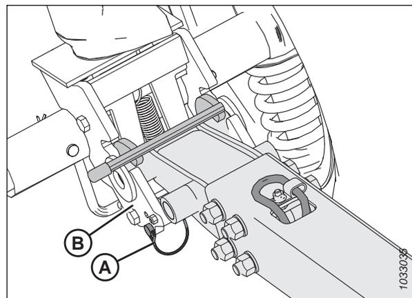
Figure 3.296: Barre de remorquage et pivot de transport gauche
