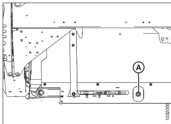
Figure 4.269: Tension du tapis – côté gauche illustré
