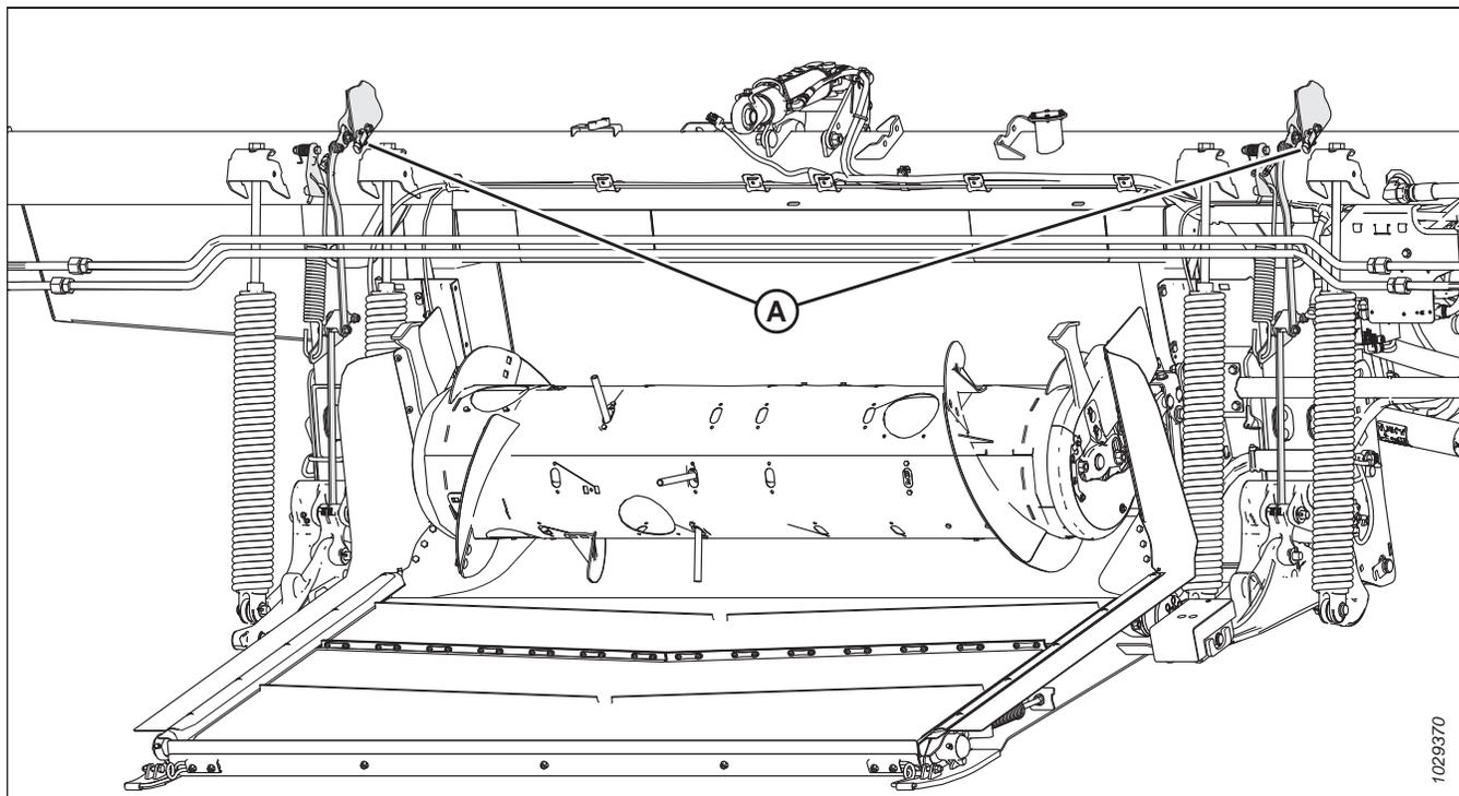
Figure 3.210: Emplacement des capteurs de contrôle de la hauteur sur le module de flottement
