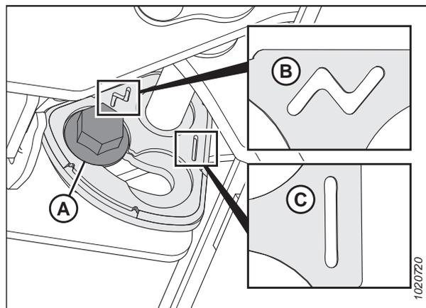
Figure 3.106: Positions du flottement de la vis d'alimentation
