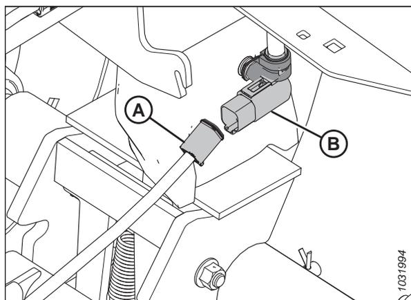
Figure 3.295: Connexion électrique de la barre de remorquage
