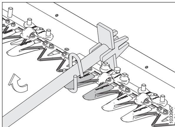
Figure 4.131: Réglage vers le haut - Doigt pointu
