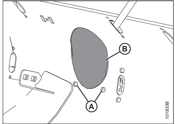
Figure 4.105: Couvercle d'accès au transporteur à vis
