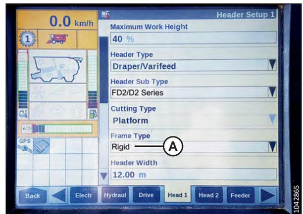
Figure 3.278: Afficheur de la moissonneuse-batteuse Case IH
