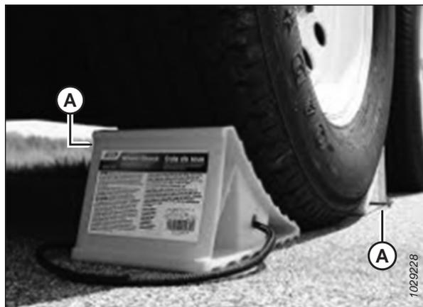
Figure 3.288: Blocage des pneus
