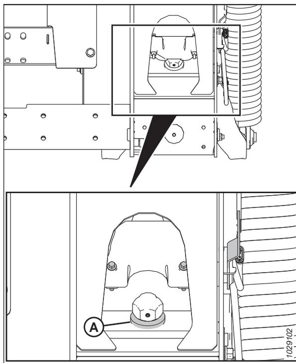
Figure 3.215: Rondelle de butée inférieure
