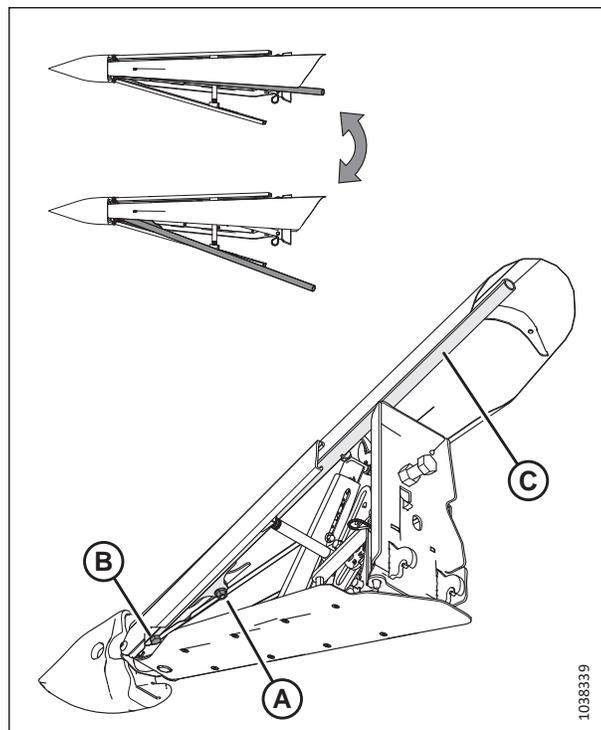
Figure 3.201: Réglage de la tige latérale du déflecteur supérieur
