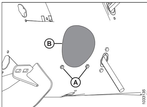
Figure 3.104: Couvercle d'accès à la vis
