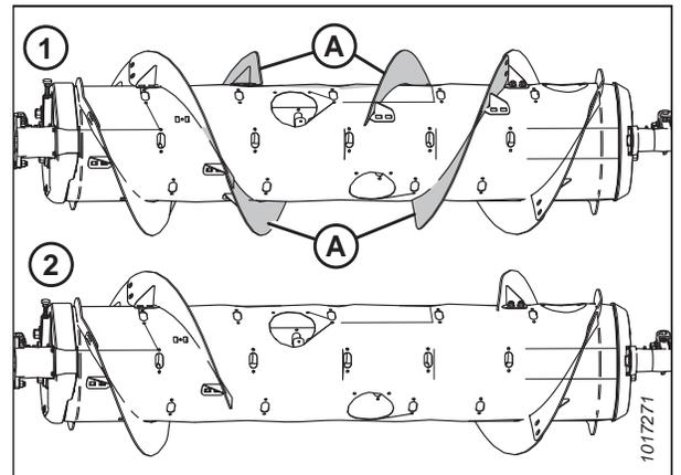
Figure 3.61: Configurations de la vis d'alimentation – vue arrière
