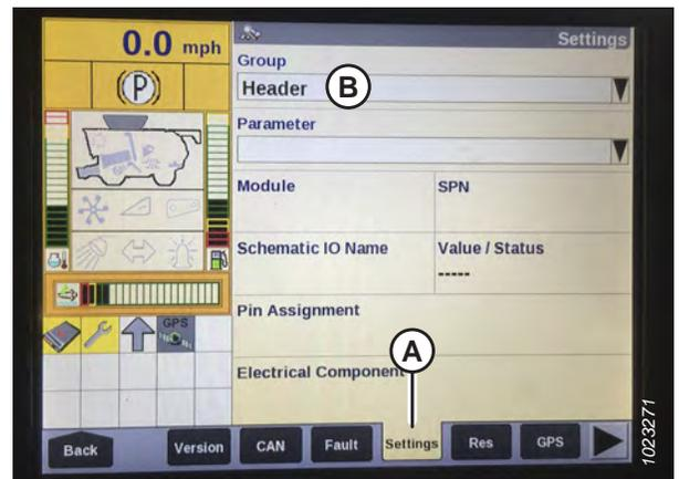
Figure 3.224: Afficheur de la moissonneuse-batteuse Case IH
