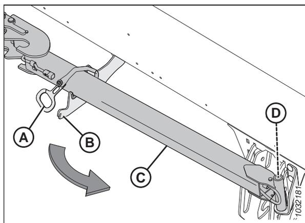
Figure 3.321: Stockage de l'extension de la barre de remorquage
