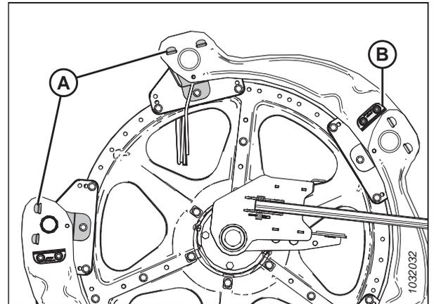
Figure 4.316: Bouclier du rabatteur enlevé - Extrémité arrière extérieure
