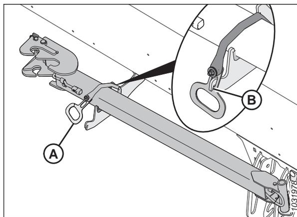
Figure 3.299: Stockage de l'extension de la barre de remorquage
