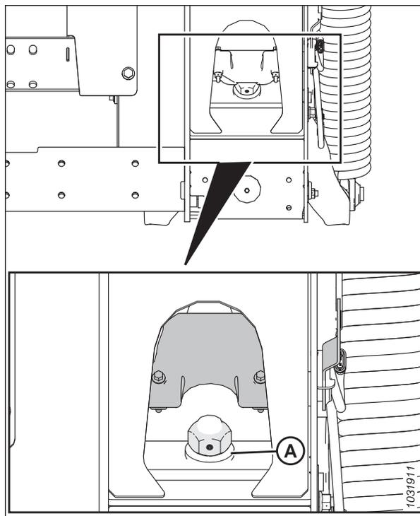
Figure 3.242: Verrouillage du flottement
