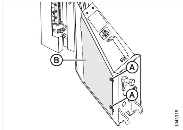
Figure 4.371: Remettre en place le couvercle
