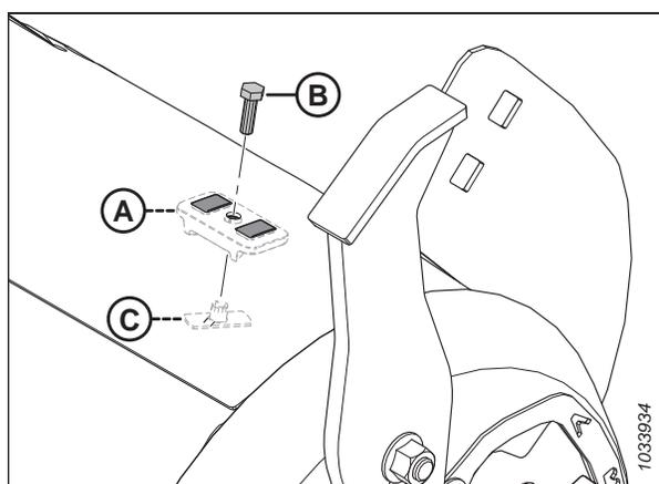
Figure 3.80: Installation du bouchon de fente
