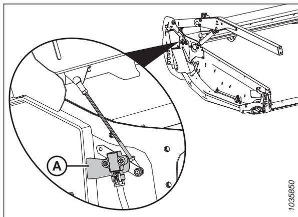
Figure 3.148: Emplacement du capteur de hauteur du rabatteur
