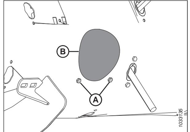
Figure 4.100: Couvercle d'accès au transporteur à vis
