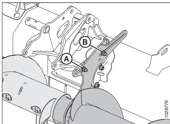
Figure 3.181: Position initiale des supports ajustables - Vis sans fin en trois parties
