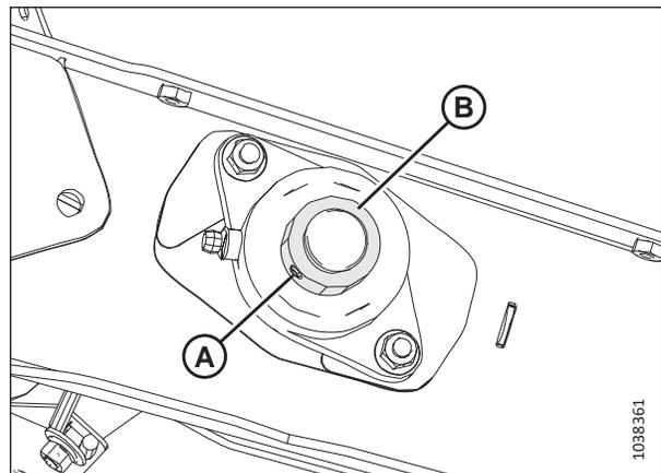
Figure 4.196: Roulement à rouleaux d'entraînement du tapis d'alimentation
