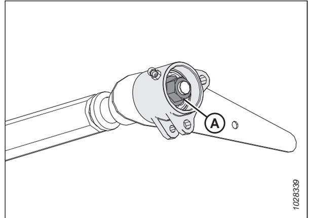
Figure 4.207: Roulement de rouleau libre gauche
