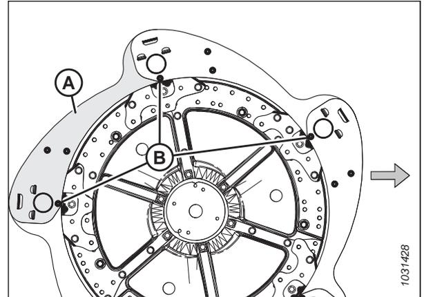
7. Retirez et retenez les deux vis (A), le déflecteur de came et les écrous du bouclier du rabatteur.
