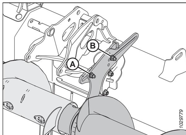
Figure 3.178: Position initiale des supports ajustables - Vis sans fin en trois parties
