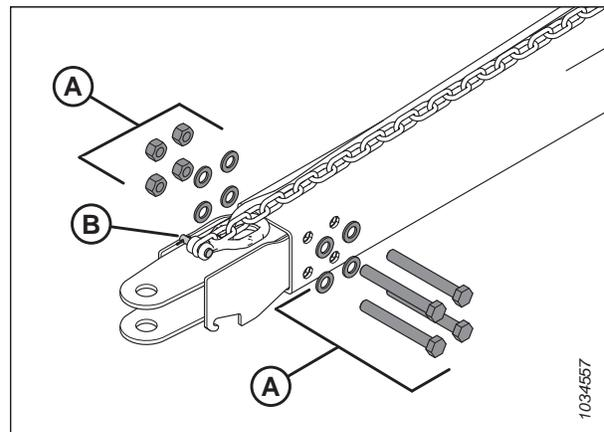
Figure 4.351: Installation de l'adaptateur d'anneau de chape
