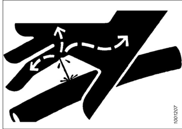
Figure 4.1: Risque lié à la pression hydraulique
