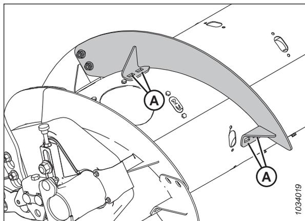
Figure 3.95: Spire sur le côté gauche du transporteur à vis
