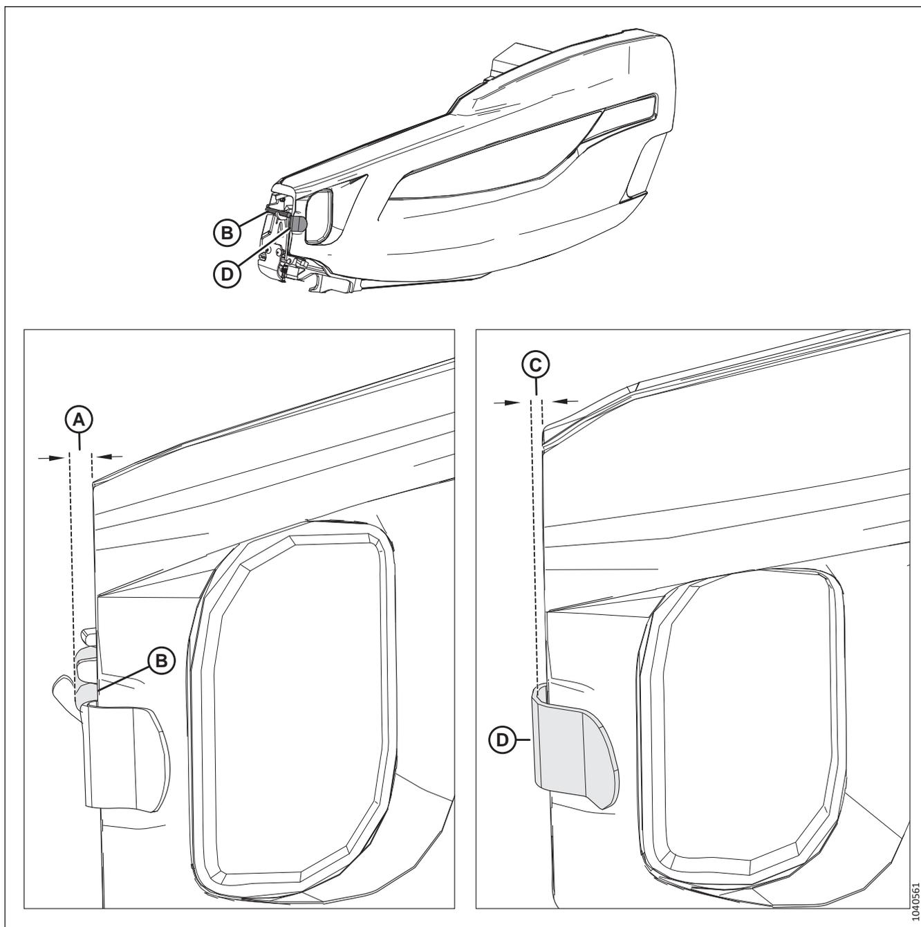
**Figure 3.17: Spécifications d'écartement à l'avant du capot**
