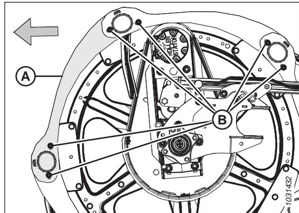
Figure 4.318: Boucliers des rabatteurs - Extrémité arrière intérieure
