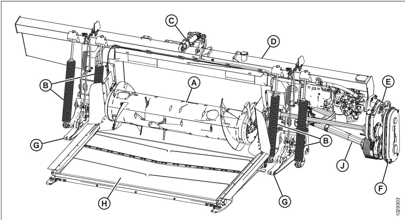
Figure 2.3: Côté plateforme du module de flottement FM200
