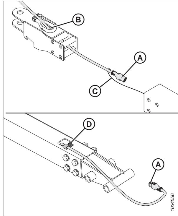
Figure 4.350: Installation de l'adaptateur d'anneau de chape
