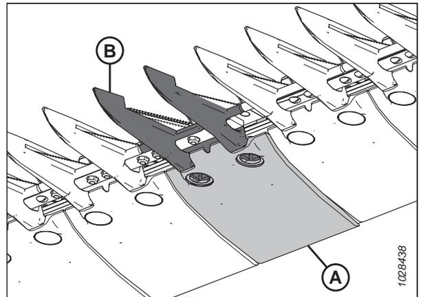
Figure 4.145: Doigt du couteau central pointu et plaque d'usure
