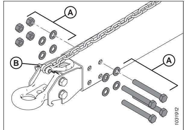
Figure 4.356: Installation de l'adaptateur pour anneau d'attelage
