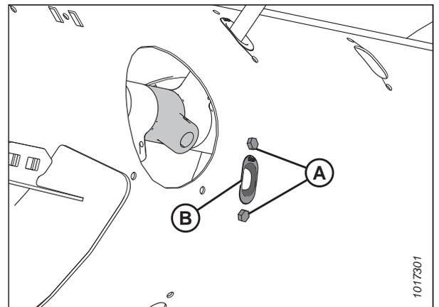
Figure 4.102: Trou du doigt de la vis
