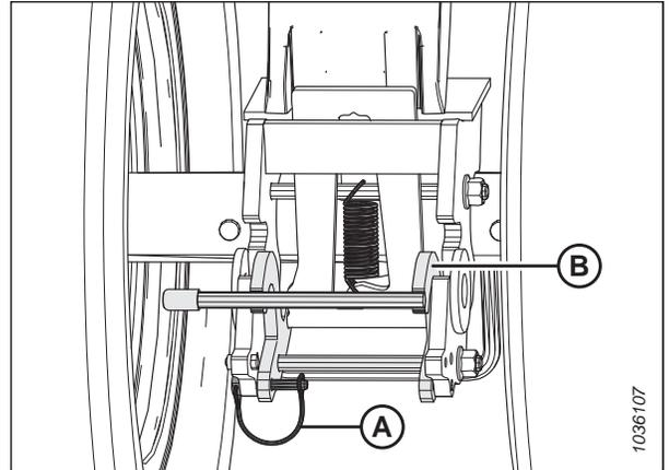
Figure 3.304: Roues de transport gauches – Loquet de verrouillage de rotation enclenché
