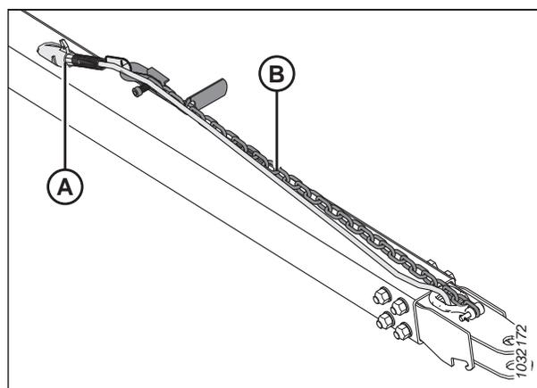
Figure 3.328: Harnais de câblage de la barre de remorquage
