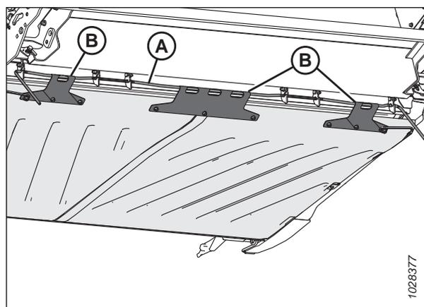
Figure 4.227: Dessous du bac du tablier d'alimentation
