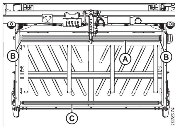
Figure 4.178: Tapis d'alimentation du module de flottement
