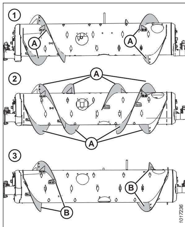
Figure 3.67: Configurations de la vis d'alimentation – vue arrière
