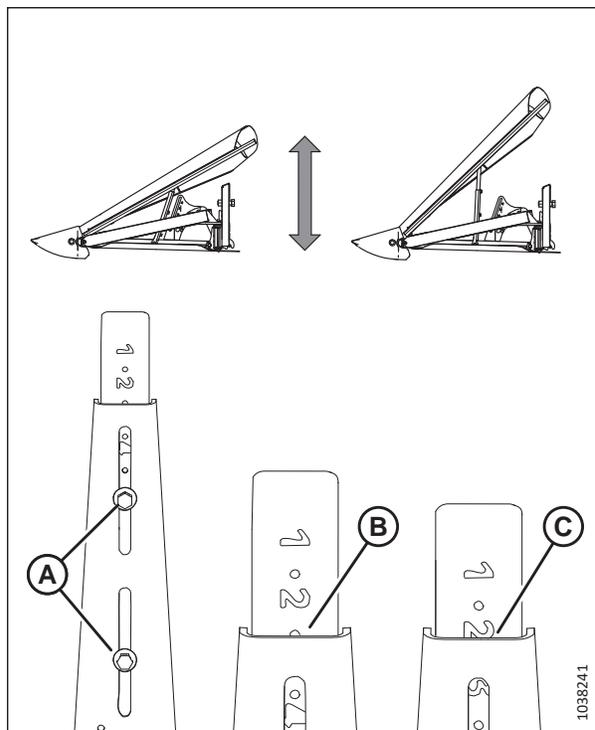
Figure 3.199: Réglage de la hauteur du déflecteur supérieur
