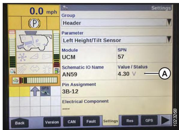
Figure 3.226: Afficheur de la moissonneuse-batteuse Case IH
