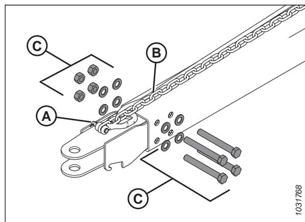
Figure 4.353: Démontage de l'adaptateur de chape
