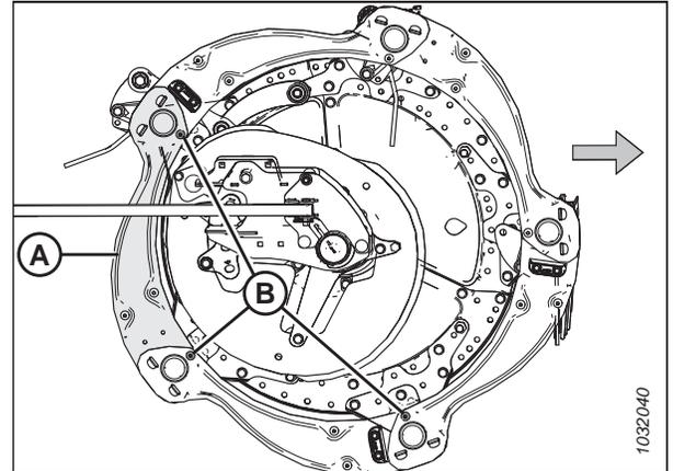
Figure 4.306: Boucliers des rabatteurs - Extrémité de came extérieure
