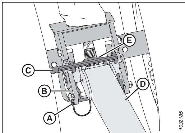
Figure 3.324: Extension de la barre de remorquage au pivot de transport gauche
