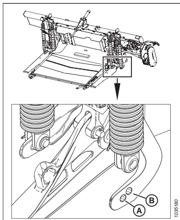
Figure 3.132: Ressort de flottement gauche installé dans le trou avant du levier de flottement
