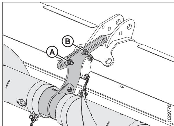
Figure 3.177: Position initiale des supports réglables - Vis en deux parties
