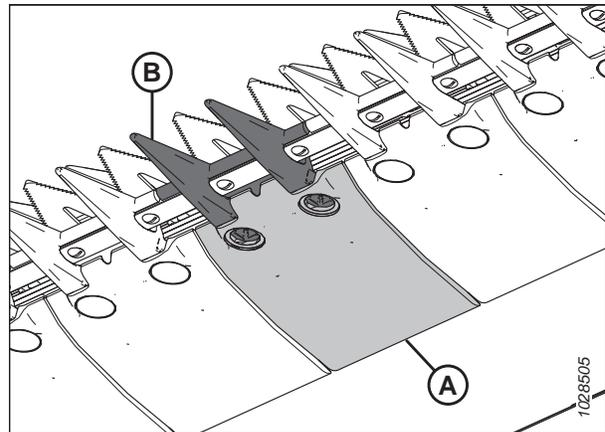
Figure 4.163: Doigt du couteau central et plaque d'usure
