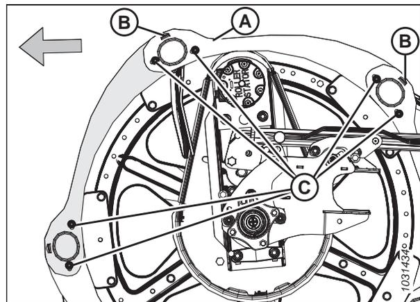
Figure 4.323: Boucliers des rabatteurs - Extrémité arrière intérieure
