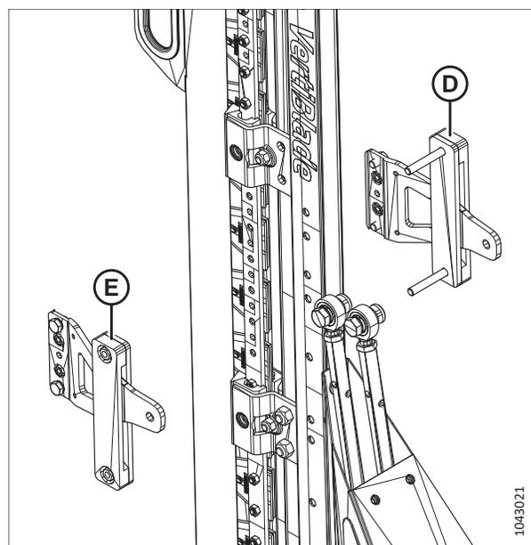
Figure 4.372: Remettre les têtes de couteau en place
