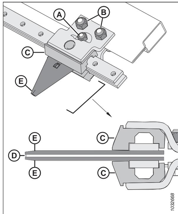
Figure 4.362: Écart entre le clip et la section de couteau
