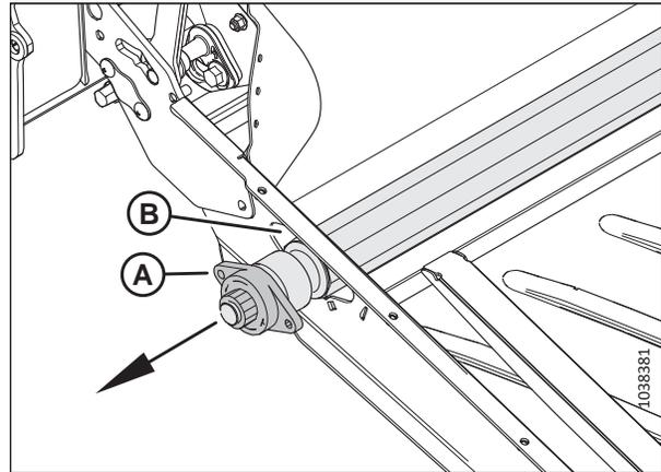
Figure 4.192: Rouleau d'entraînement – extrémité du roulement
