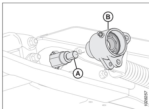
Figure 4.219: Roulement à rouleaux libres (côté gauche)
