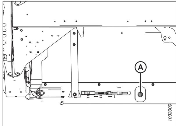
Figure 4.248: Tendeur - Côté gauche illustré
