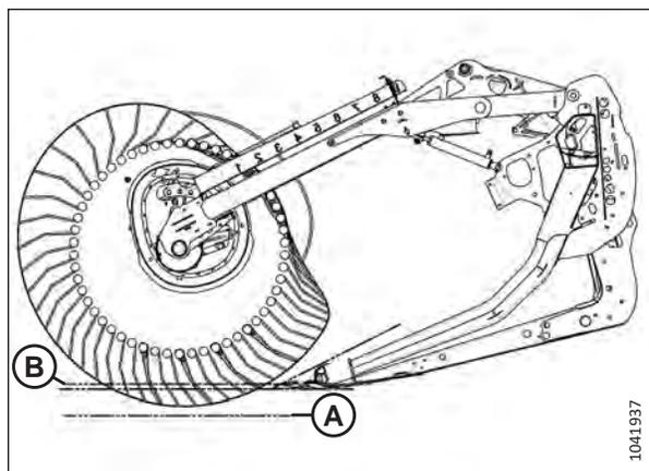
Figure 3.173: Profil des doigts – Came en position 4, angle de la plateforme au maximum
