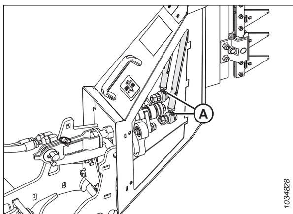
Figure 4.365: Graissage des embouts sur les tiges-poussoirs des couteaux verticaux
