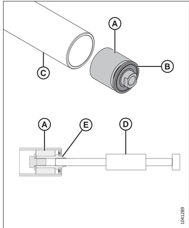
Figure 4.251: Roulement du rouleau libre et joint
