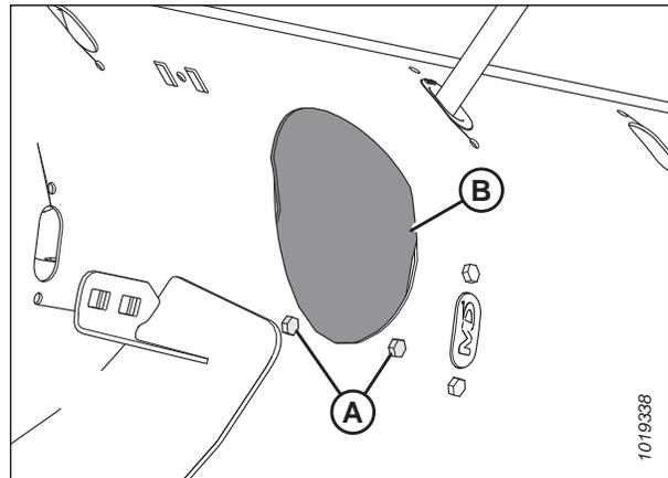
Figure 4.104: Couvercle d'accès au transporteur à vis
