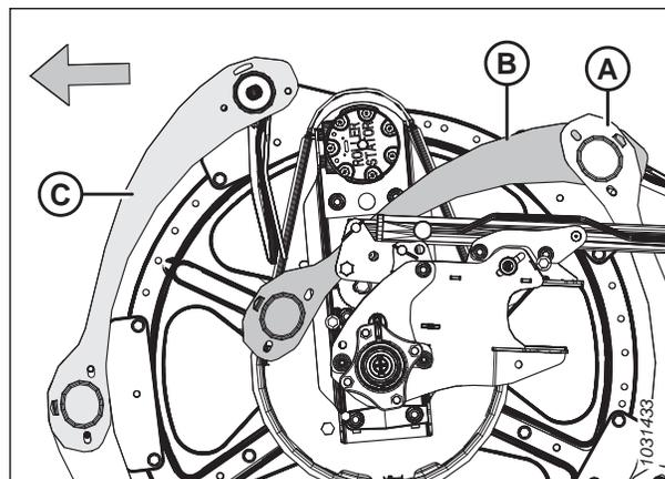
Figure 4.319: Boucliers des rabatteurs - Extrémité arrière intérieure
