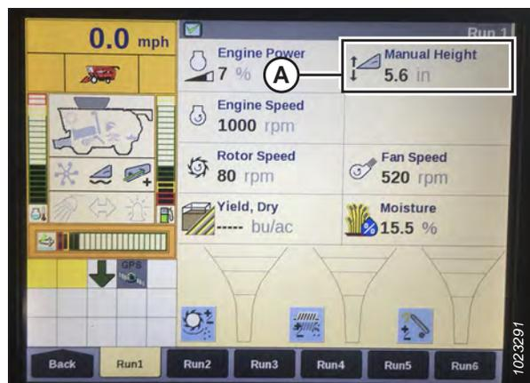
Figure 3.238: Écran de la plateforme Case – Page RUN 1 (exécuter 1)
