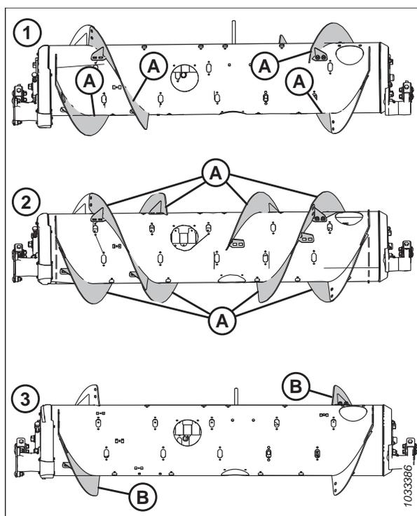
Figure 3.73: Configurations de la vis d'alimentation – vue arrière
