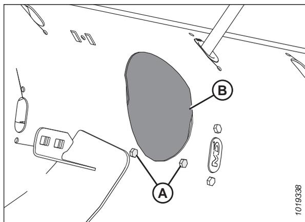
Figure 3.101: Couvercle d'accès au transporteur à vis
