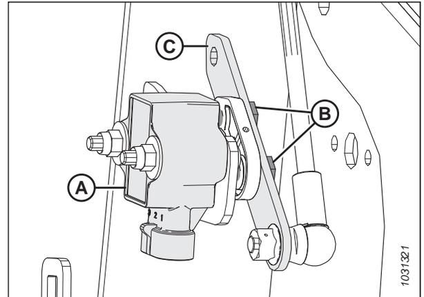
Figure 3.152: Capteur de hauteur du rabatteur – Bras droit du rabatteur
