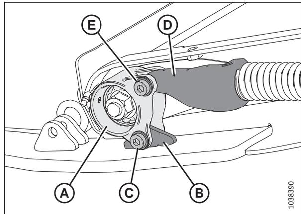
Figure 4.212: Roulement de rouleau libre gauche
