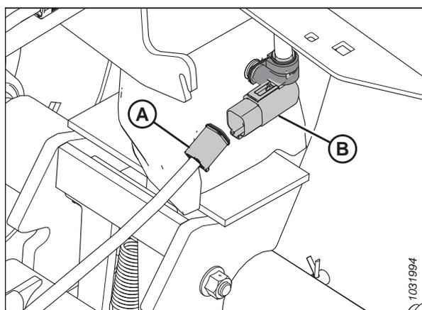
Figure 3.325: Connexion électrique de la barre de remorquage
