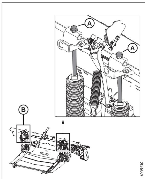
Figure 3.134: Réglage du flottement – côté gauche
