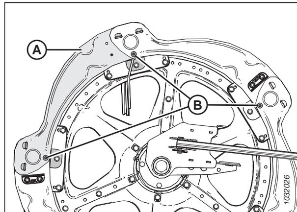
Figure 4.314: Boucliers des rabatteurs - Extrémité arrière extérieure
