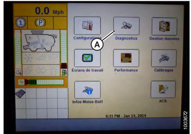
Figure 3.244: Afficheur de la moissonneuse-batteuse Case IH
