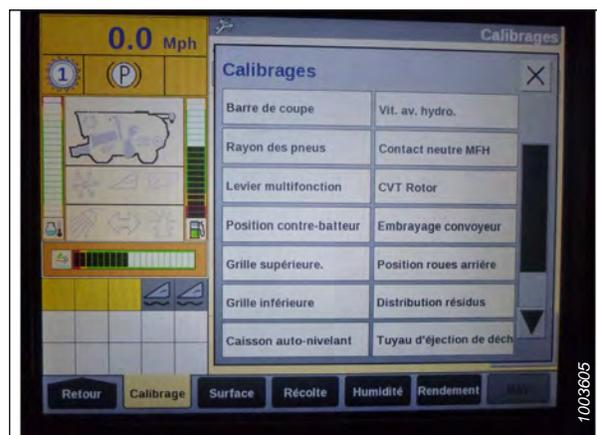
Figure 3.266: Afficheur de la moissonneuse-batteuse Case IH
