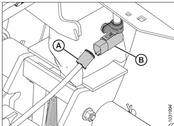
Figure 3.330: Connexion électrique de la barre de remorquage
