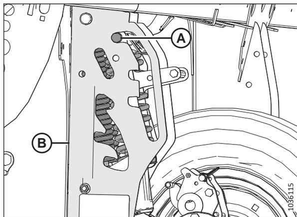
Figure 3.307: Goupille pivotante des roues de transport gauches dans la position de rangement la plus haute
