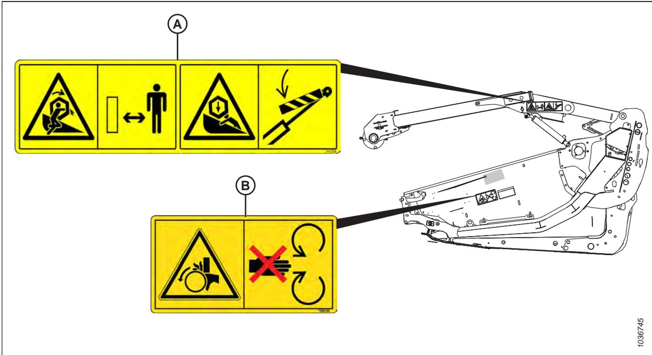
Figure 1.20: Bras de rabatteur et plateaux d'extrémité
