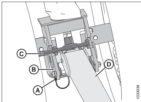
Figure 3.293: Extension de la barre de remorquage et du pivot de transport
