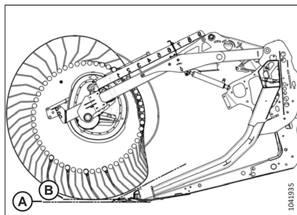
Figure 3.170: Profil des doigts – Position 2 de la came
