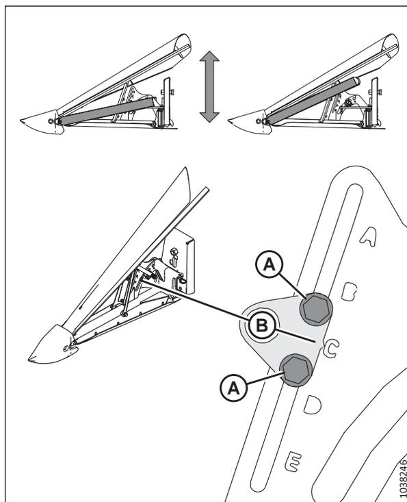
Figure 3.200: Réglage de la hauteur du déflecteur latéral
