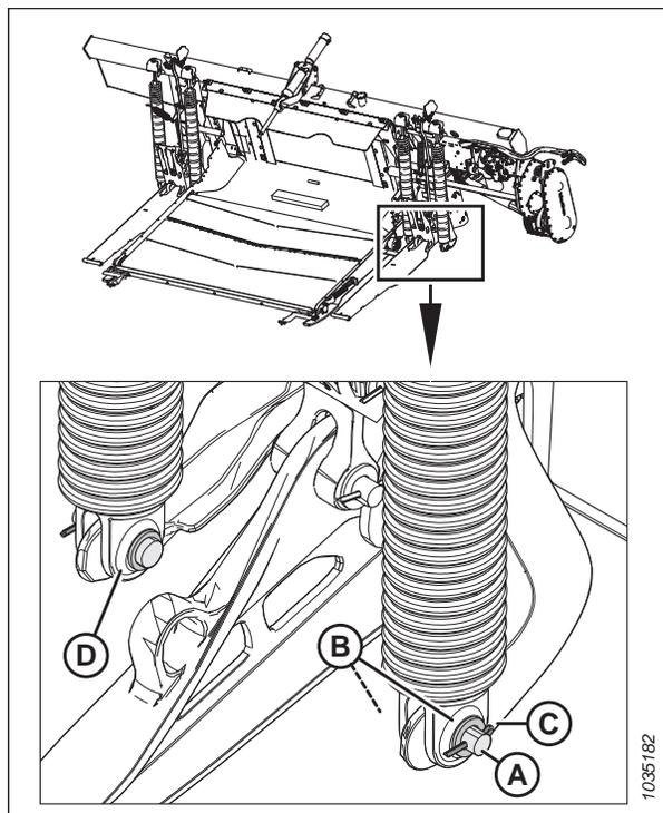
Figure 3.133: Ressort de flottement gauche – Installé dans le trou arrière du levier de flottement
