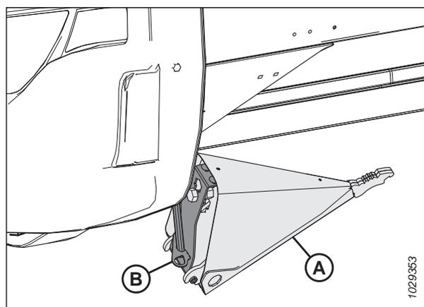
Figure 3.185: Stockage optionnel des diviseurs de récoltes
