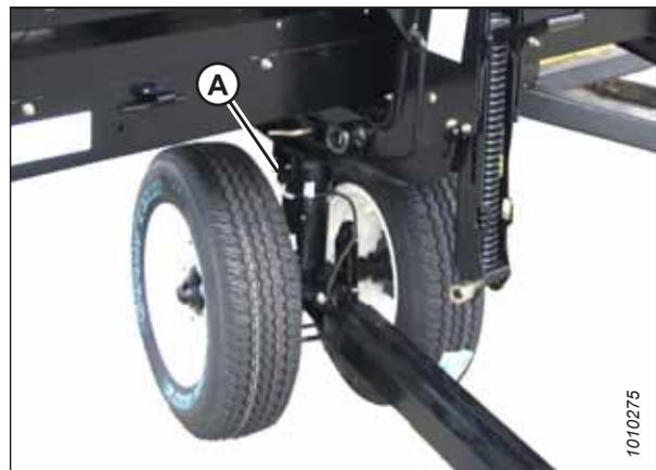
Figure 3.89: Raccordement du faisceau
