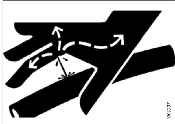
Figure 5.3: Risque lié à la pression hydraulique
