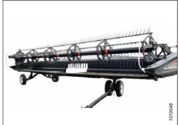
Figure 6.15: Roues stabilisatrices et transport
