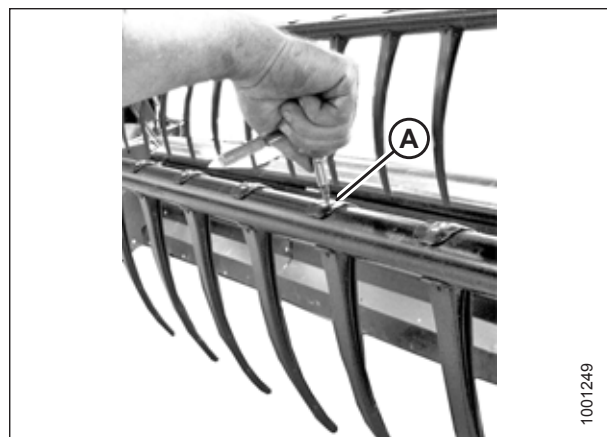
Figure 5.179: Installation des doigts en plastique
