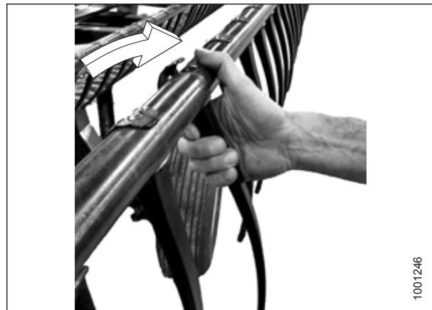
Figure 5.178: Installation des doigts en plastique
