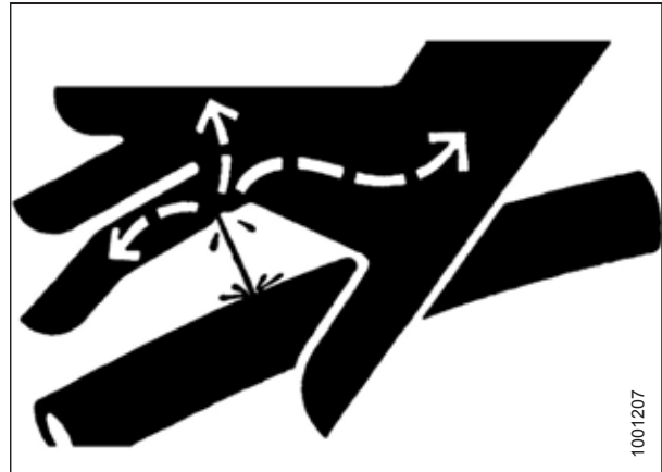
Figure 5.3: Risque lié à la pression hydraulique
