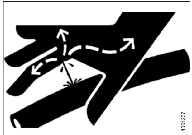
Figure 1.12: Risque lié à la pression hydraulique
