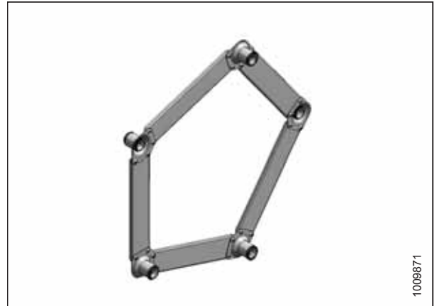
Figure 6.5: Kit de renforcement des rabatteurs à cinq lames représenté – similaire au kit renforcement des rabatteurs à six lames
