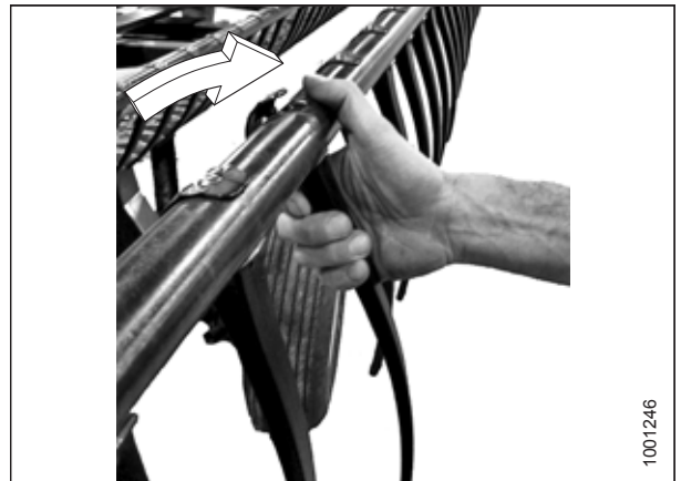
Figure 5.169: Installation des doigts en plastique
