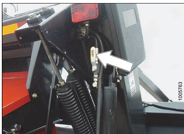
Рисунок 3.141: Стопорный клапан подъемного цилиндра
