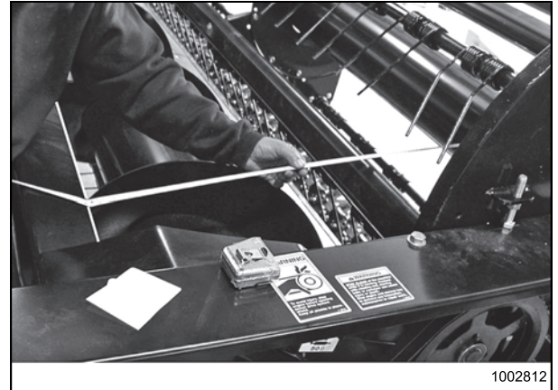
Рисунок 3.76: Горизонтальный вынос мотовила
