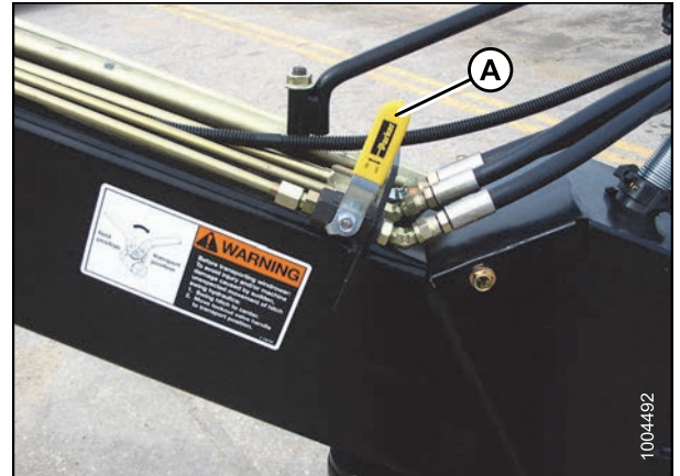
Рисунок 3.104: Блокирующий клапан рулевого управления
