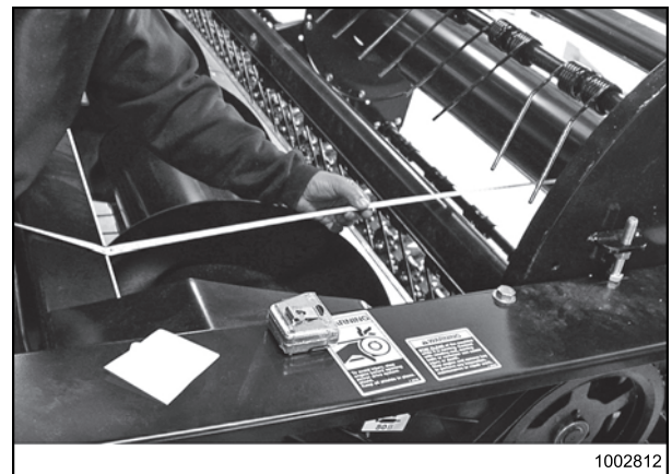
Рисунок 4.88: Горизонтальный вынос мотовила
