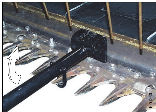
Рисунок 6.33: Наконечник противорезающего пальца — регулировка смещением вверх
