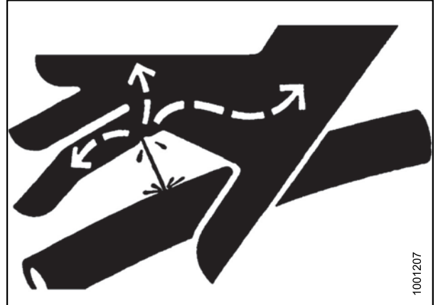
Рисунок 6.19: Опасное давление гидравлической жидкости
