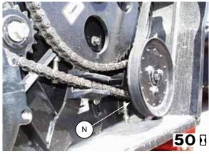
AUGER DRIVE JACKSHAFT BEARINGS
