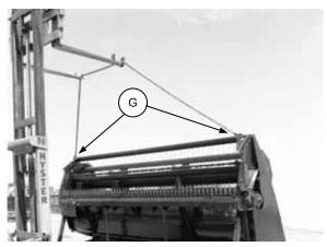
ATTACH CHAIN & LOWER ONTO BLOCKS
