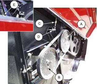
CHANGING REEL SPEED 66 rpm CONFIGURATION SHOWN
