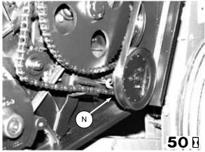
AUGER DRIVE JACKSHAFT BEARINGS
