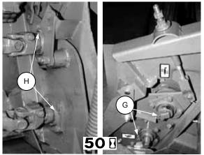
LEFT SIDE RIGHT SIDE ROLL SHAFT BEARINGS
