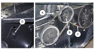
REEL DRIVE CHAIN TENSION ADJUST
