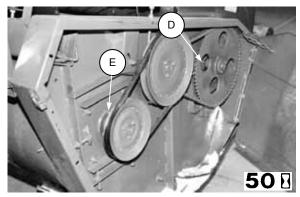
REEL AND AUGER BEARINGS - RIGHT SIDE
