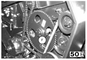
AUGER SHAFT BEARING - LEFT SIDE
