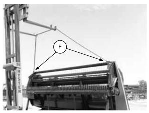
ATTACH CHAIN & LOWER ONTO BLOCKS
