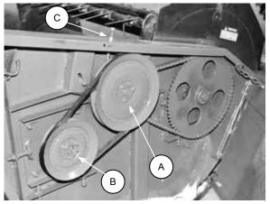
CHANGING REEL SPEED 53 rpm CONFIGURATION SHOWN
