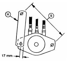
ORIENTATION OF TORQUE ARM TO MOTOR
