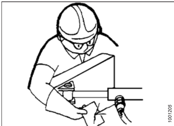
Figure 1.11: Kontrola výskytu netěsností v hydraulice
