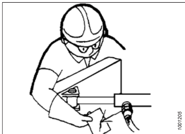
Figure 4.2: Kontrola výskytu netěsností v hydraulice
