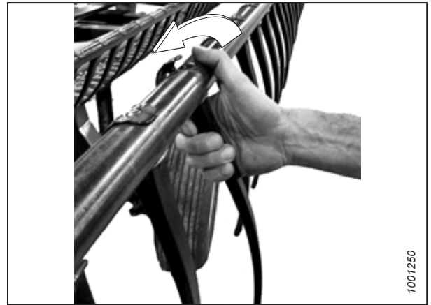
Figure 4.295: Demontáž plastového prstu
