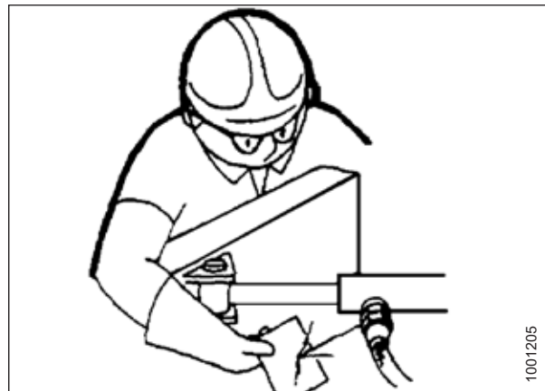
Obrázek 1.11: Kontrola výskytu netěsností v hydraulice
