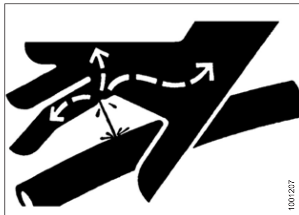
Obrázek 1.12: Nebezpečí tlaku v hydraulice
