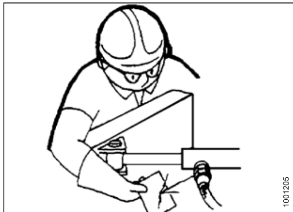
Rysunek 1.11: Próba szczelności elementów hydraulicznych
