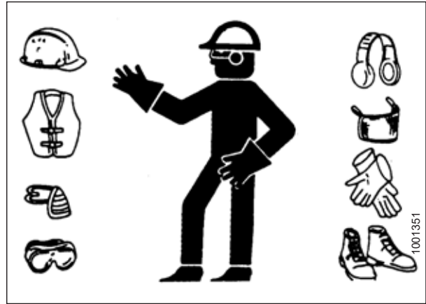
Rysunek 3.39: Urządzenia zabezpieczające
