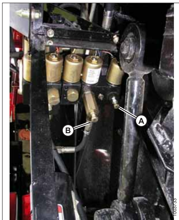
Rysunek 3.623: Regulowane ograniczniki podnoszenia i opuszczania hedera
