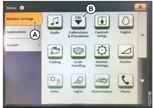
Rysunek 3.795: Wyświetlacz kombajnu John Deere S700 — ustawienia maszyny
