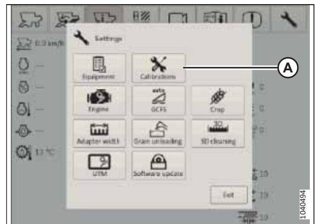
Rysunek 3.896: Menu ustawień — przycisk kalibracji
