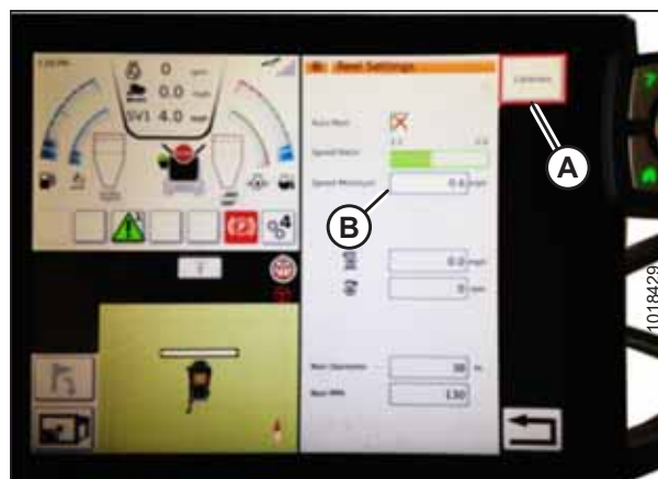
Rysunek 3.641: Kalibracja ustawień nagarniacza
