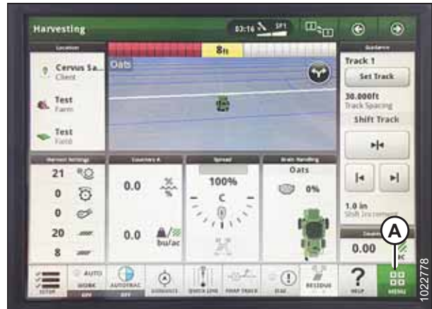
Rysunek 3.781: Wyświetlacz kombajnu John Deere S700 — strona Harvesting (Zbiór)
