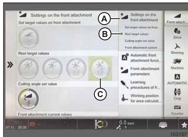
Rysunek 3.606: Strona Settings on Front Attachment (Ustawienia osprzętu przedniego)
