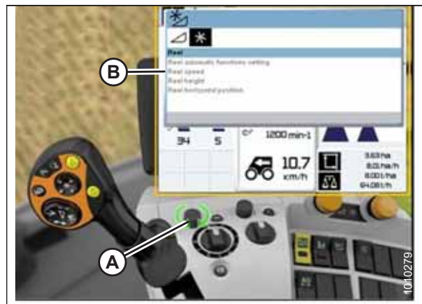
Rysunek 3.575: Wyświetlacz, konsola i drążek sterujący kombajnu CLAAS Lexion
