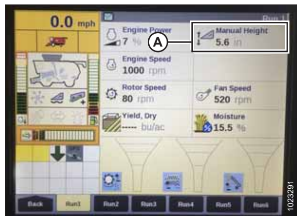
Rysunek 3.478: Wyświetlacz kombajnu Case — strona Run 1 (Przebieg 1)
