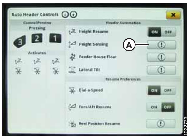
Rysunek 3.777: Wyświetlacz kombajnu John Deere S700 — elementy automatycznego sterowania hederem
