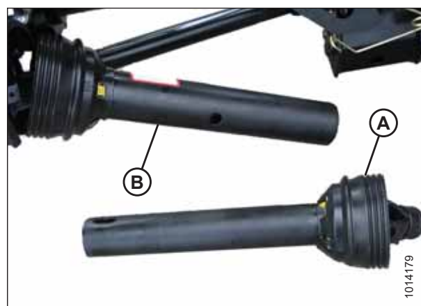
Rysunek 4.54: Rozłączony układ przeniesienia napędu
