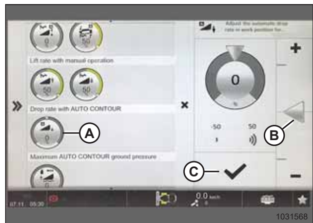
Rysunek 3.604: Strona Drop Rate with Auto Contour (Prędkość opadania z automatycznym śledzeniem terenu)
