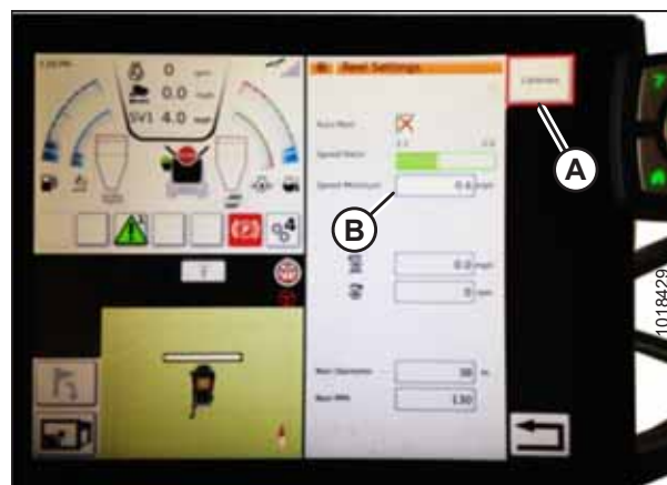
Rysunek 3.678: Kalibracja ustawień nagarniacza
