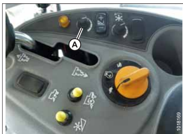
Rysunek 3.534: Pokrętło regulacji wysokości na konsoli sterowania kombajnu
