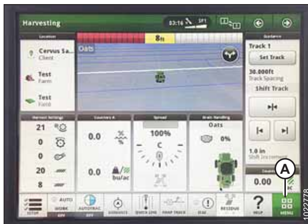
Rysunek 3.785: Wyświetlacz kombajnu John Deere S700 — strona Harvesting (Zbiór)
