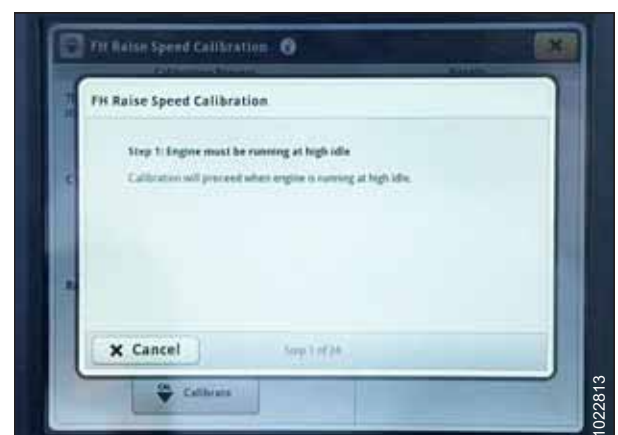
Rysunek 3.790: Wyświetlacz kombajnu John Deere S700 — kalibracja przenośnika pochyłego
