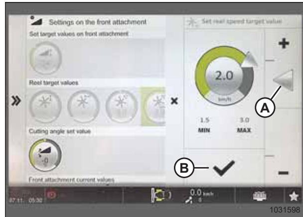
Rysunek 3.607: Strona Reel Speed Target Value (Wartość docelowa prędkości nagarniacza)
