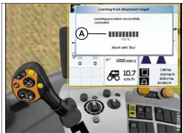
Rysunek 3.584: Wyświetlacz, konsola i drążek sterujący kombajnu CLAAS Lexion
