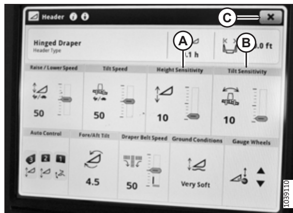
Rysunek 3.805: Wyświetlacz CommandCenter™ — strona Header (Heder)
