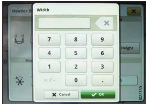
Rysunek 3.772: Wyświetlacz kombajnu John Deere S700 — ustawianie szerokości hedera
