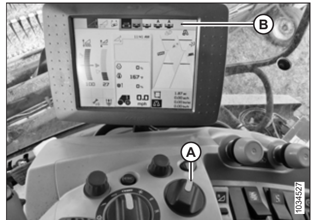
Rysunek 3.65: Położenie przełącznika HOTKEY do sterowania prędkością taśmy
