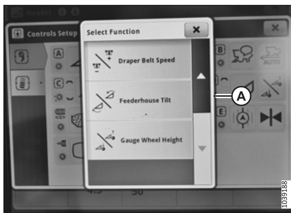
Rysunek 3.80: Wyświetlacz kombajnu John Deere X9 — Controls Setup (Konfiguracja elementów sterujących)
