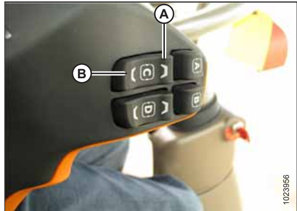
Rysunek 3.336: Sterowanie nachyleniem przenośnika pochylego John Deere 700 w osi przód-tył
