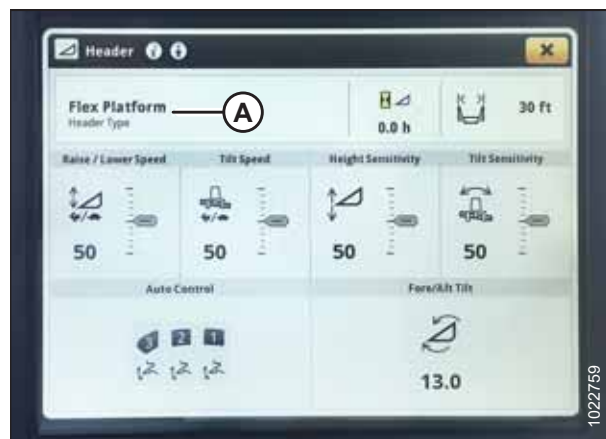
Rysunek 3.770: Wyświetlacz kombajnu John Deere S700 — strona Header (Heder)
