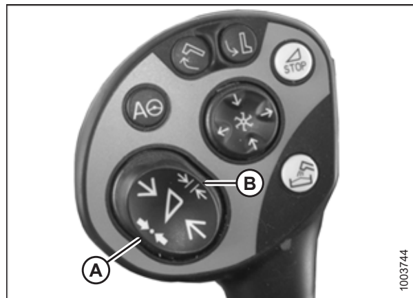
Rysunek 3.561: Przyciski na drążku sterującym kombajnu CLASS Lexion
