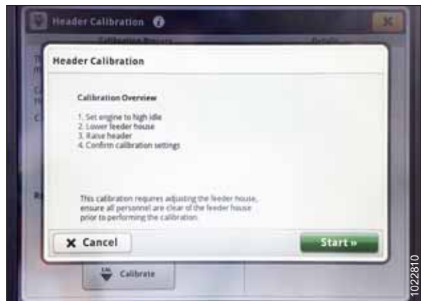
Rysunek 3.799: Wyświetlacz kombajnu John Deere S700 — kalibracja hedera
