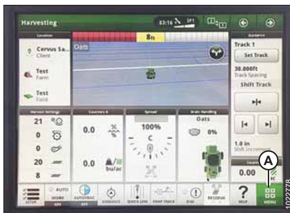
Rysunek 3.794: Wyświetlacz kombajnu John Deere S700 — strona Harvesting (Zbiór)
