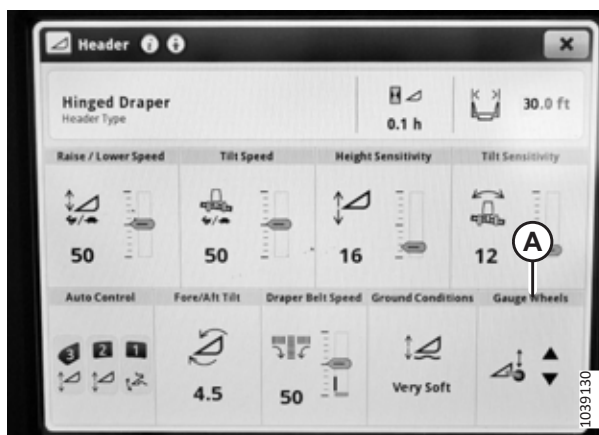
Rysunek 3.825: Wyświetlacz kombajnu John Deere — strona Header (Heder)
