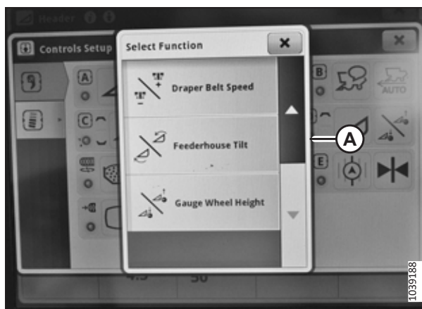
Rysunek 3.76: Wyświetlacz kombajnu John Deere X9 — Controls Setup (Konfiguracja elementów sterujących)
