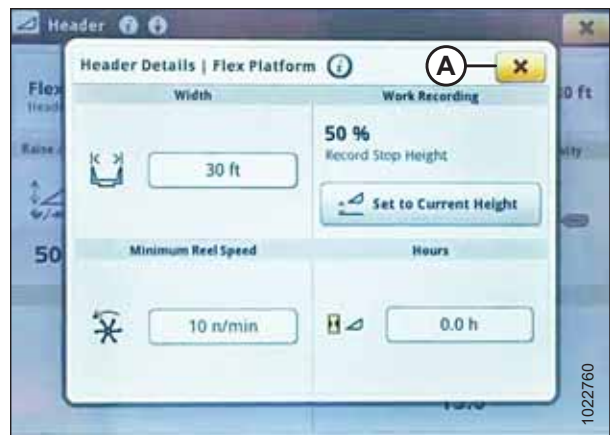
Rysunek 3.773: Wyświetlacz kombajnu John Deere S700 — okno dialogowe Header Details (Szczegóły hedera)
