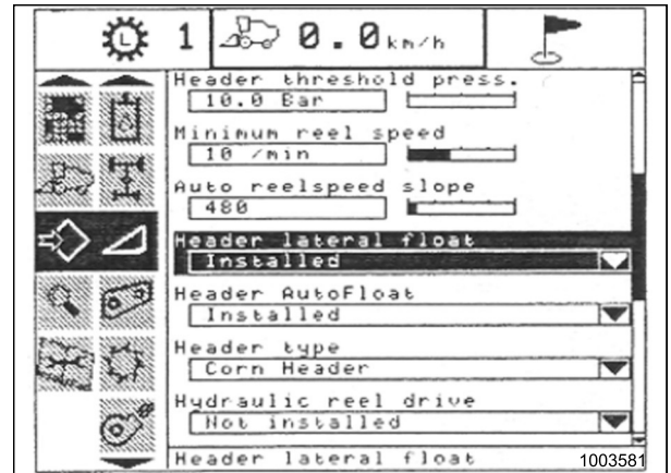
Рисунок 3.283: Дисплей комбайна New Holland
