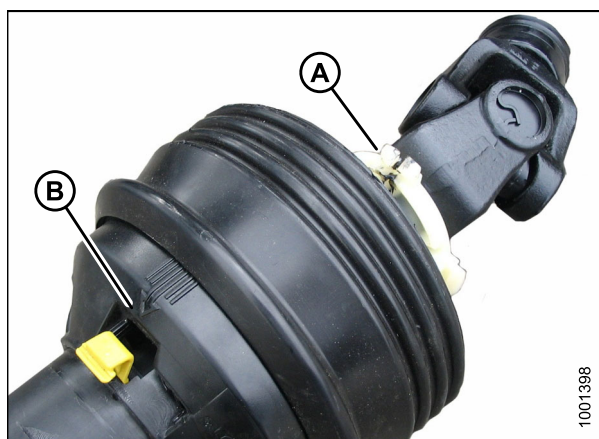
Рисунок 4.57: Кожух кардана привода жатки
