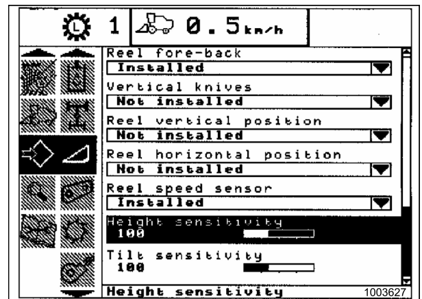
Рисунок 3.293: Дисплей комбайна New Holland
