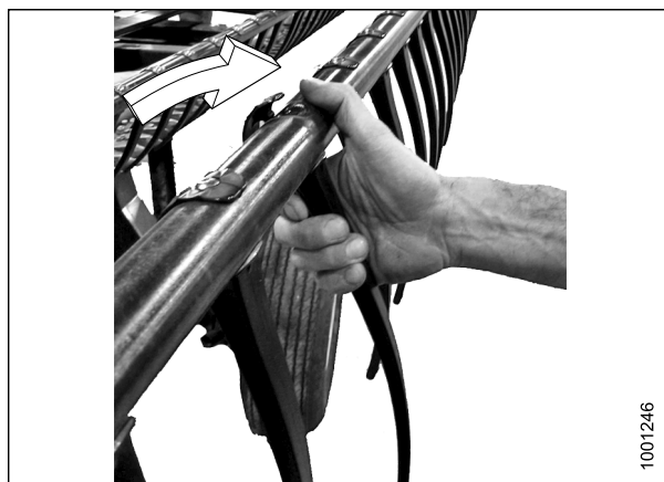
Рисунок 4.276: Установка пластмассового пальца
