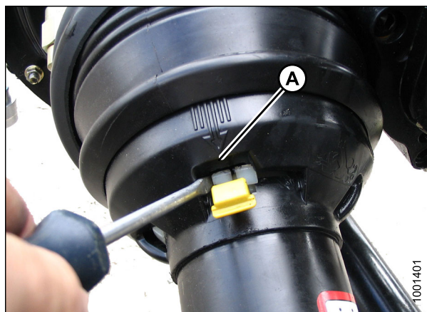
Рисунок 4.59: Кожух кардана привода жатки
