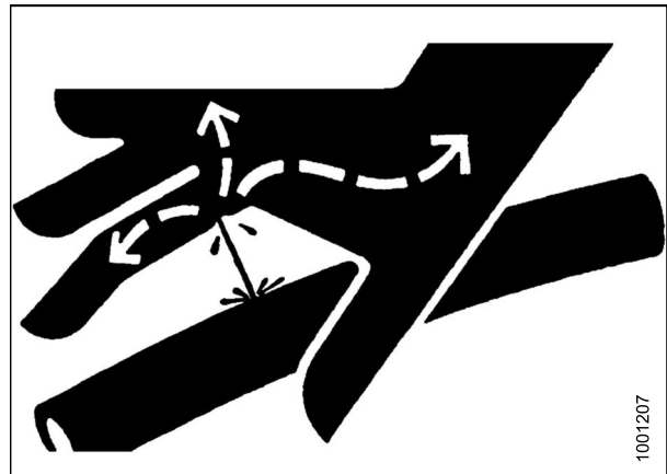
Рисунок 1.12: Опасное давление гидравлической жидкости
