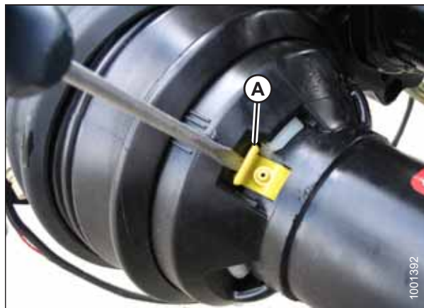
Figura 4.55: Apărătoarea liniei de transmisie
