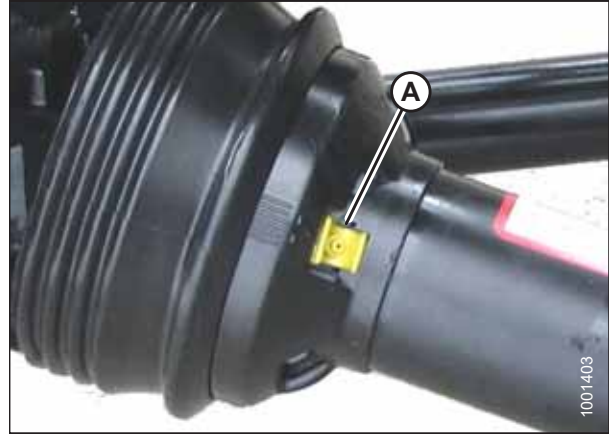
Figura 4.60: Apărătoarea liniei de transmisie
