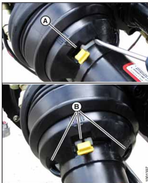
Figura 4.56: Apărătoarea liniei de transmisie
