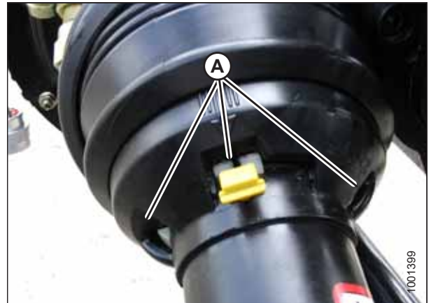
Figura 4.58: Apărătoarea liniei de transmisie
