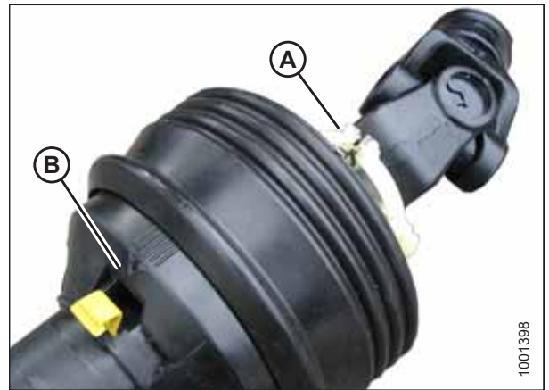
Figura 4.57: Apărătoarea liniei de transmisie
