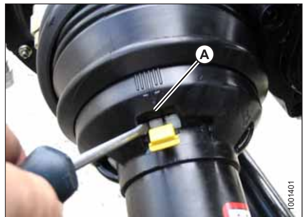
Figura 4.59: Apărătoarea liniei de transmisie
