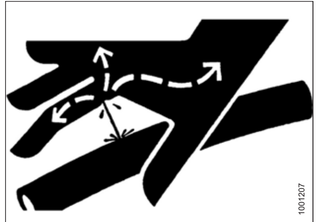
Ábra 4.1: Hidraulikus nyomás okozta veszély
