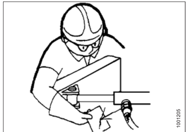
Ábra 4.2: Hidraulikus szivárgás ellenőrzése
