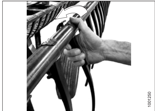
Ábra 4.275: Műanyag bedobóujj eltávolítása
