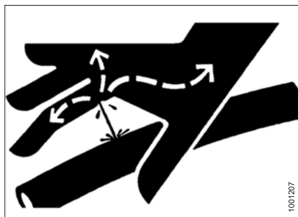
Ábra 1.12: Hidraulikus nyomás okozta veszély
