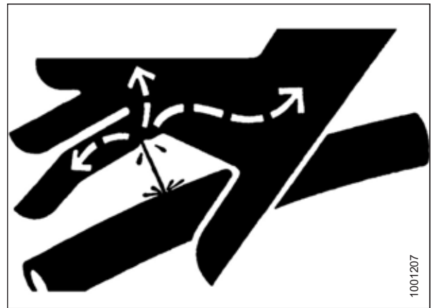
Ábra 1.12: Hidraulikus nyomás okozta veszély
