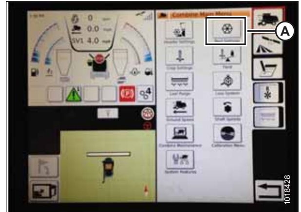
Figura 3.640: Setările rabatorului în meniul principal al combinei
