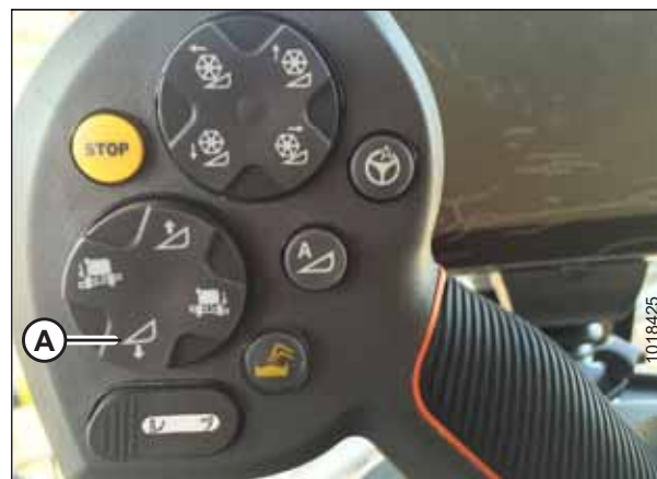
Figura 3.653: Comutator pentru heder în jos
