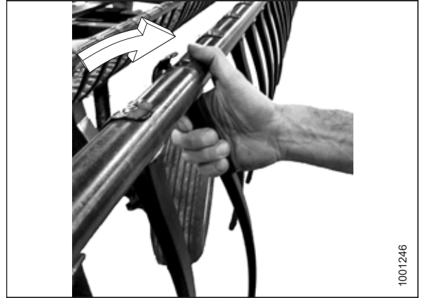
Figura 4.276: Montarea degetului din plastic
