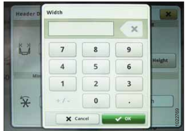
Figura 3.772: Afișajul John Deere S700 – Setarea lățimii hederului
