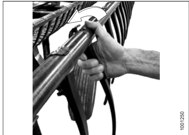
Figura 4.275: Demontarea degetului din plastic
