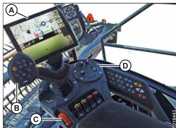
Figura 3.629: Stația operatorului – Gleaner® S9
