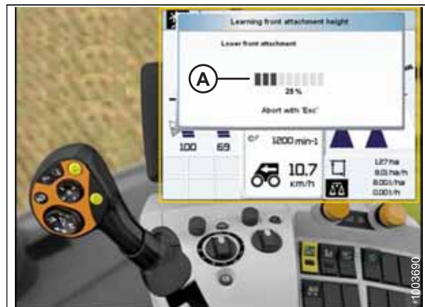
Figura 3.568: Afișajul, consola și maneta de comandă ale combinei CLAAS Lexion
