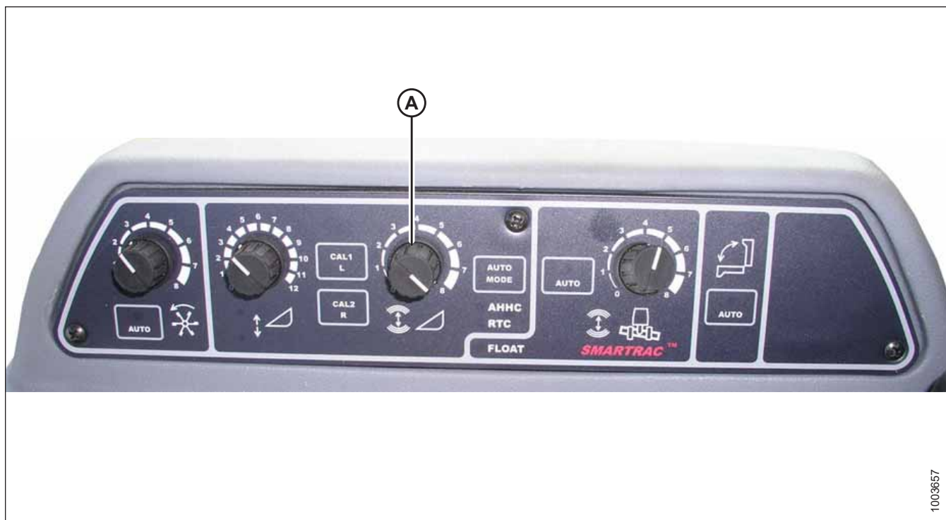
Figura 3.626: Consola de control automat al înălțimii hederului
