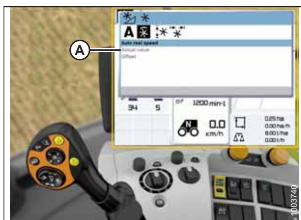
Figura 3.576: Afișajul, consola și maneta de comandă ale combinei CLAAS Lexion
