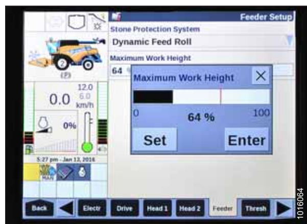
Figura 3.890: Afișajul combinei New Holland
