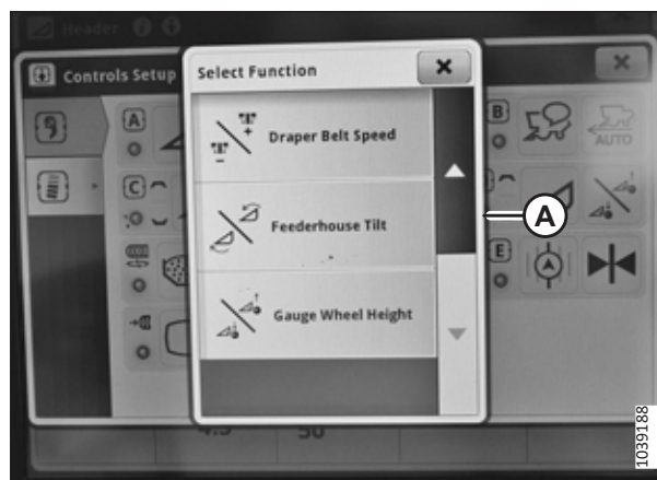
Figura 3.76: Afișajul John Deere X9 – Configurarea comenzilor
