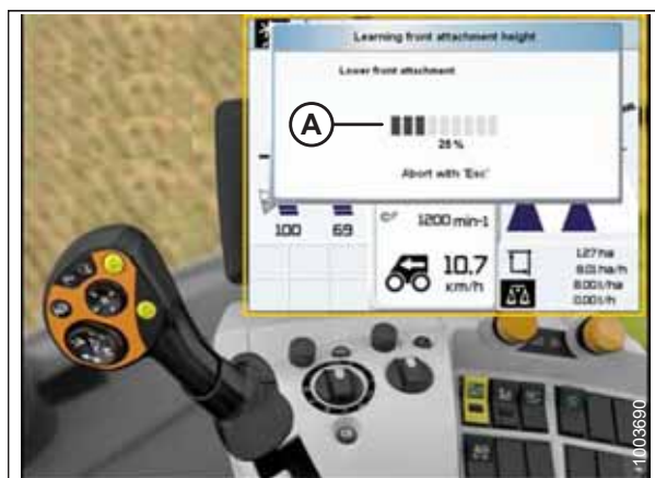
Figura 3.583: Afișajul, consola și maneta de comandă ale combinei CLAAS Lexion
