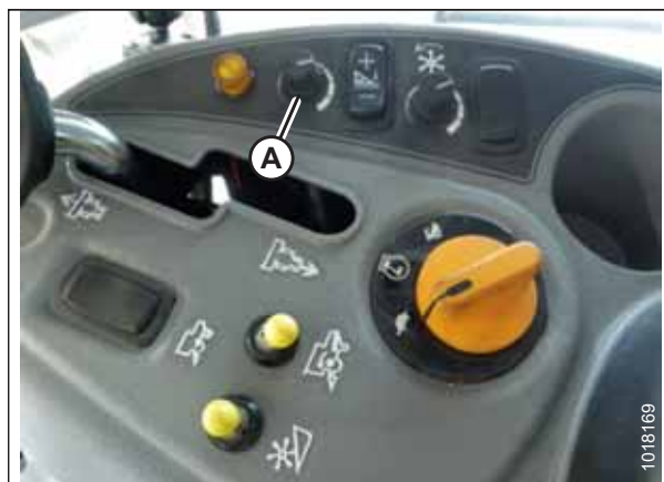
Figura 3.534: Butonul de reglare a înălțimii de pe consola de comandă a combinei
