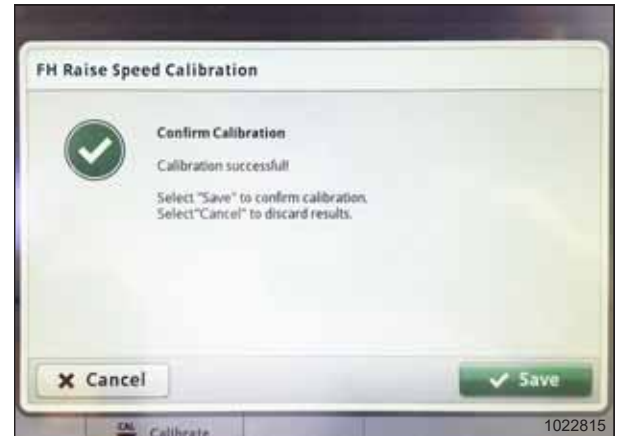
Figura 3.791: Afișajul John Deere S700 – Calibrarea carcasei alimentatorului
