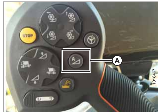
Figura 3.694: AHHC pe maneta de comandă
