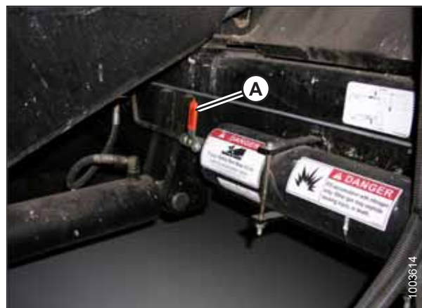
Figura 3.622: Comutatorul ON/OFF al acumulatorului combinei
