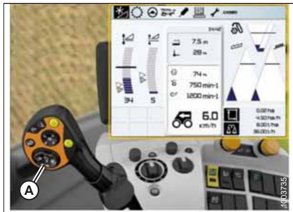
Figura 3.570: Afișajul, consola și maneta de comandă ale combinei CLAAS Lexion
