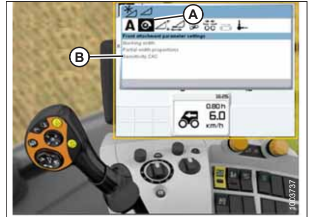
Figura 3.572: Afișajul, consola și maneta de comandă ale combinei CLAAS Lexion
