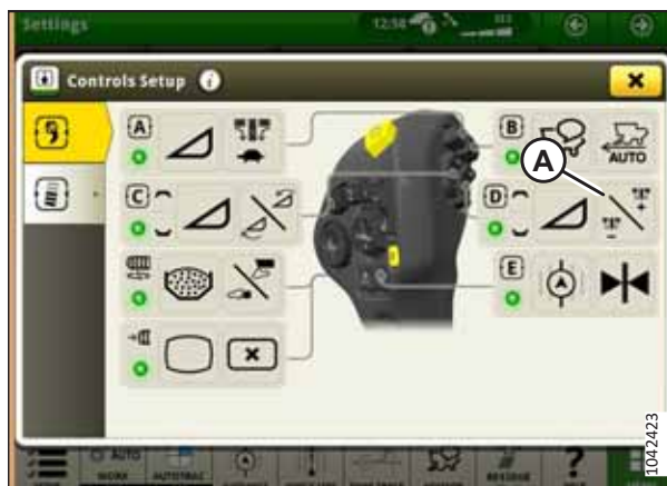
Figura 3.85: Afișajul John Deere X9 – Configurarea comenzilor
