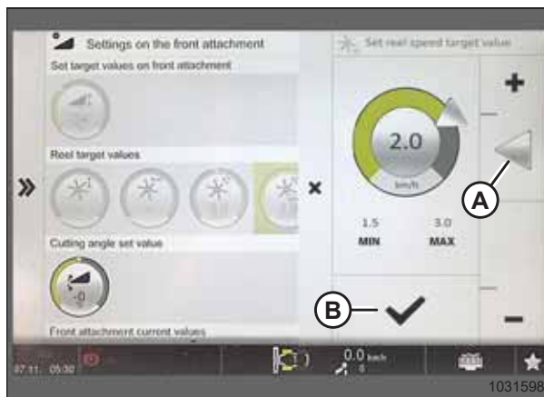
Figura 3.607: Pagina Valoarea țintă a turației rabatorului
