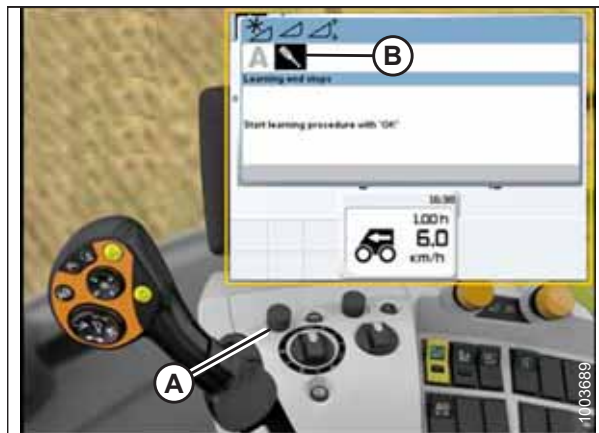
Figura 3.582: Afișajul, consola și maneta de comandă ale combinei CLAAS Lexion
