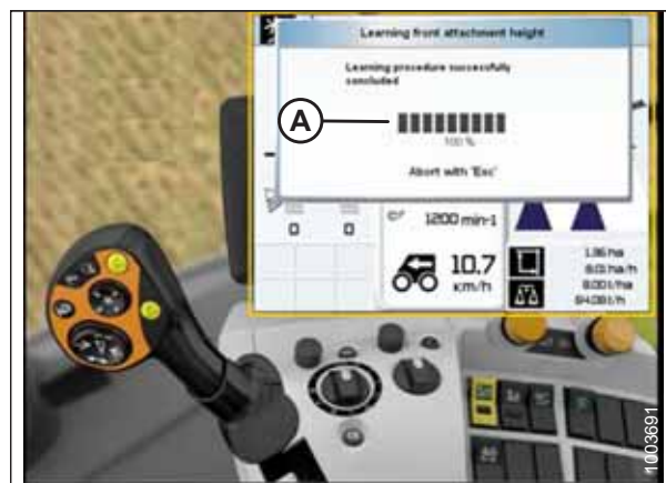
Figura 3.569: Afișajul, consola și maneta de comandă ale combinei CLAAS Lexion
