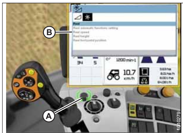
Figura 3.575: Afișajul, consola și maneta de comandă ale combinei CLAAS Lexion
