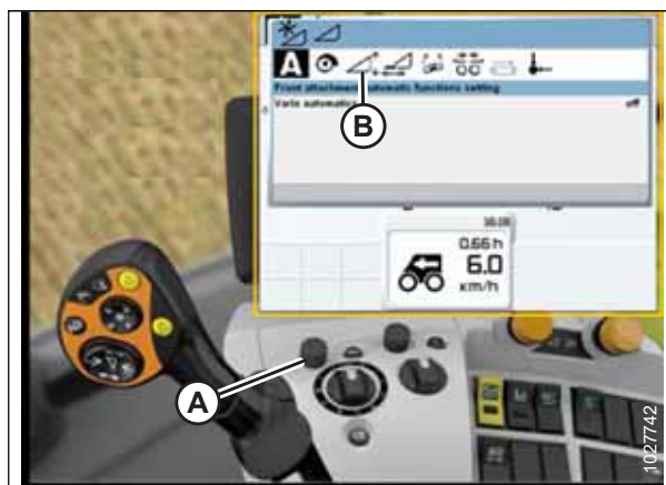
Figura 3.566: Afișajul, consola și maneta de comandă ale combinei CLAAS Lexion
