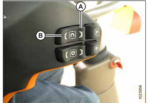
Figura 3.336: Comenzile de înclinare față-spate a carcasei alimentatorului John Deere 700
