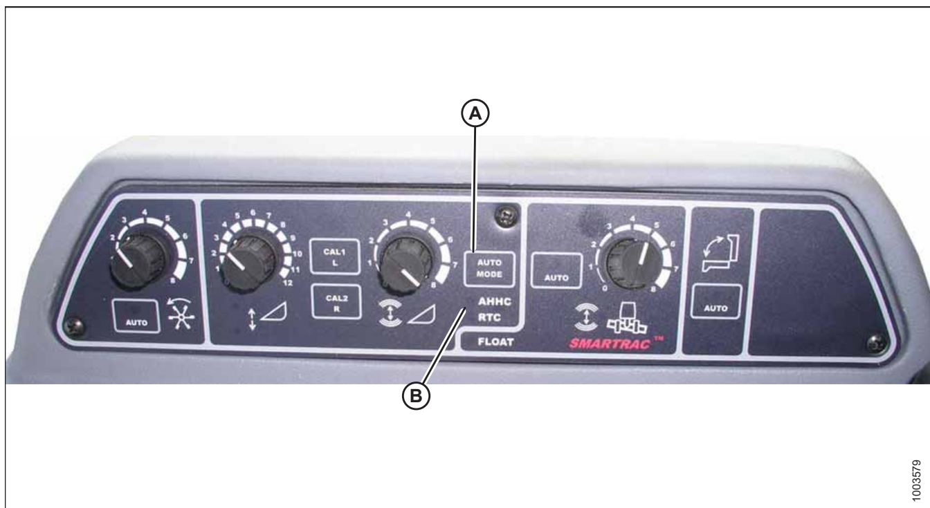
Figura 3.617: Comenzile controlului automat al înălțimii hederului
