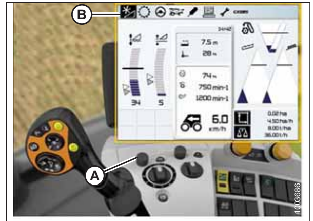
Figura 3.579: Afișajul, consola și maneta de comandă ale combinei CLAAS Lexion
