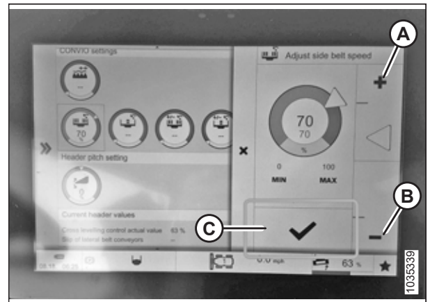
Figura 3.70: Selectarea vitezei transportorului cu bandă
