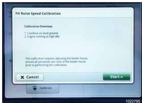
Figura 3.789: Afișajul John Deere S700 – Calibrarea carcsei alimentatorului
