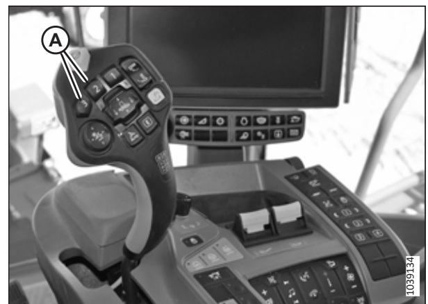
Figura 3.822: Maneta multifuncțională John Deere
