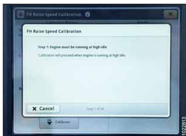
Figura 3.790: Afișajul John Deere S700 – Calibrarea carcsei alimentatorului
