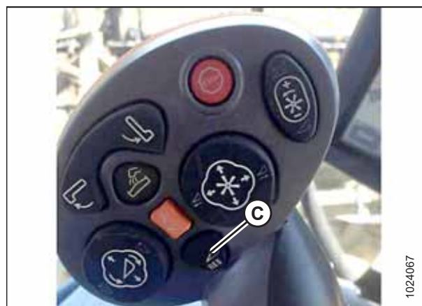
Figura 3.885: Maneta multifuncțională a combinei New Holland
