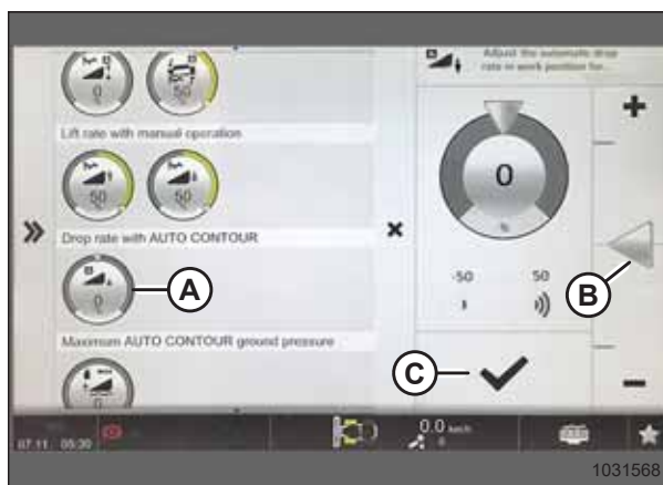
Figura 3.604: Pagina Rata de cădere cu contur automat
