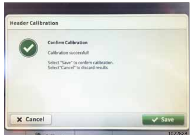
Figura 3.800: Afișajul John Deere S700 – Calibrare Heder
