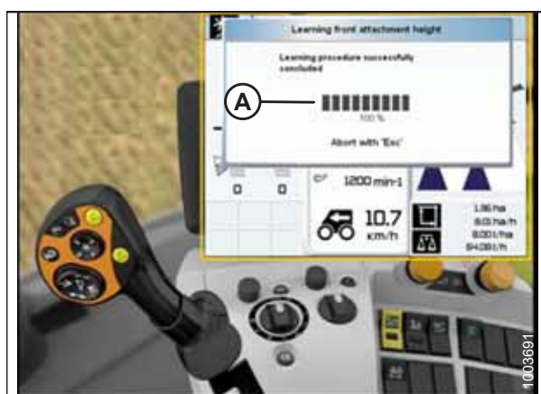
Figura 3.584: Afișajul, consola și maneta de comandă ale combinei CLAAS Lexion
