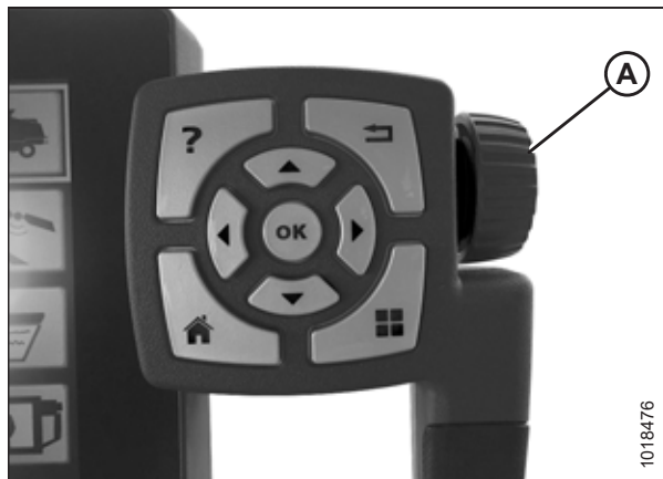
Figura 3.664: Roata de ajustare de pe partea dreaptă a terminalului Tyton
