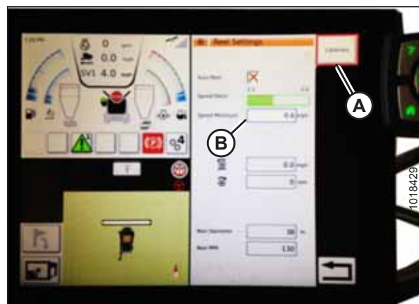
Figura 3.678: Calibrarea setărilor rabatorului
