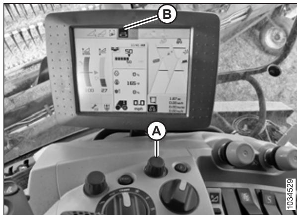
Figura 3.67: Pictograma pentru viteza transportorului cu bandă pe utilajele CLAAS mai vechi
