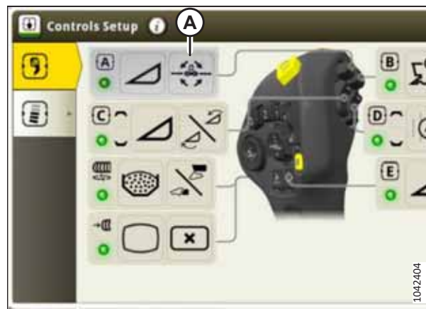
Figura 3.82: Afișajul John Deere X9 – Configurarea comenzilor
