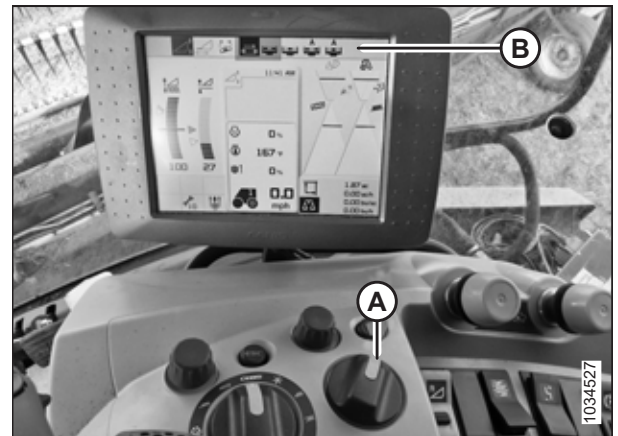
Figura 3.65: Poziția tastelor rapide pentru controlul vitezei transportorului cu bandă
