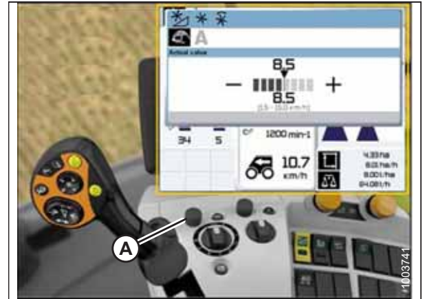
Figura 3.577: Afișajul, consola și maneta de comandă ale combinei CLAAS Lexion
