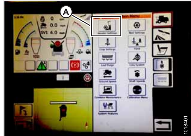
Figura 3.631: Setările hederului în meniul principal al combinei
