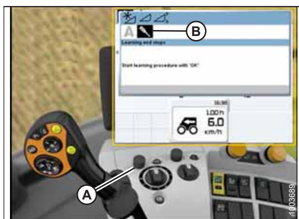
Figura 3.567: Afișajul, consola și maneta de comandă ale combinei CLAAS Lexion
