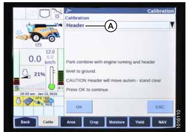
Figura 3.871: Afișajul combinei New Holland
