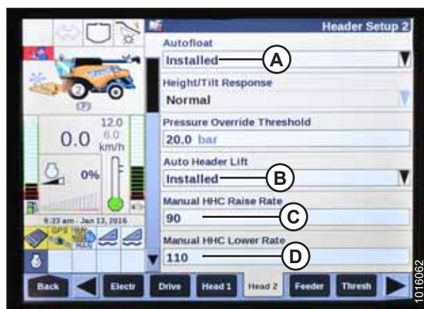
Figura 3.862: Afișajul combinei New Holland
