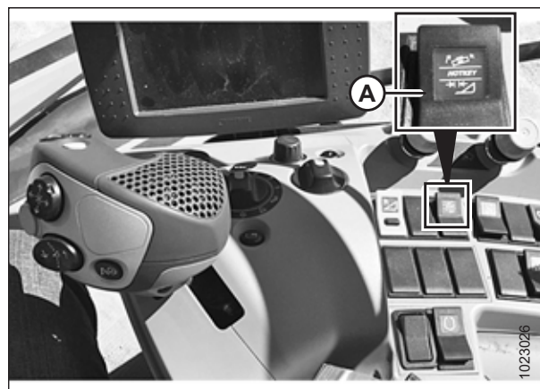
Figura 3.297: Comutatorul manetei multifuncționale
