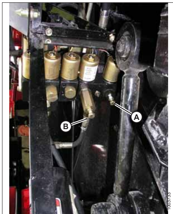
Figura 3.623: Restrictori reglabili pentru ridicarea și coborârea hederului
