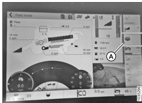
Figura 3.303: Pictograma Other Header Functions (Alte funcții ale hederului)
