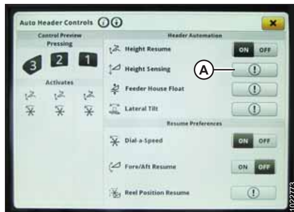
Figura 3.777: Afișajul John Deere S700 – Comenzile automate ale hederului
