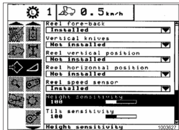
Figura 3.848: Afișajul combinei New Holland
