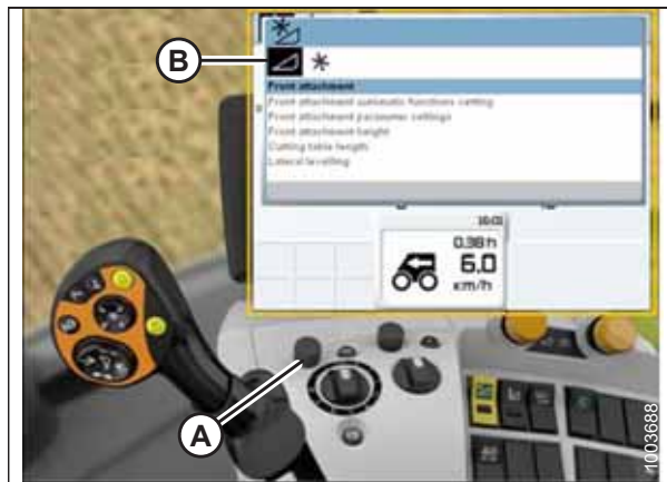
Figura 3.565: Afișajul, consola și maneta de comandă ale combinei CLAAS Lexion
