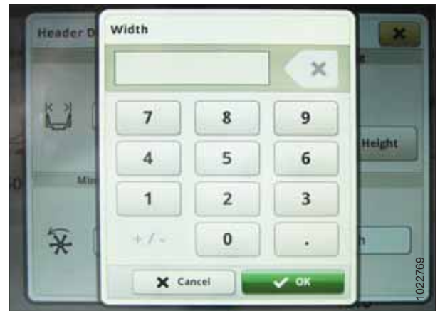
Ábra 3.772: John Deere S700 kijelző – A vágóasztal szélességének beállítása
