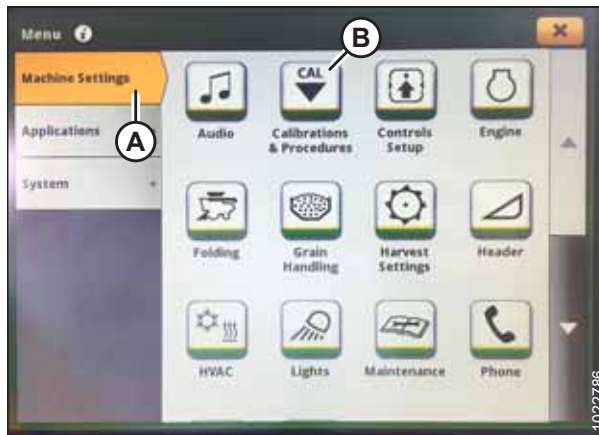
Ábra 3.795: John Deere S700 kijelző – Gépbeállítások
