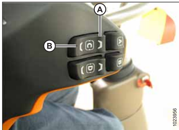
Ábra 3.336: John Deere 700 ferdefelhordó előre-hátra döntő kezelőszervek
