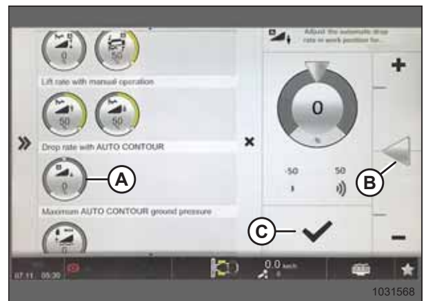
Ábra 3.604: Ereszkedési sebesség automatikus talajkövetéssel oldal
