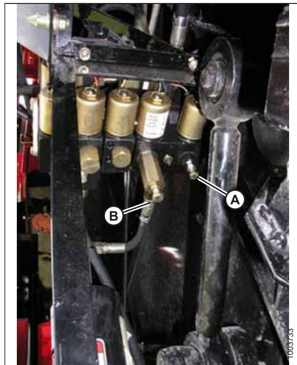
Ábra 3.623: Vágóasztal emelő és leengedő állítható szűkítő elemek
