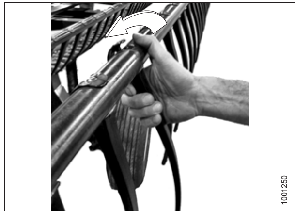
Ábra 4.275: Műanyag bedobóujj eltávolítása
