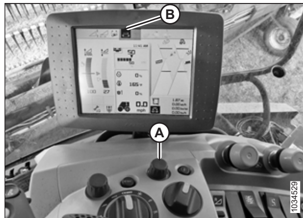
Ábra 3.67: Hevedersebesség ikonja régebbi CLAAS gépeken
