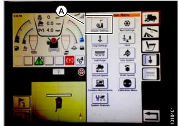
Ábra 3.631: Vágóasztal-beállítások a betakarítógép főmenüjében
