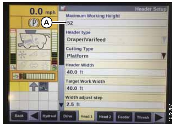
Ábra 3.480: Case betakarítógép kijelző – Vágóasztal-beállítási oldal
