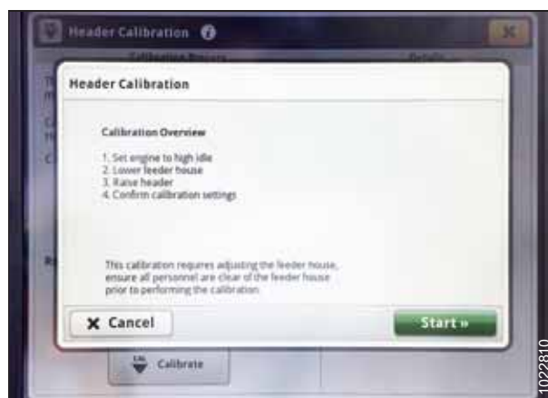
Ábra 3.799: John Deere S700 kijelző – Vágóasztal kalibrálása
