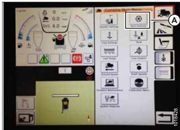
Ábra 3.640: Motollabeállítások a betakarítógép főmenüjében
