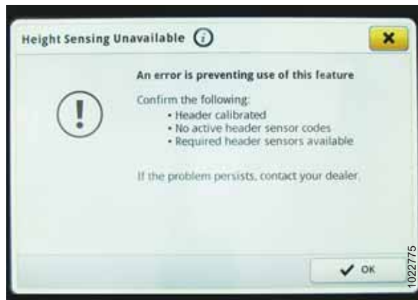
Ábra 3.778: John Deere S700 kijelző – Magasság-érzékelési hibaüzenet
