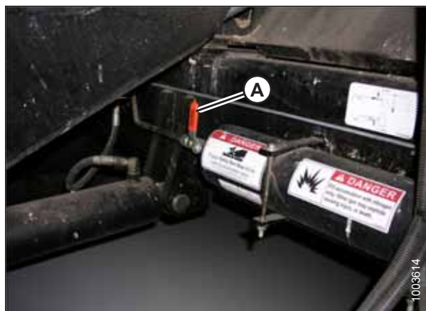
Ábra 3.622: Betakarítógép akkumulátora BE/KI kapcsoló
