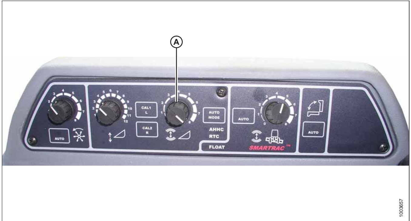
Ábra 3.626: Automatikus vágóasztalmagasság-szabályozó konzol
