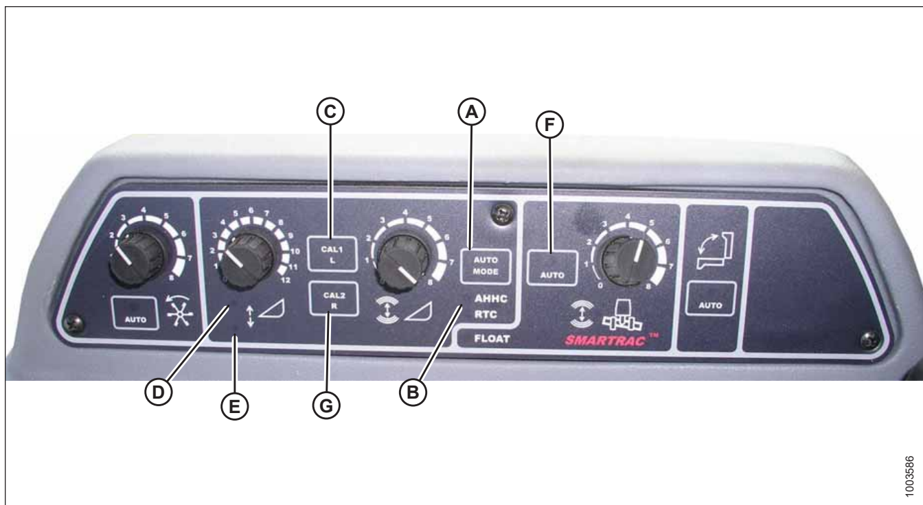
Ábra 3.621: A betakarítógép automatikus vágóasztal-magasság szabályozó kezelőszervei
