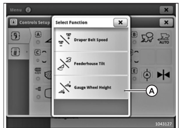
Figur 3.313: John Deere X9-display – Opsætning af betjeningslementer
