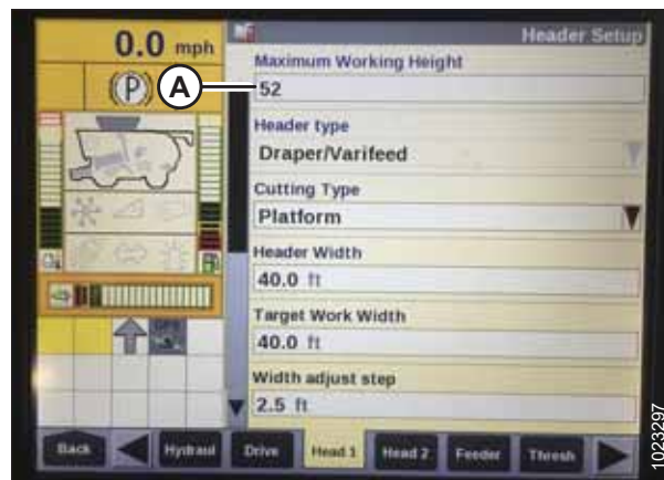
Attēls 3.293: Case kombaina displejs — hedera iestatīšanas lapa
