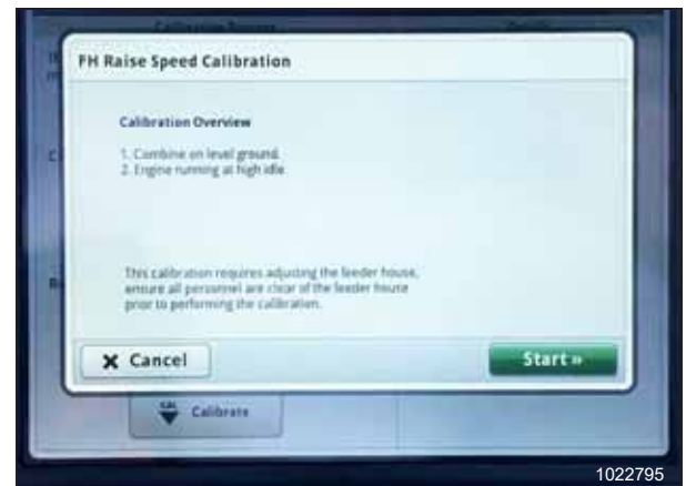
Attēls 3.789: John Deere S700 displejs — padeves tvertnes kalibrācija
