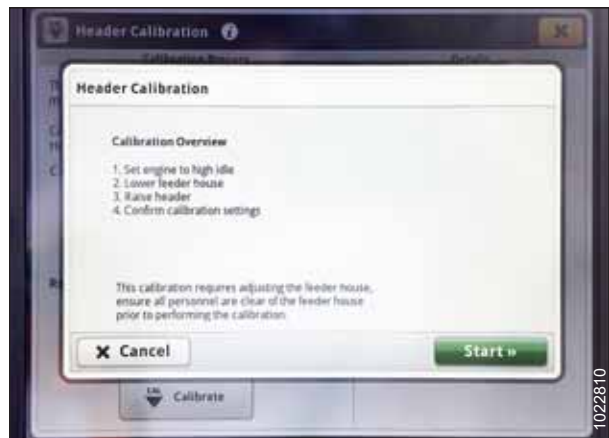
Attēls 3.799: John Deere S700 displejs — hedera kalibrācija
