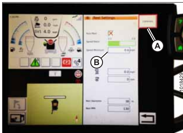
Attēls 3.641: Tītavu iestatījumu kalibrēšana
