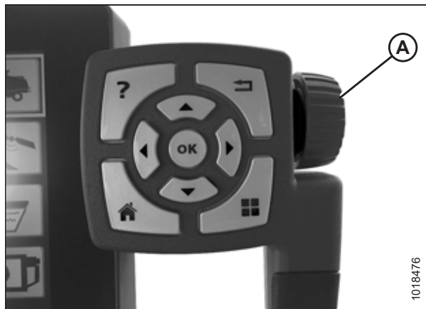
Attēls 3.664: Regulēšanas ripa Tyton termināļa labajā pusē
