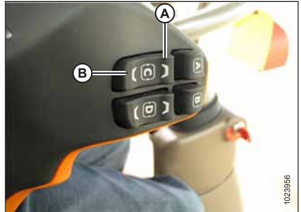
Attēls 3.336: John Deere 700 padeves tvertnes atgāzuma un slīpuma sistēmas vadība
