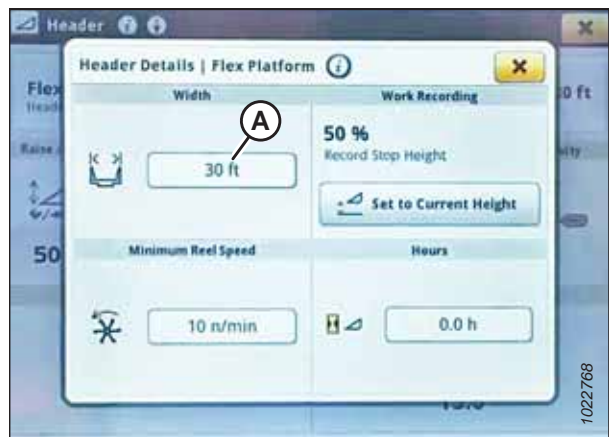
Attēls 3.712: John Deere S7 displejs — logs informācijai par hedera
