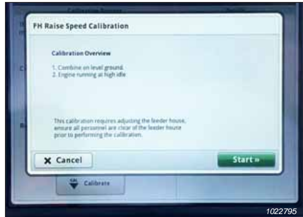
Attēls 3.730: John Deere S7 displejs — padeves tvertnes kalibrēšana
