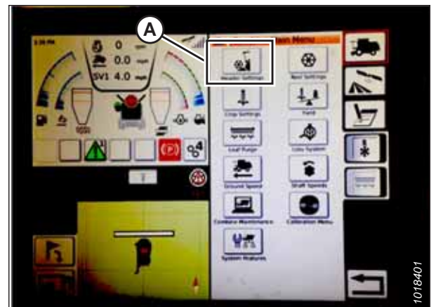
Attēls 3.586: Hedera iestatījumi kombaina galvenajā izvēlnē
