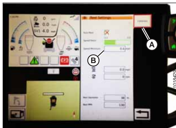
Attēls 3.629: Tītavu iestatījumu kalibrēšana
