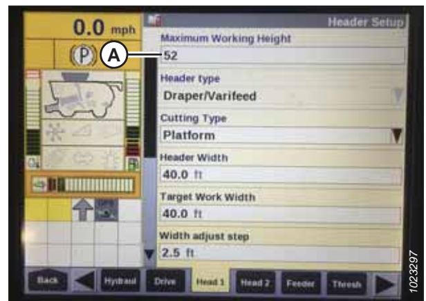
Attēls 3.453: Case kombaina displejs — hedera iestatīšanas lapa
