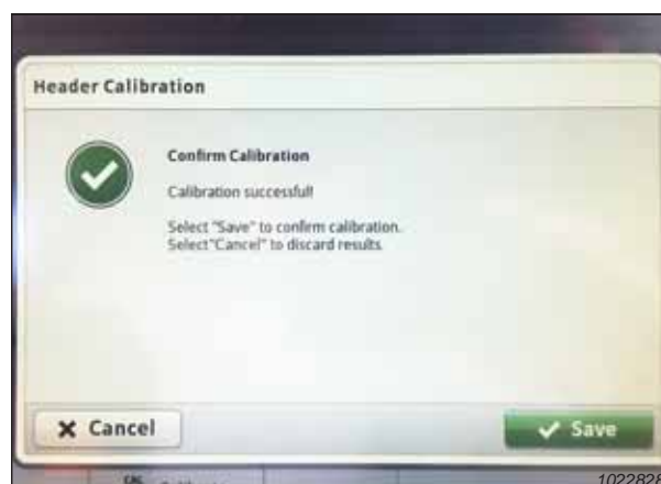
Attēls 3.739: John Deere S7 displejs — hedera kalibrēšana
