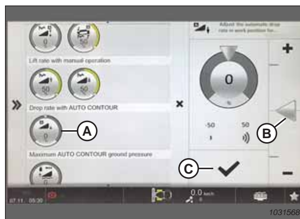
Attēls 3.562: Vērtības samazināšana automātiskā zemes reljefa lapā
