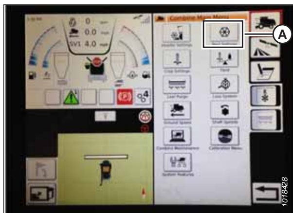
Attēls 3.594: Tītavu iestatījumi kombaina galvenajā izvēlnē
