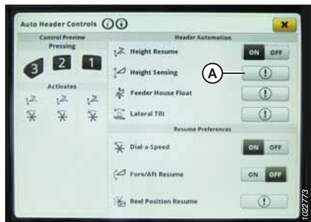
Attēls 3.718: John Deere S7 displejs — automātiskās hedera vadības ierīces
