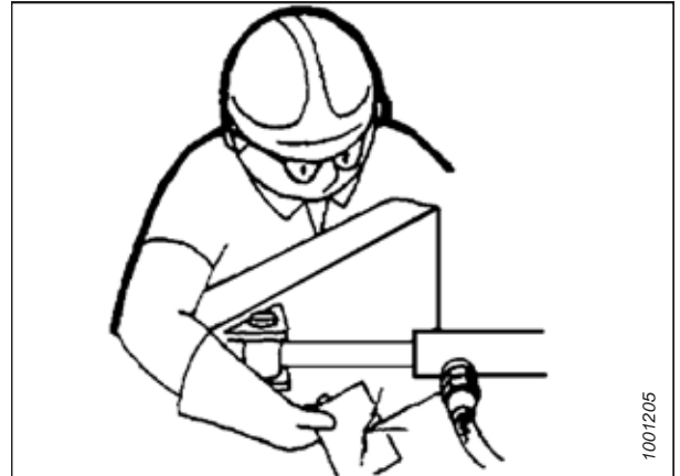
Attēls 1.11: Hidrauliskās sistēmas noplūdes pārbaude
