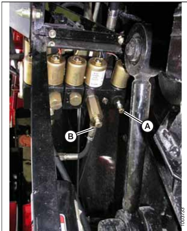
Attēls 3.578: Regulējamie hedera pacelšanas un nolaišanas ierobežotāji
