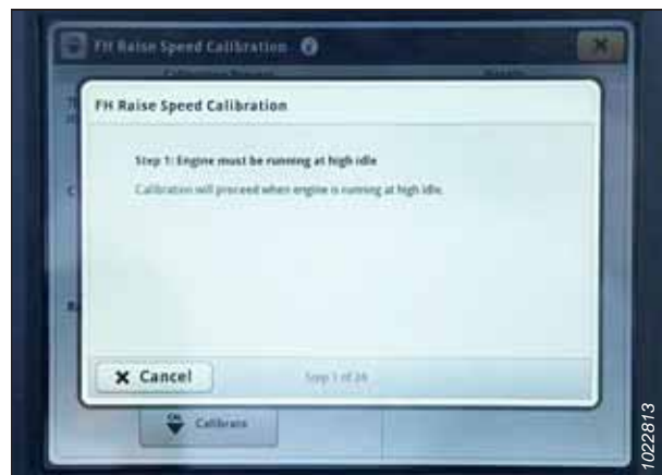
Attēls 3.731: John Deere S7 displejs — padeves tvertnes kalibrēšana
