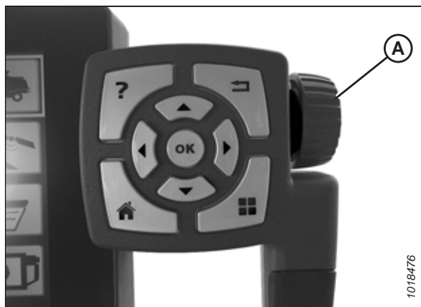
Attēls 3.646: Regulēšanas ripa labajā Tyton termināļa pusē
