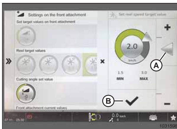
Attēls 3.565: Tītavu ātruma paredzēto vērtību lapā
