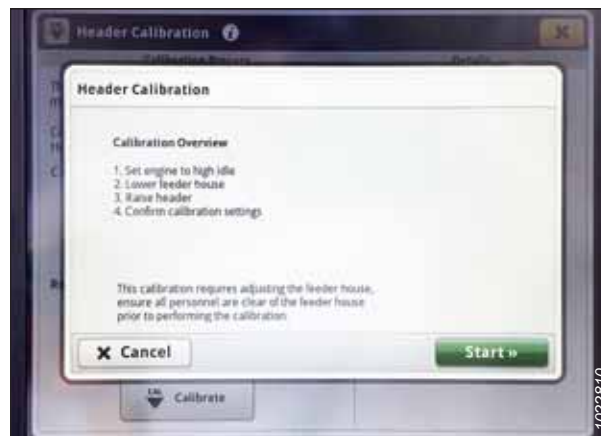
Attēls 3.738: John Deere S7 displejs — hedera kalibrēšana
