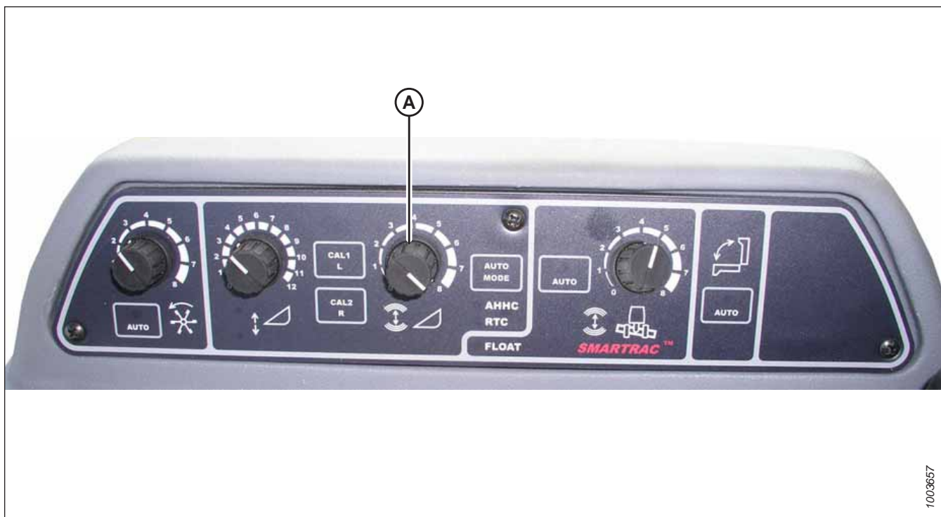
Attēls 3.581: Automātiskās hedera augstuma vadības konsole
