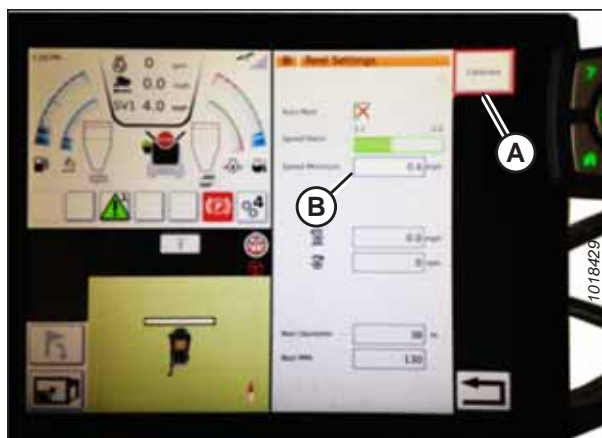
Attēls 3.595: Tītavu iestatījumu kalibrēšana
