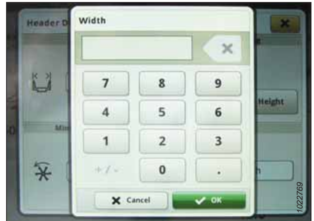
Attēls 3.713: John Deere S7 displejs — hedera platuma iestatīšana
