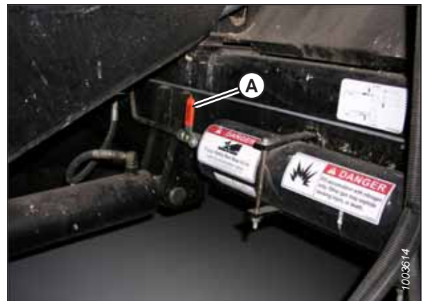
Attēls 3.577: Kombaina akumulatora IESL. / IZSL. slēdzis
