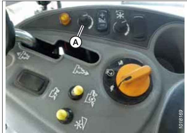
Attēls 3.499: Augstuma regulēšanas grozāmpoga kombaina vadības konsolē
