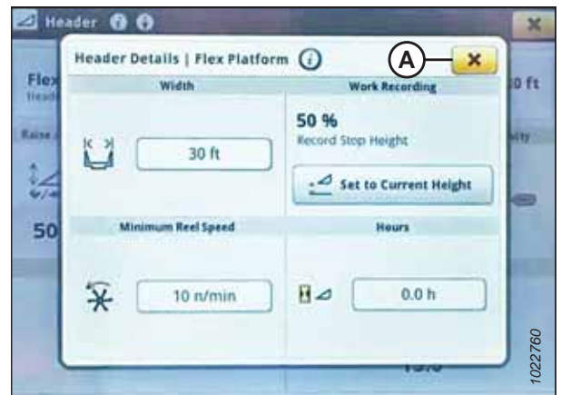
Attēls 3.714: John Deere S7 displejs — dialoglodziņš Header Details (Hedera dati)
