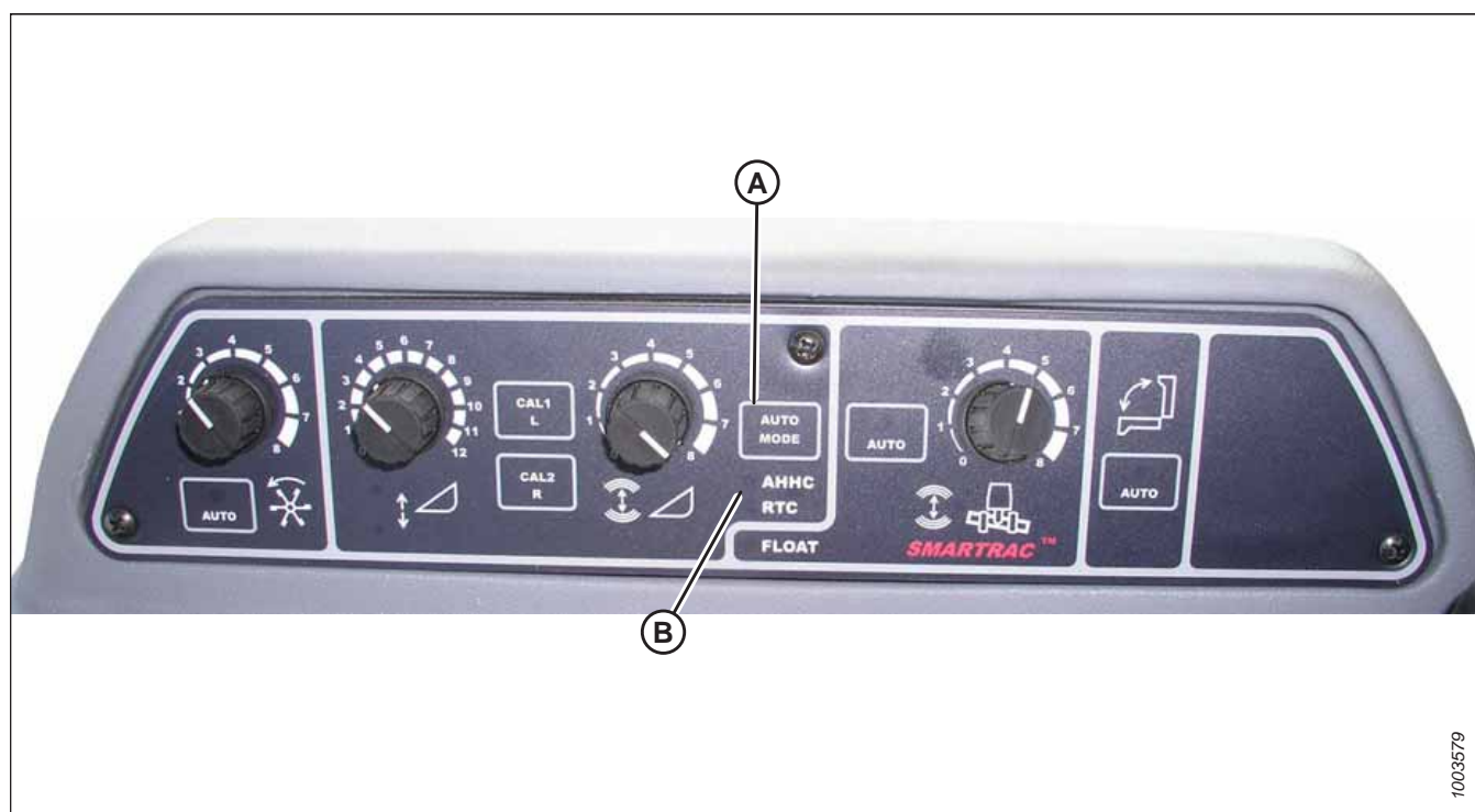
Attēls 3.574: Kombaina automātiskās hedera augstuma vadības ierīces
