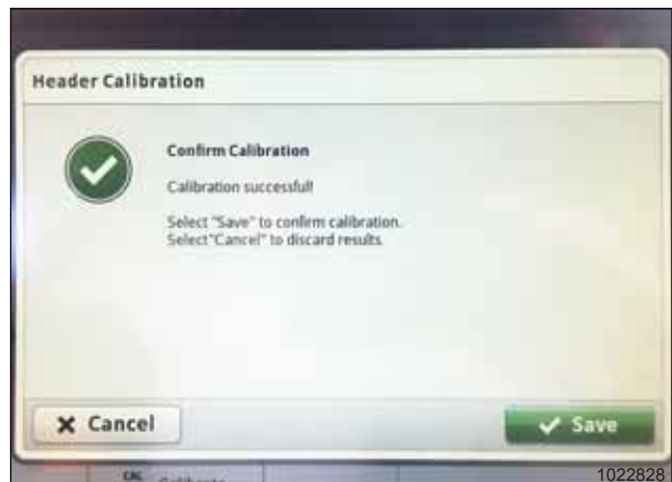
Attēls 3.495: John Deere S7 displejs — hedera kalibrēšana
