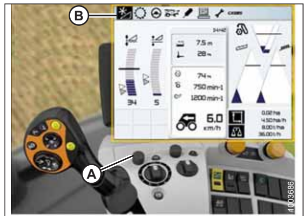
Attēls 3.327: CLAAS kombaina displejs, konsole un vadības rokturis
