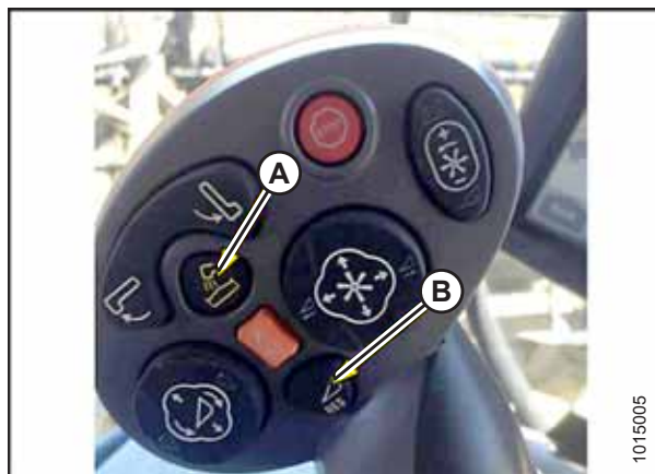
Attēls 3.521: New Holland kombaina vadības ierīces
