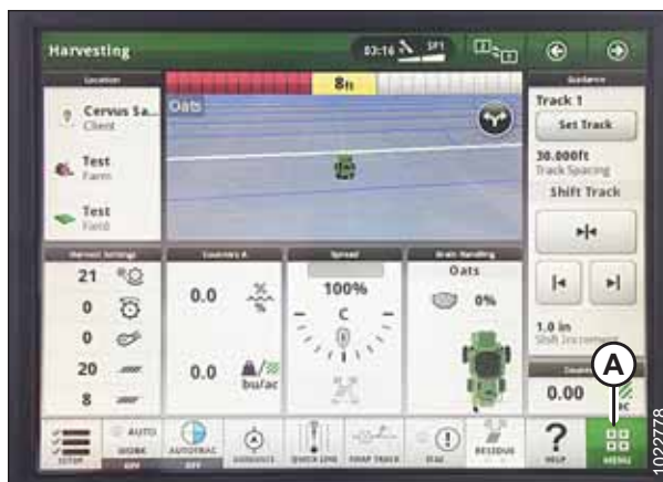
Attēls 3.482: John Deere S7 displejs — ražas novākšanas lapa
