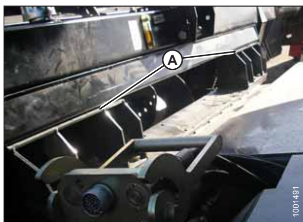
Attēls 4.62: Padeves tvertne un reljefa kopēšanas modulis
