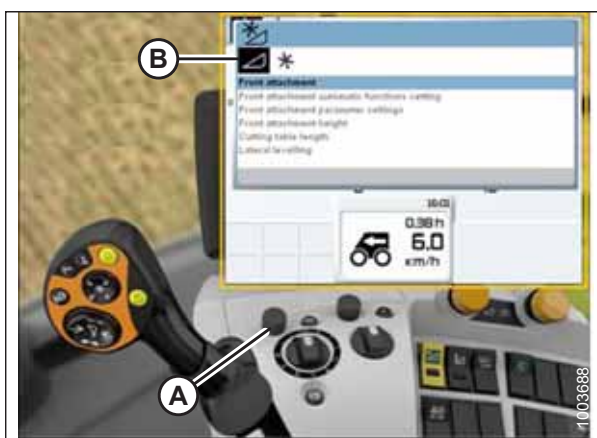
Attēls 3.314: CLAAS kombaina displejs, konsole un vadības rokturis
