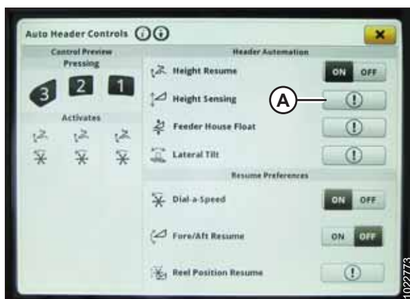
Attēls 3.474: John Deere S7 displejs — automātiskās hedera vadības ierīces
