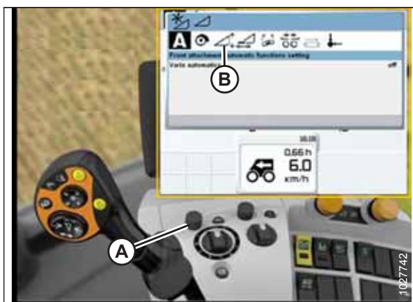
Attēls 3.315: CLAAS kombaina displejs, konsole un vadības rokturis
