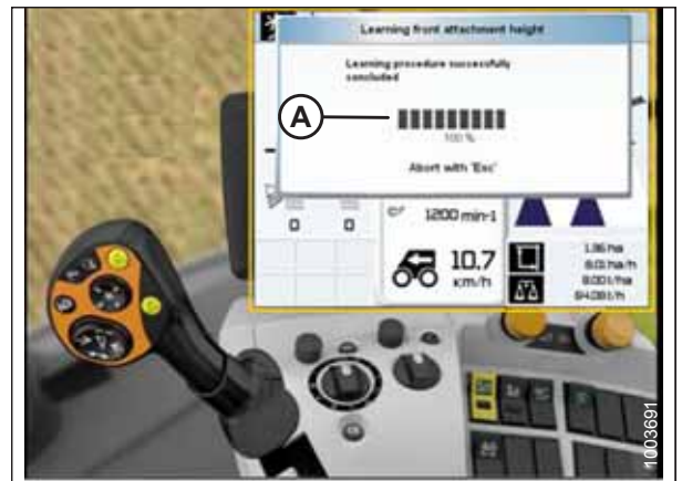
Attēls 3.332: CLAAS kombaina displejs, konsole un vadības rokturis
