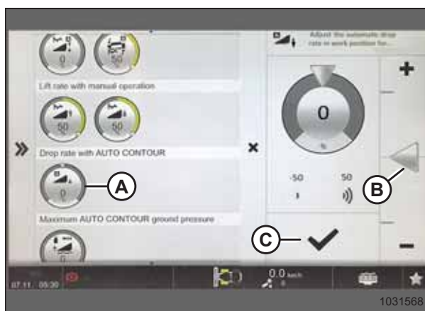
Attēls 3.349: Vērtības samazināšana automātiskā zemes reljefa lapā
