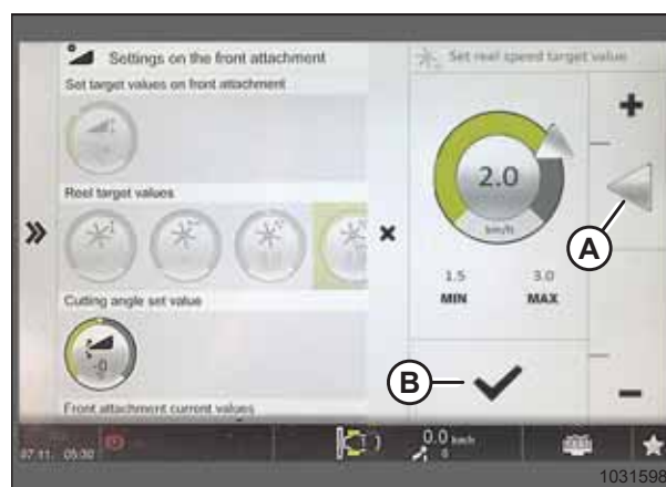
Attēls 3.352: Tītavu ātruma paredzēto vērtību lapa
