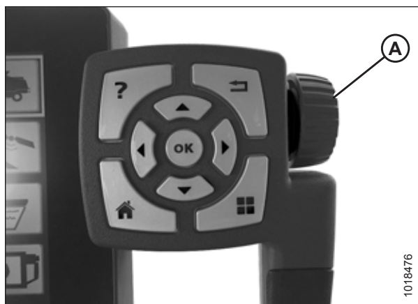
Attēls 3.402: Regulēšanas ripa Tyton termināļa labajā pusē
