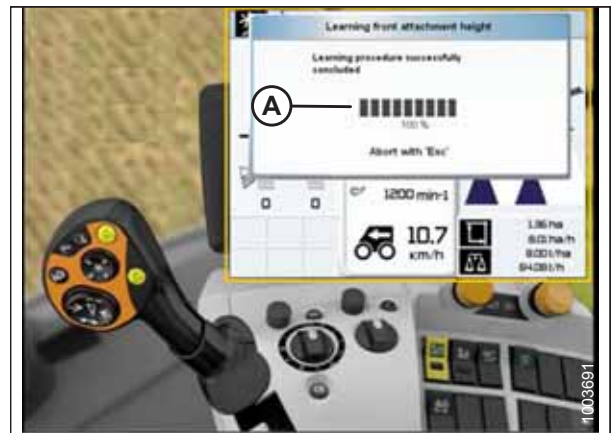
Attēls 3.318: CLAAS kombaina displejs, konsole un vadības rokturis
