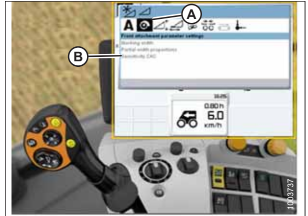
Attēls 3.321: CLAAS kombaina displejs, konsole un vadības rokturis
