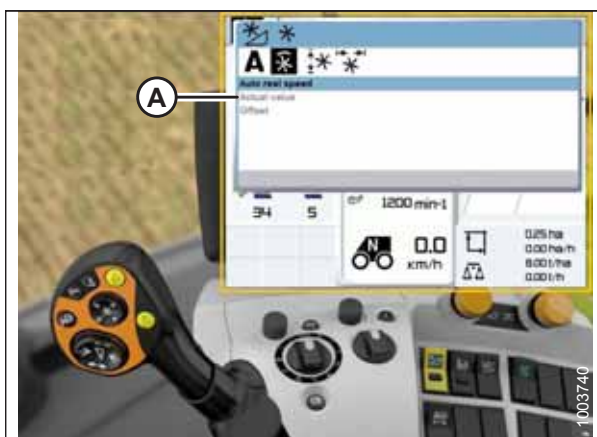
Attēls 3.325: CLAAS kombaina displejs, konsole un vadības rokturis
