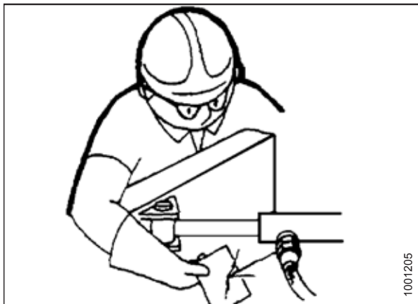
Attēls 1.11: Hidrauliskās sistēmas noplūdes pārbaude
