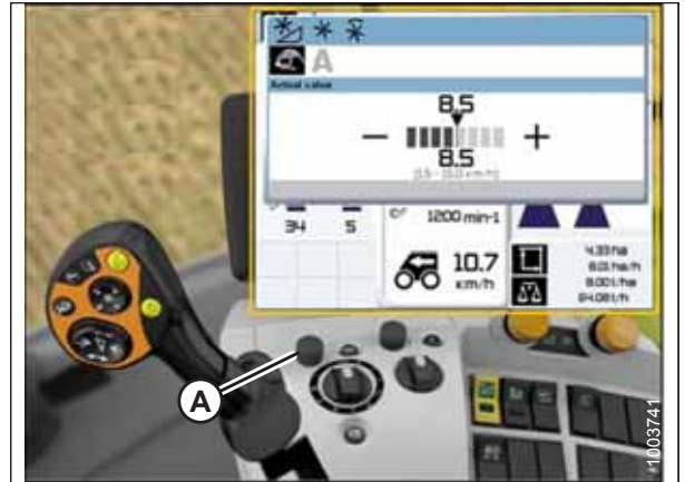
Attēls 3.326: CLAAS kombaina displejs, konsole un vadības rokturis
