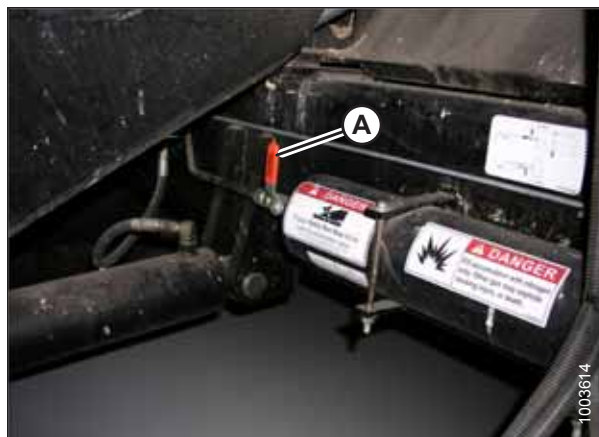
Attēls 3.363: Kombaina akumulatora IESL. / IZSL. slēdzis
