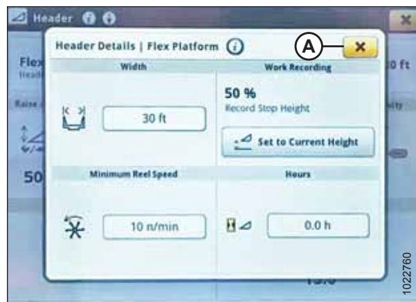
Attēls 3.470: John Deere S7 displejs — logs informācijai par hedera
