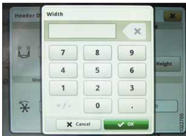
Attēls 3.469: John Deere S7 displejs — hedera platumu iestatīšana
