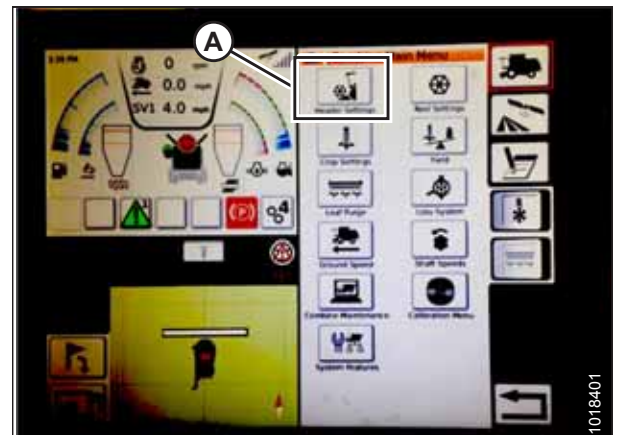
Attēls 3.372: Hedera iestatījumi kombaina galvenajā izvēlnē
