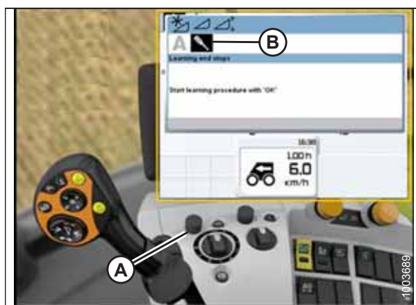
Attēls 3.330: CLAAS kombaina displejs, konsole un vadības rokturis
