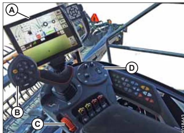
Attēls 3.397: Gleaner S9 operatora vadības ierīces
