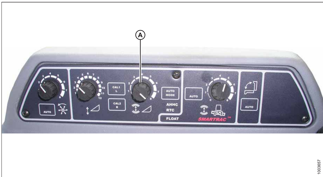
Attēls 3.367: Automātiskās hedera augstuma vadības konsole
