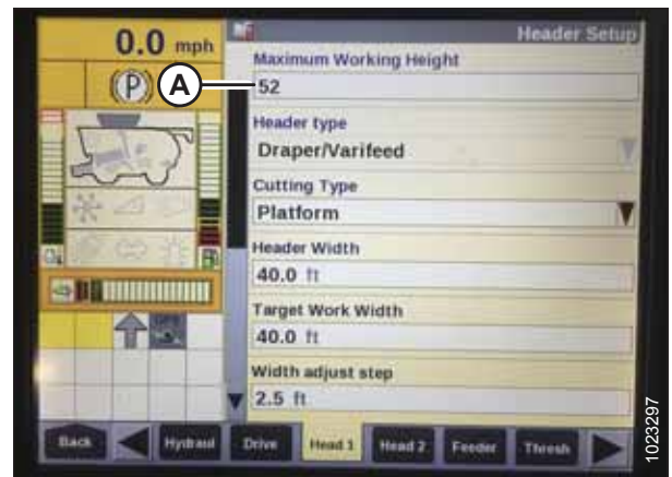
Attēls 3.243: Case kombaina displejs — hedera iestatīšanas lapa
