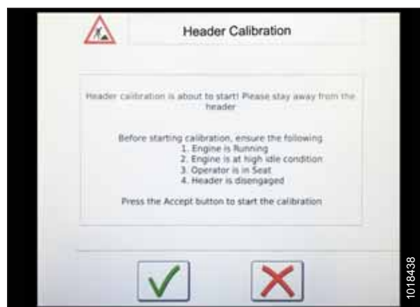
Attēls 3.213: Hedera kalibrēšanas brīdinājums
