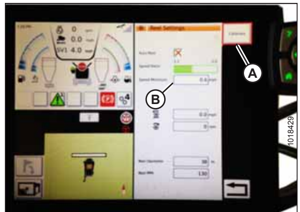
Attēls 3.381: Tītavu iestatījumu kalibrēšana
