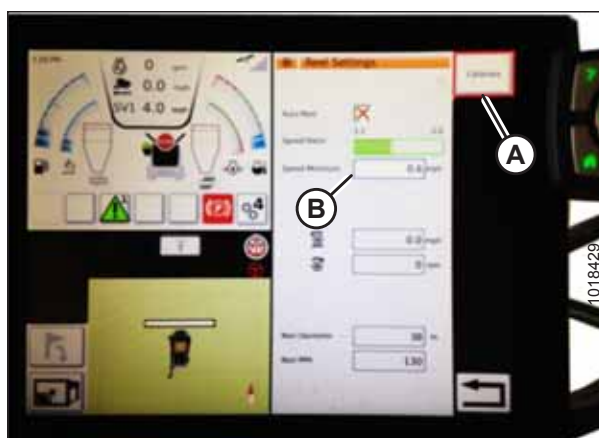
Attēls 3.205: Tītavu iestatījumu kalibrēšana
