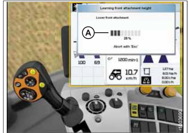
Attēls 3.331: CLAAS kombaina displejs, konsole un vadības rokturis
