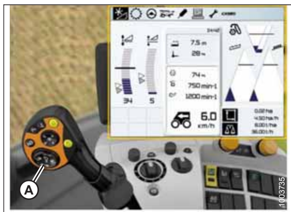
Attēls 3.319: CLAAS kombaina displejs, konsole un vadības rokturis
