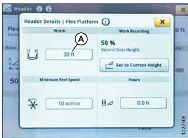
Attēls 3.468: John Deere S7 displejs — logs informācijai par hederu
