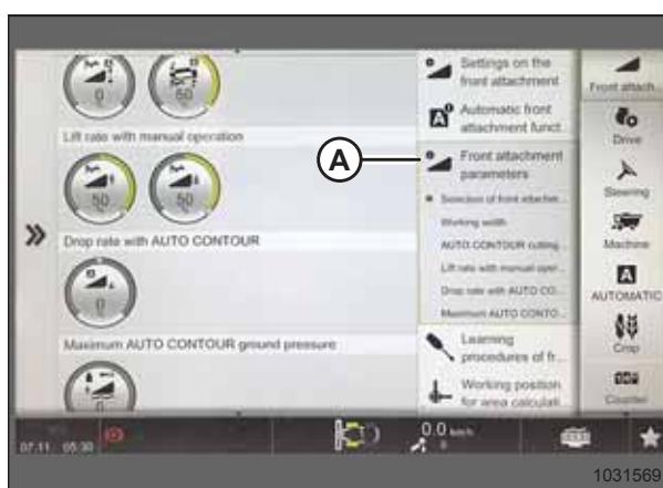
Attēls 3.348: Priekšējās pierīces parametru lapa
