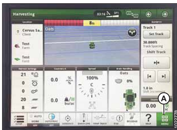
Attēls 3.478: John Deere S7 displejs — ražas novākšanas lapa
