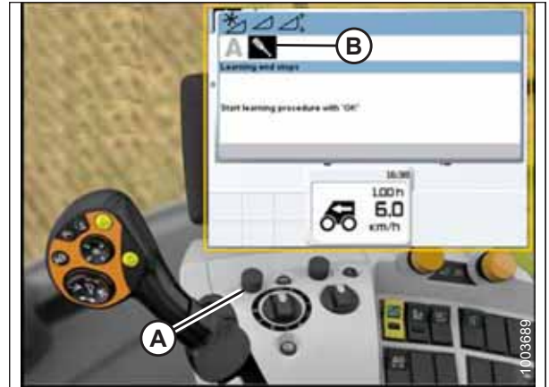
Attēls 3.316: CLAAS kombaina displejs, konsole un vadības rokturis
