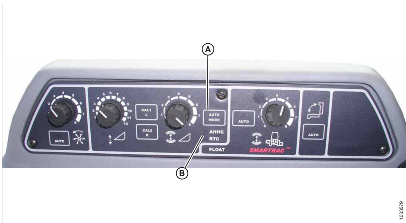
Attēls 3.360: Kombaina automātiskās hedera augstuma vadības ierīces
