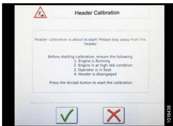
Attēls 3.393: Hedera kalibrēšanas brīdinājums
