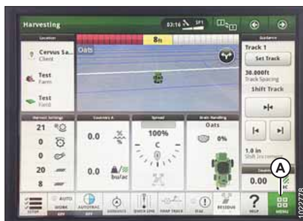
Attēls 3.489: John Deere S7 displejs — ražas novākšanas lapa
