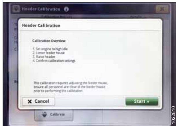
Attēls 3.494: John Deere S7 displejs — hedera kalibrēšana
