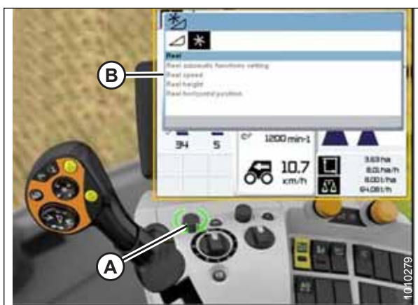
Attēls 3.324: CLAAS kombaina displejs, konsole un vadības rokturis
