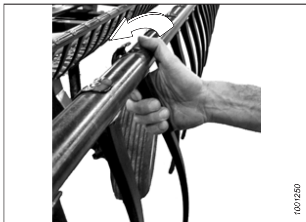
pav. 4.295: Plastikinio piršto atjungimas
