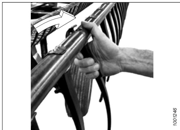
pav. 4.296: Plastikinio piršto montavimas
