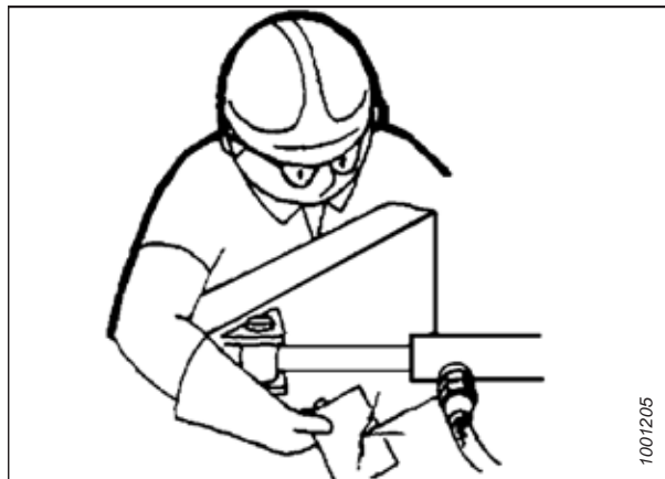
pav. 1.11: Hidraulinių nuotėkių tikrinimas
