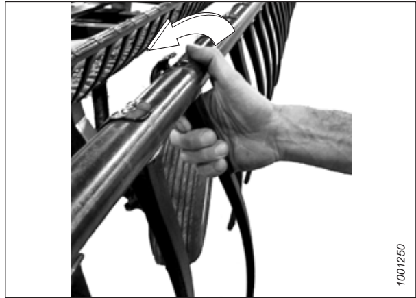
pav. 4.293: Plastikinio piršto atjungimas
