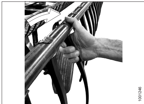
pav. 4.284: Plastikinio piršto montavimas
