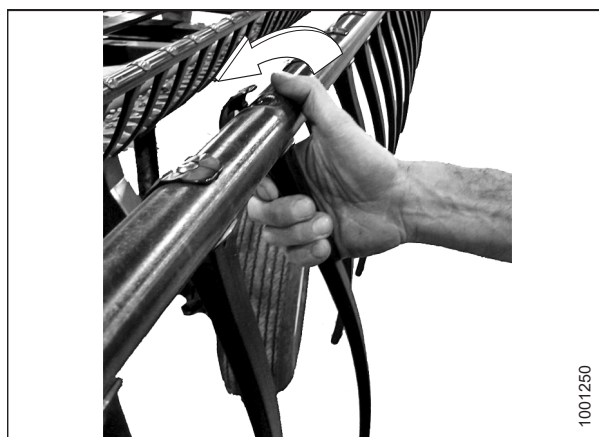
pav. 4.283: Plastikinio piršto atjungimas
