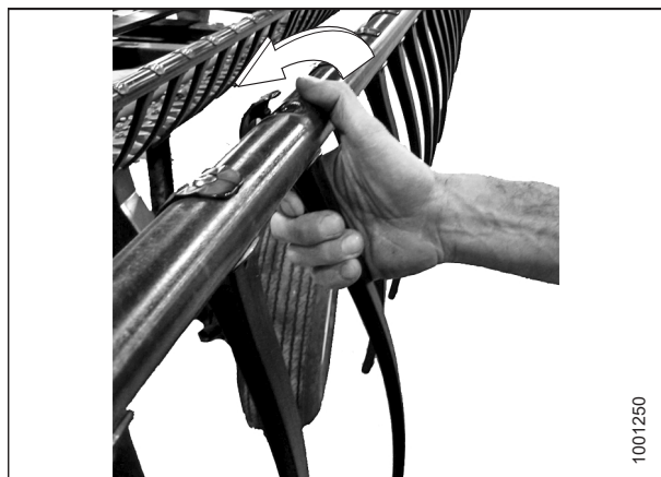
pav. 4.275: Plastikinio piršto atjungimas
