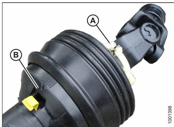
pav. 4.57: transmisijos apsauga
