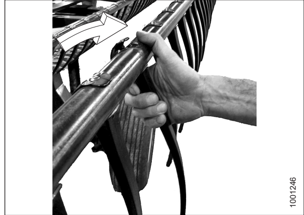
pav. 4.276: Plastikinio piršto montavimas
