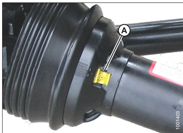
pav. 4.60: transmisijos apsauga
