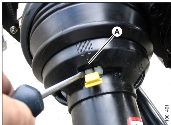
pav. 4.59: transmisijos apsauga
